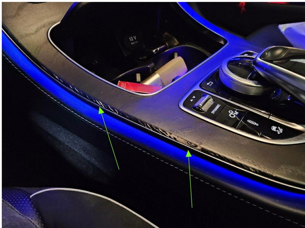
Bild 9 : Mittelkonsole - Blende zerkratzt
