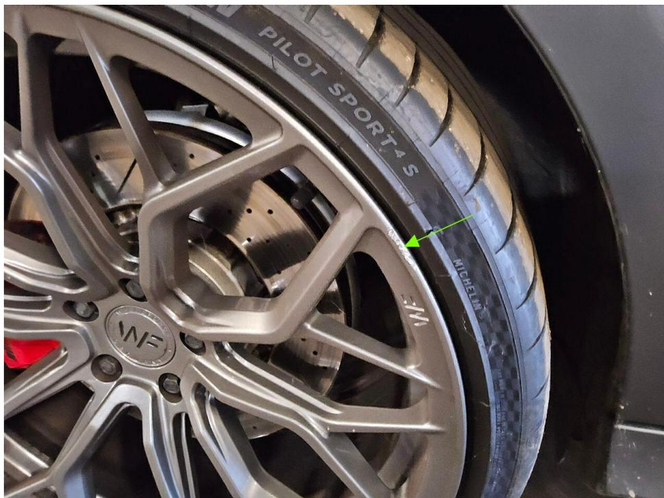
Bild 10 : Felge hinten rechts zerkratzt
