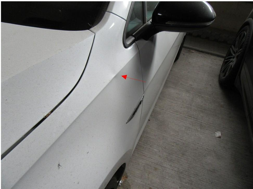
Bild 8 : Kotflügel eingedrückt
