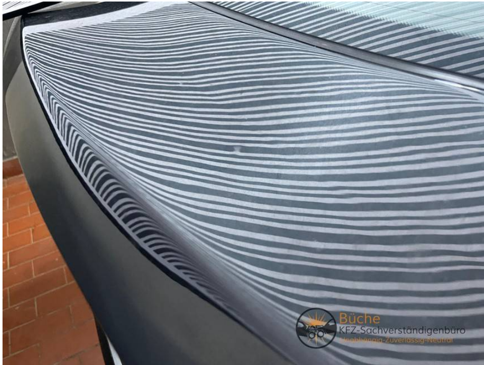
Hagelschaden auf Heckdeckel
