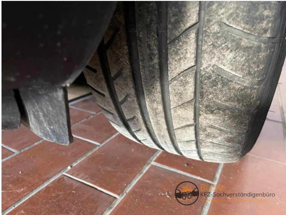
Reifen vorne links ungleichmäßig abgenutzt
