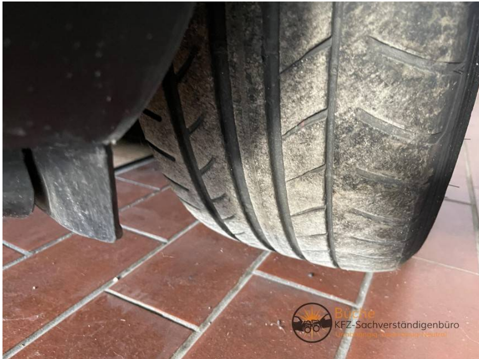
Reifen vorne links ungleichmäßig abgenutzt
