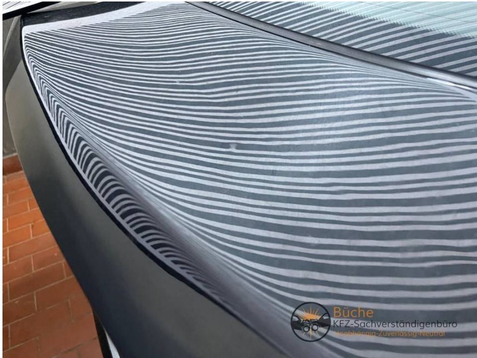
Hagelschaden auf Heckdeckel
