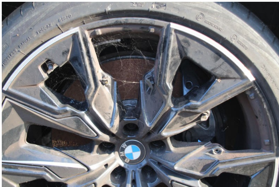
Bild 13 Speichenabdeckungen vorn links gebrochen.
