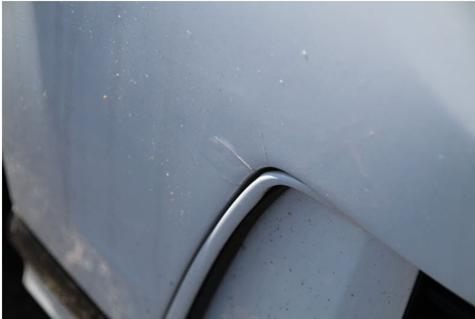
Bild 13 Stoßfänger vorn instandgesetzt und gebrochen.
