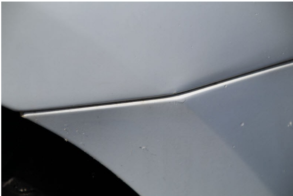
Bild 14 Kotflügel vorn rechts instandgesetzt mit Restspuren, Lackschichtdicke bis 1.100 µm.
