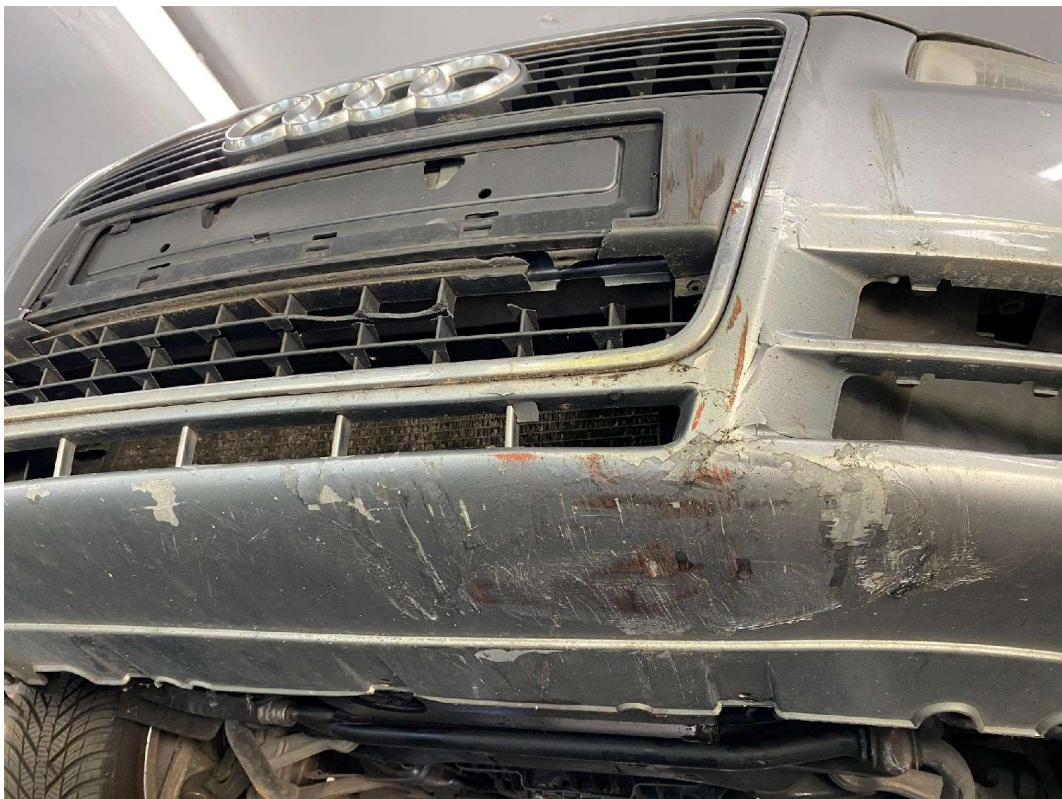
14 Stoßfänger und Kühlergrill beschädigt
