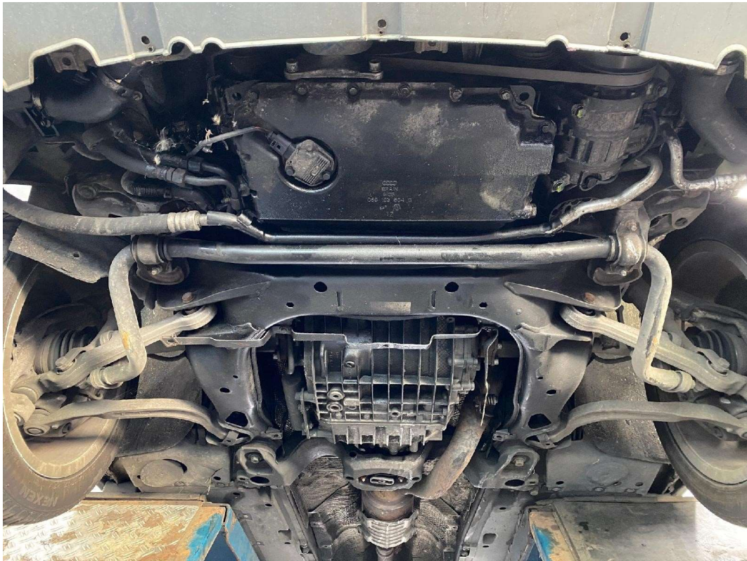
Bild: 15 Ansicht Unterboden vorne - Aggregat mit Ölverlust
