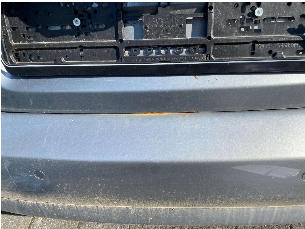
22 Heckklappe mit Korrosionsansatz
