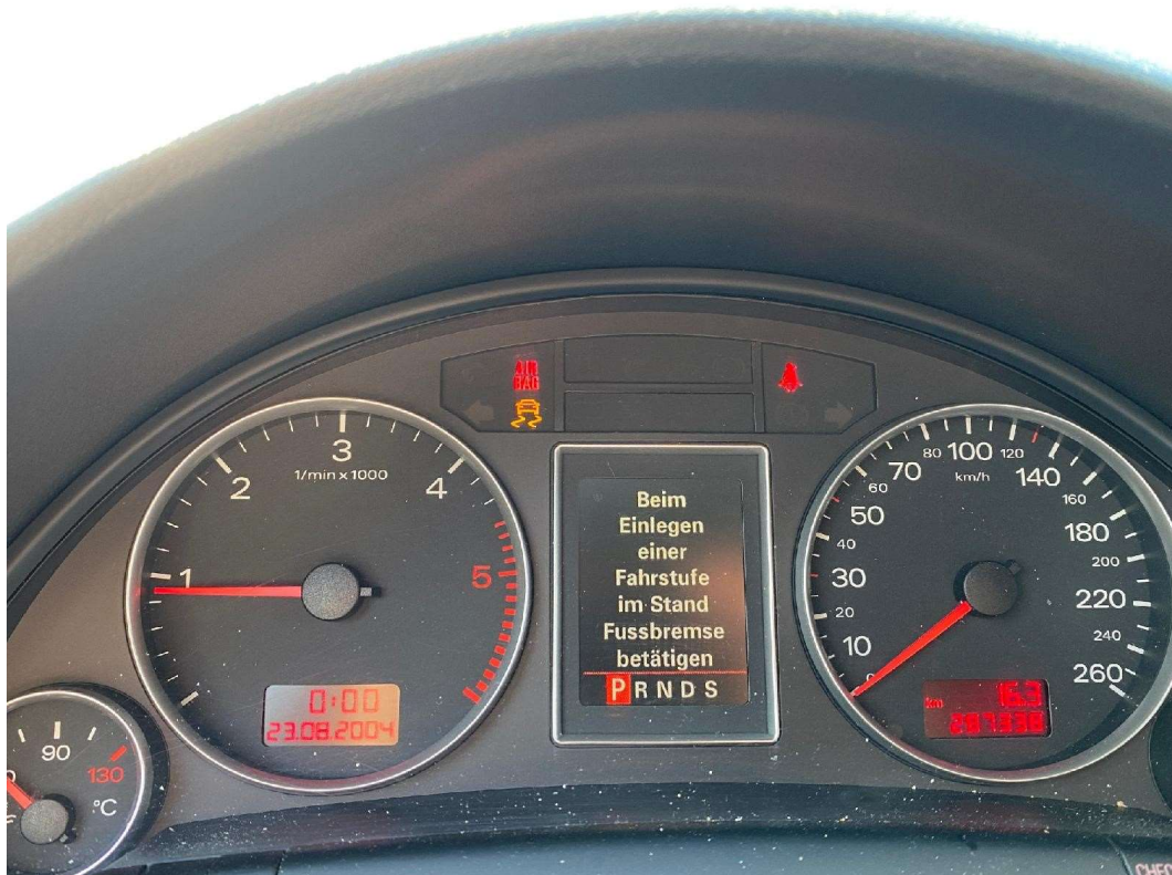
Bild: 27 Instrumente mit Laufleistung Kontrollleuchten Airbag/ESP signalisieren Fehlfunktion
