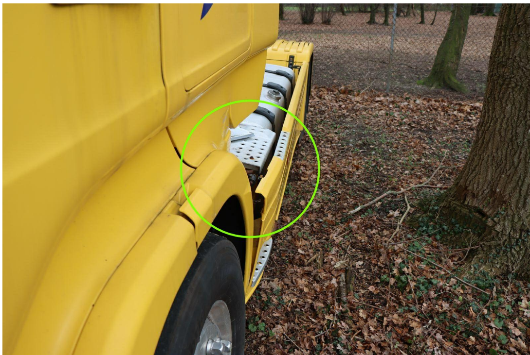
Bild 24 : seitliche Schutzvorrichtung klappbar Befestigung / Verschuß vorne links defekt
