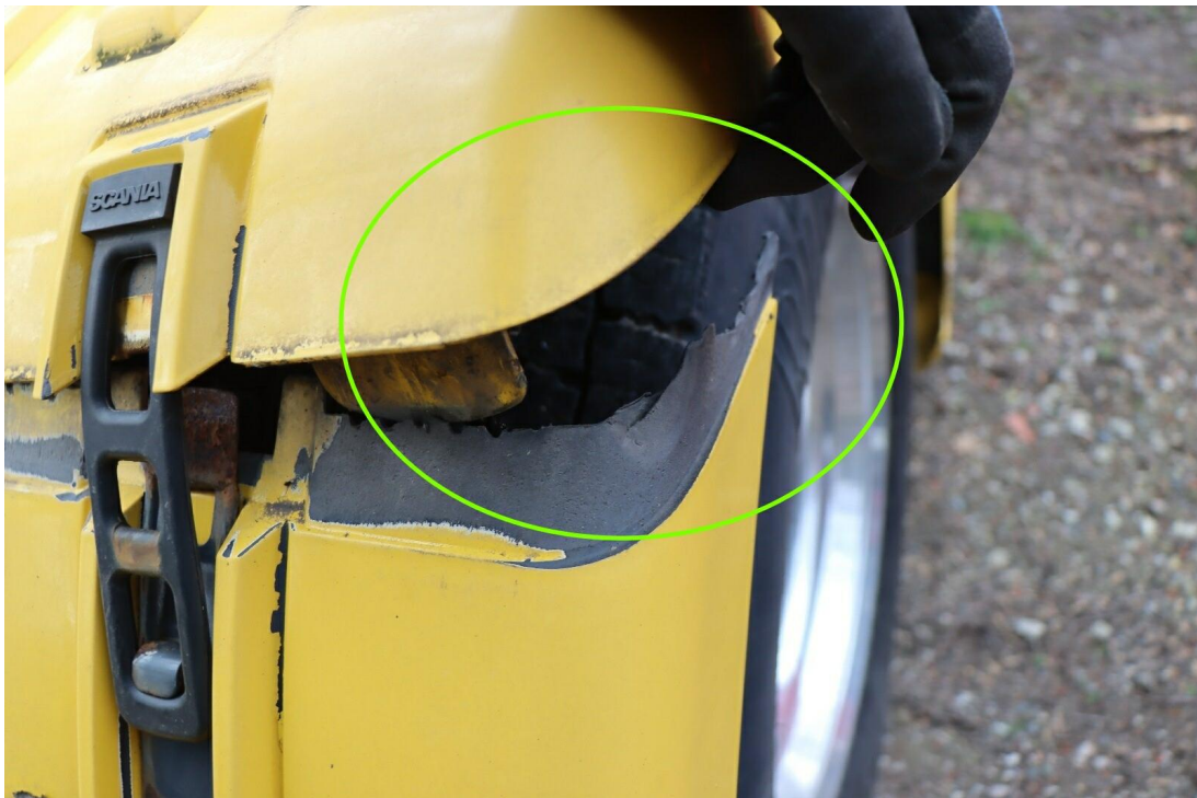
Bild 39 : Radabdeckung 2. Achse rechts eingerissen
