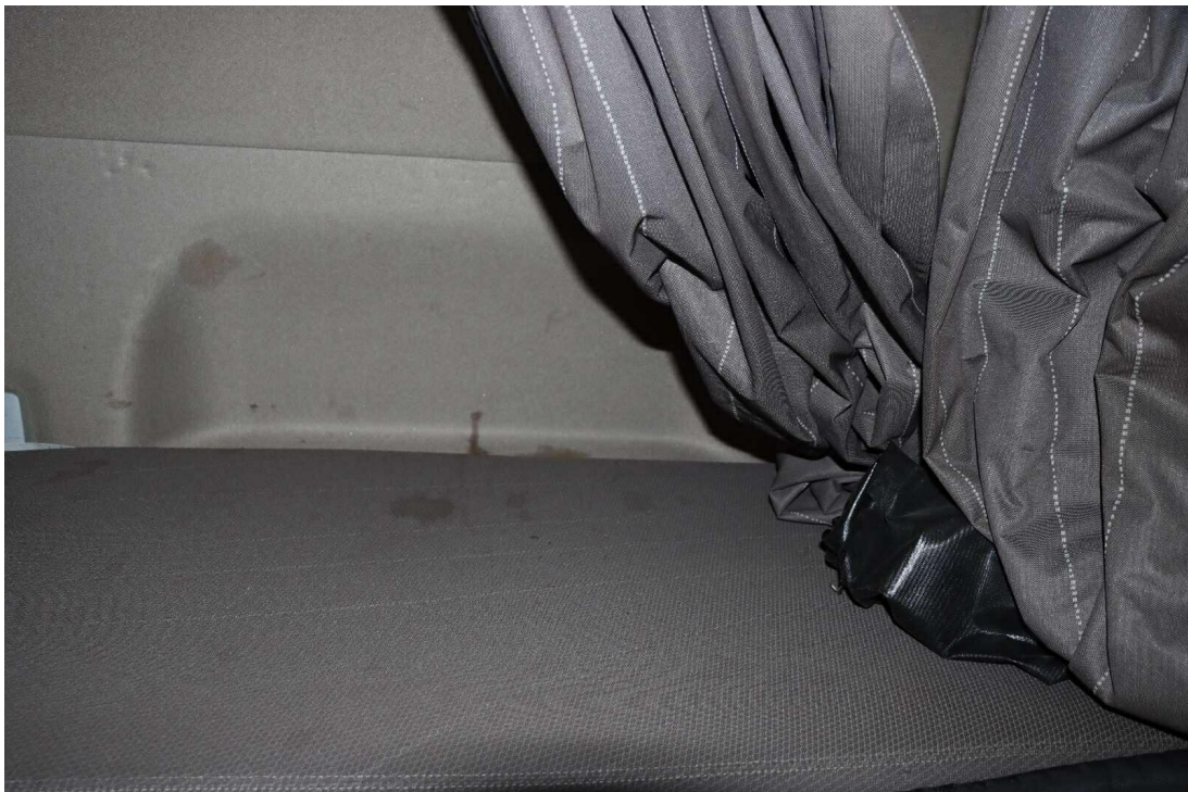
Bild 14 : Schlafliege oben Matratze fleckig Fahrerhaus Rückwandverkleidung fleckig
