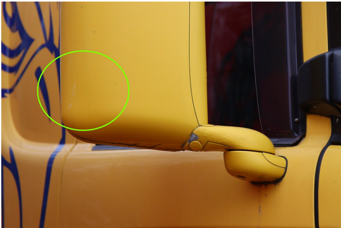
Bild 22 : Spiegelgehäuse rechts leicht verschrammt
