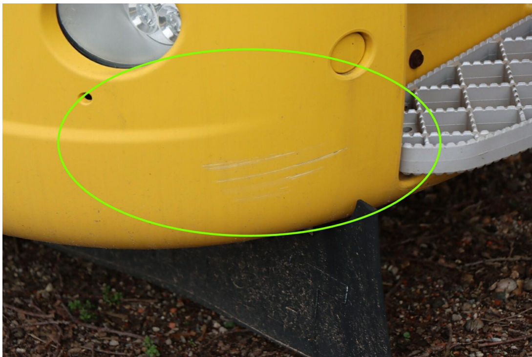
Bild 18 : Stoßfängerverkleidung Eckumführung links verschrammt
