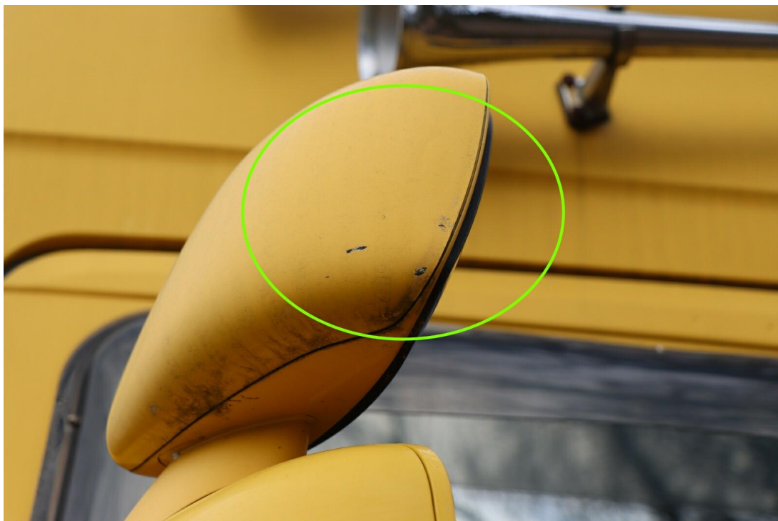
Bild 23 : Spiegelgehäuse Weitwinkelspiegel links verschrammt
