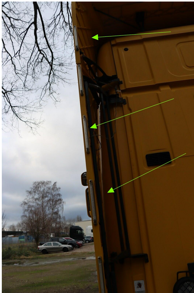
Bild 27 : Zusatzbeleuchtung / unzulässige Beleuchtung entfernen links
