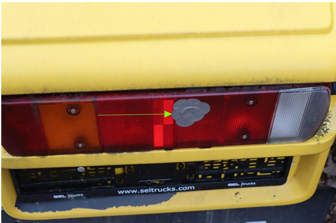
Bild 31 : Schlussleuchte links Abschlussscheibe beschädigt
