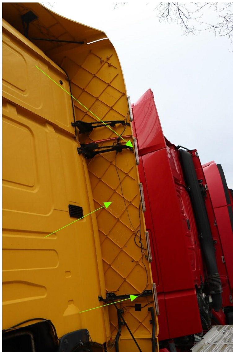
Bild 26 : Zusatzbeleuchtung / unzulässige Beleuchtung entfernen rechts
