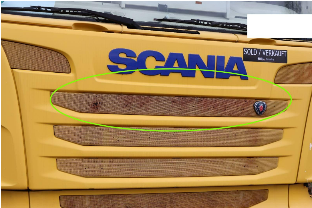
Bild 21 : Gitter Kühlergrill bräunlich verfärbt
