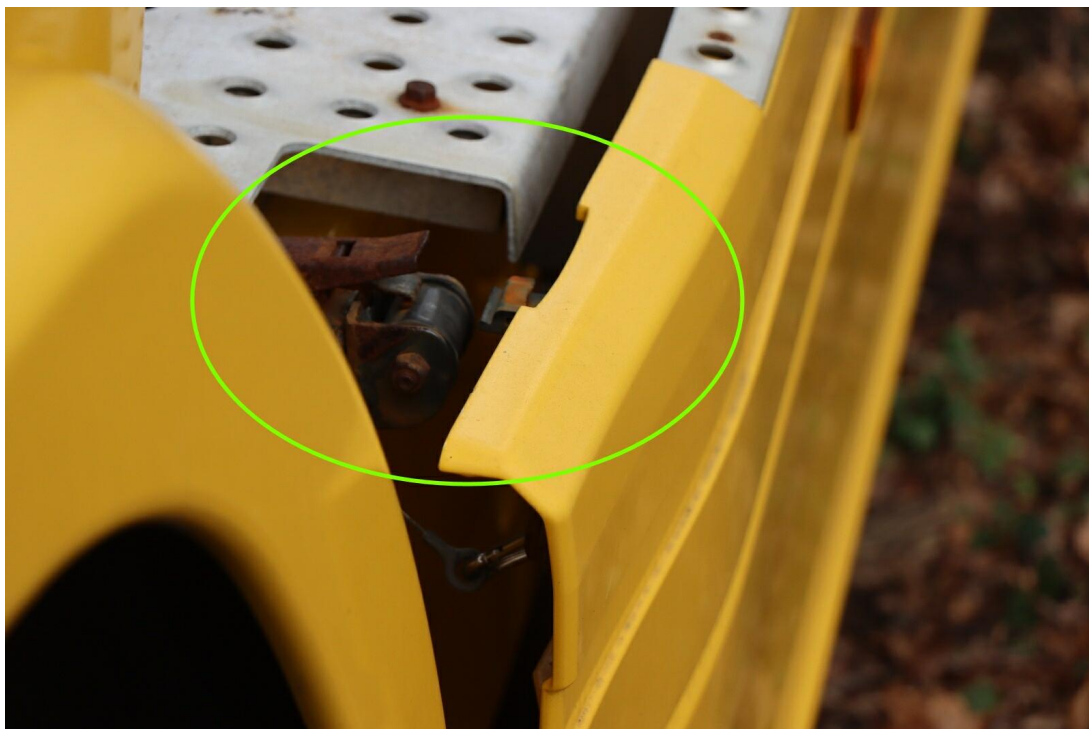
Bild 25 : seitliche Schutzvorrichtung klappbar Befestigung / Verschuß vorne links defekt
