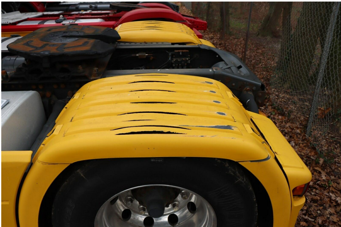
Bild 29 : 2. Achse links Radabdeckung eingerissen
