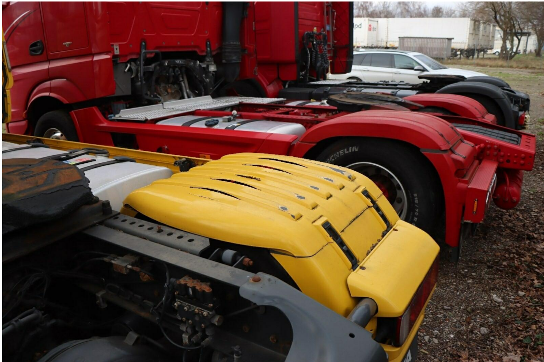
Bild 30 : 2. Achse rechts Radabdeckung eingerissen
