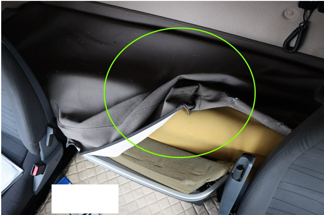
Bild 13 : Schlafliege unten Matratze Bezug beschädigt
