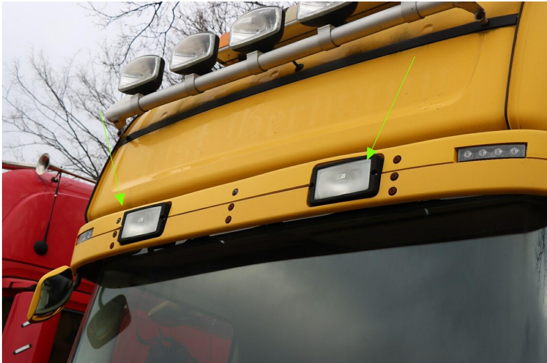
Bild 19 : Fernschweifer oben links und rechts Abschlusscheibe matt
