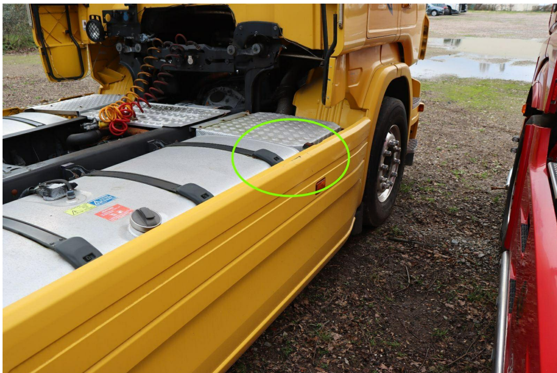
Bild 32 : seitliche Schutzvorrichtung rechts verschrammt
