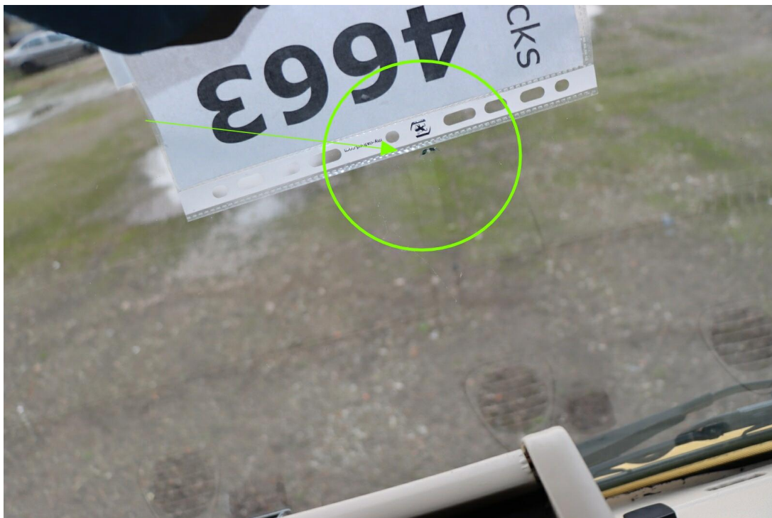
Bild 15 : Frontscheibe Steinschlag außerhalb Fernsichtbereich
