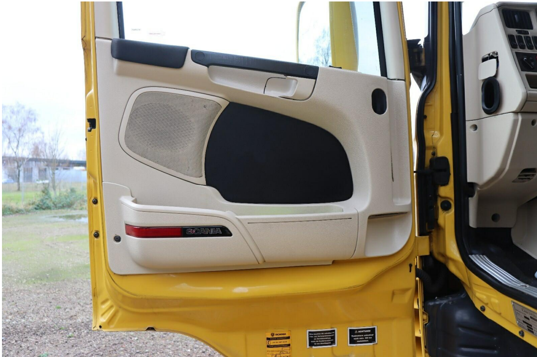
Bild 7 : Türverkleidung links Gitter Lautsprecherbox eingerissen
