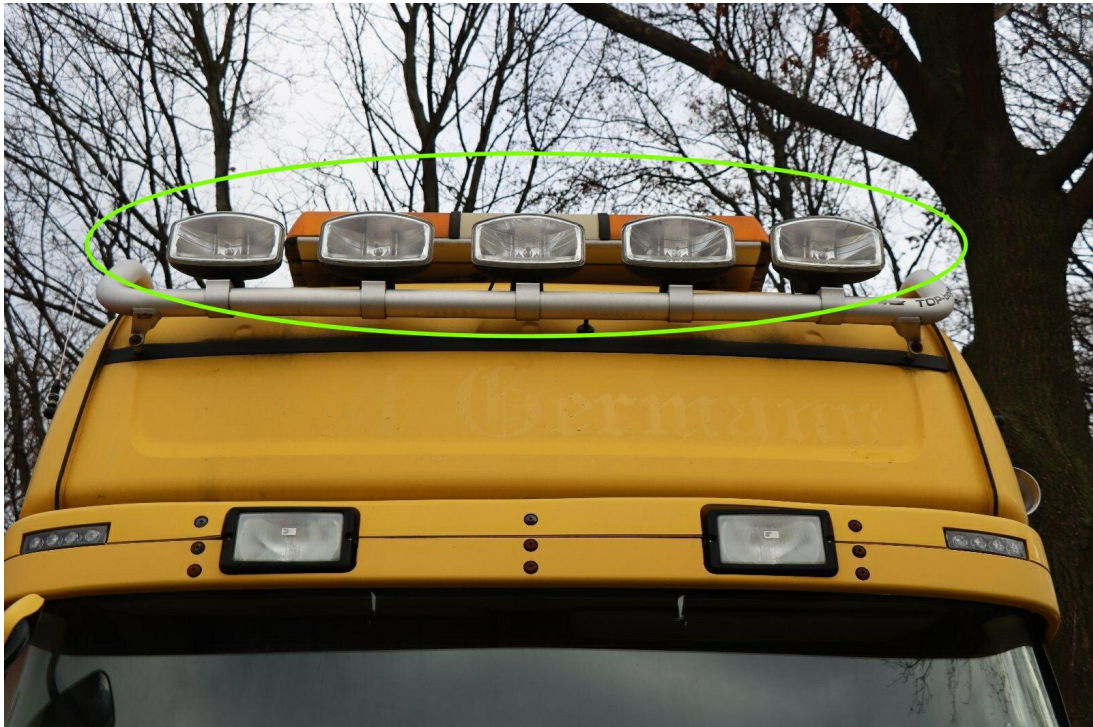
Bild 28 : Zusatzbeleuchtung / unzulässige Beleuchtung entfernen
