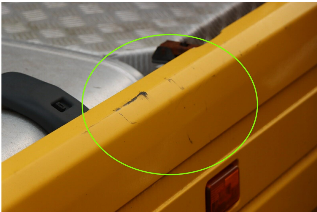
Bild 33 : seitliche Schutzvorrichtung rechts verschrammt
