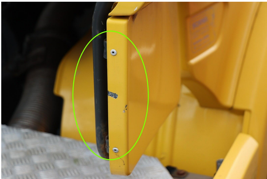
Bild 34 : Seitenspoiler rechts unten verschrammt
