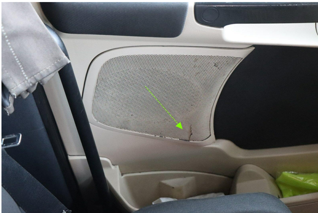
Bild 9 : Türverkleidung links Gitter Lautsprecherbox eingerissen
