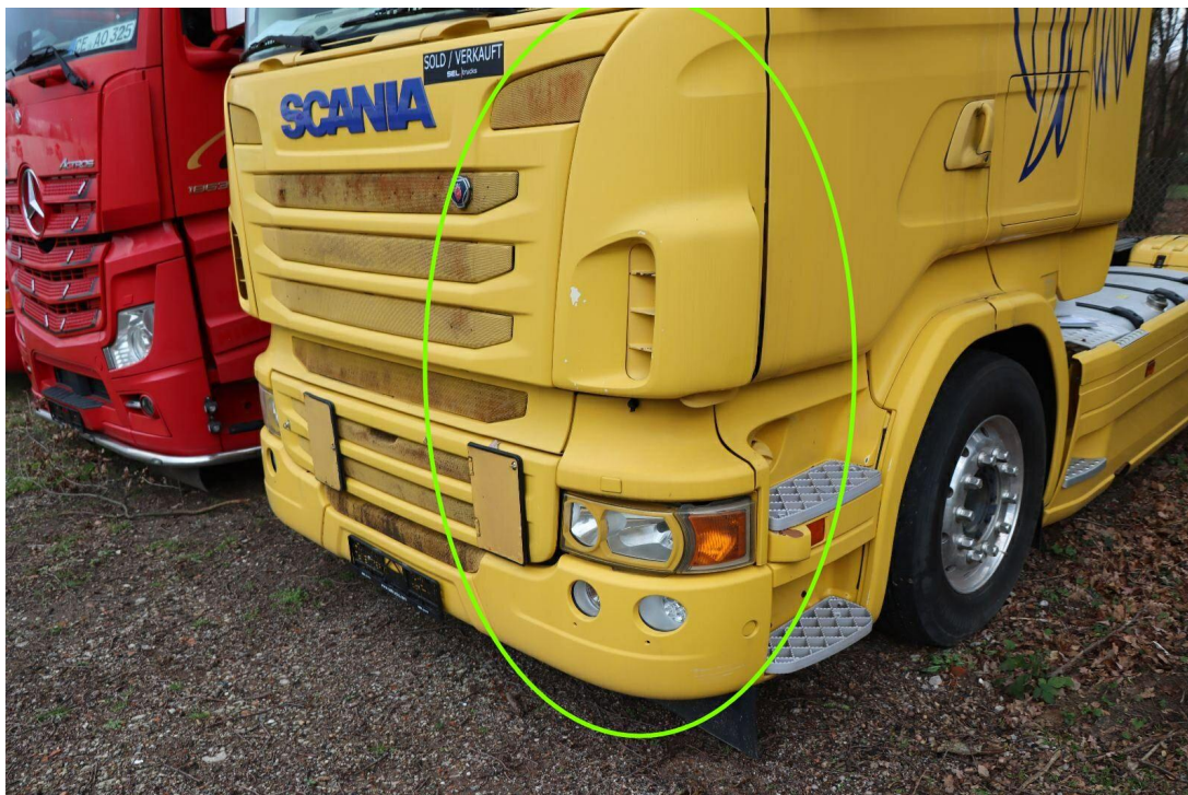
Bild 16 : Fahrerhaus außen Eckumführung Lackbeschädigungen
