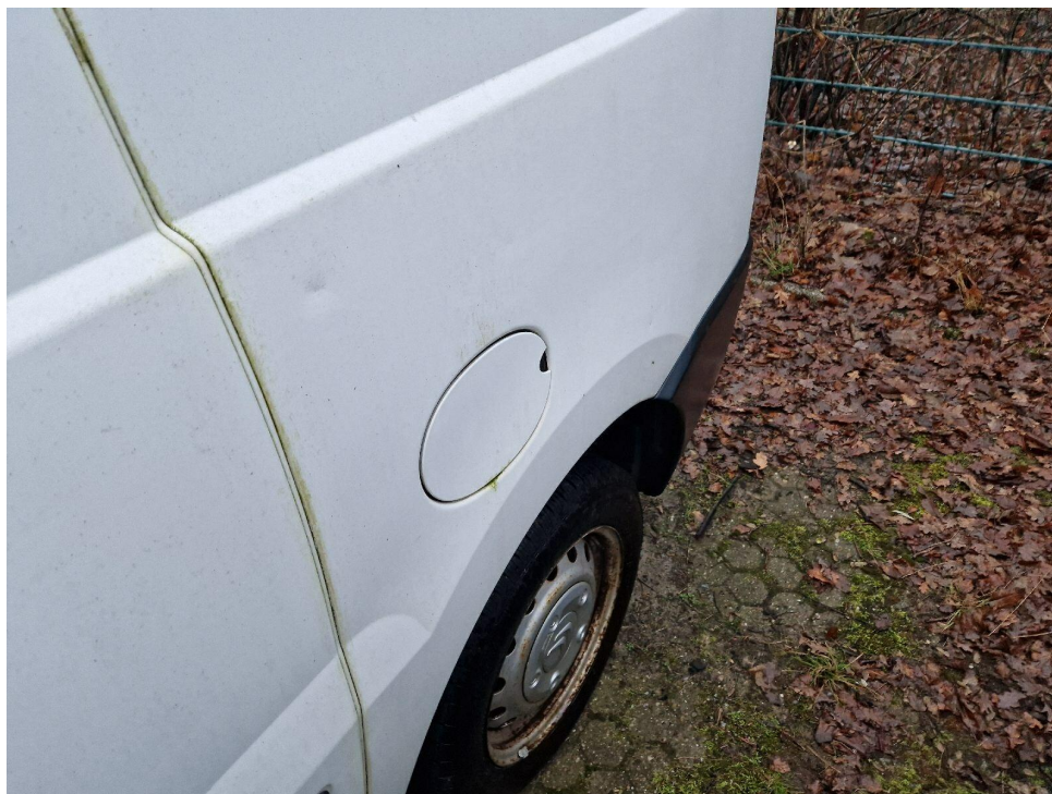
Bild 13 : Seitenwand links eingedellt
