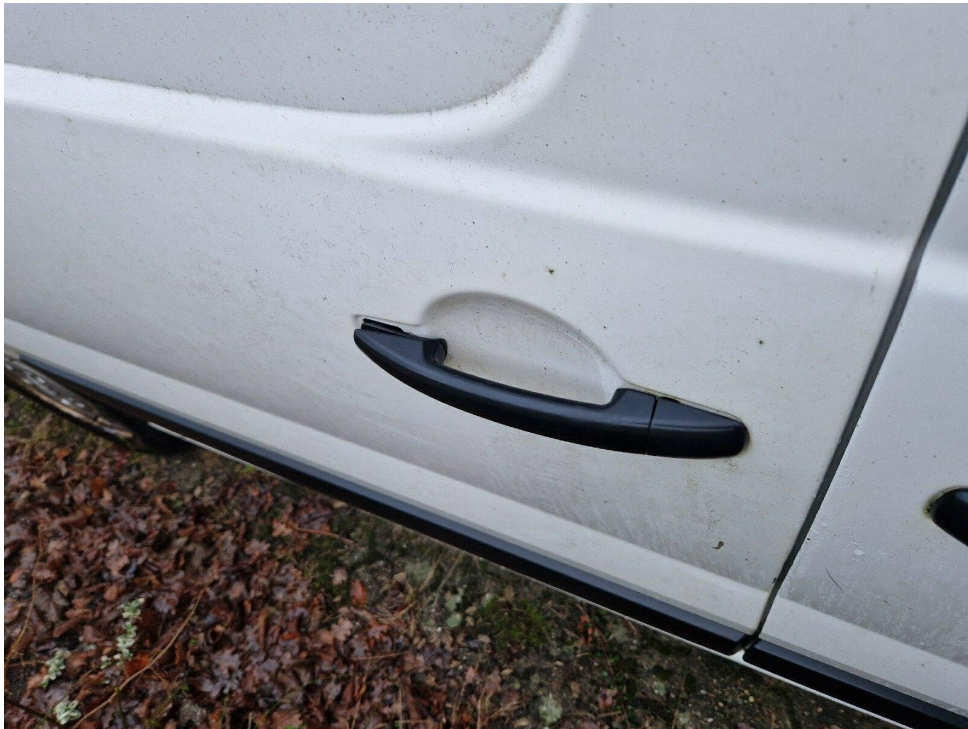
Bild 17 : Griff Schiebetür defekt
