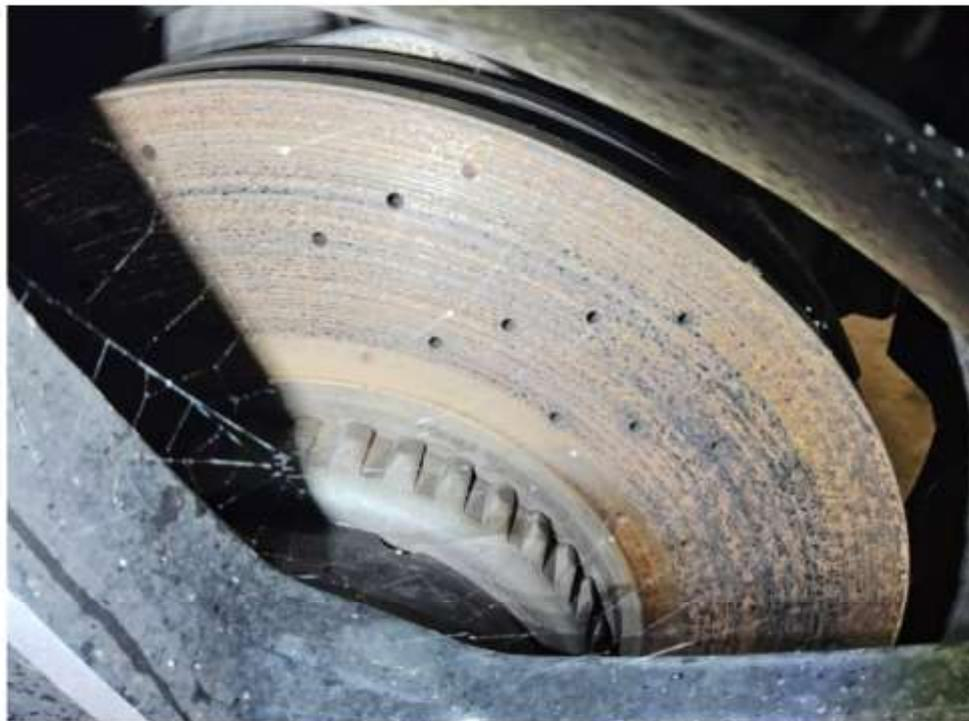
Bild 8 : Bremse vorn und hinten korrodiert
