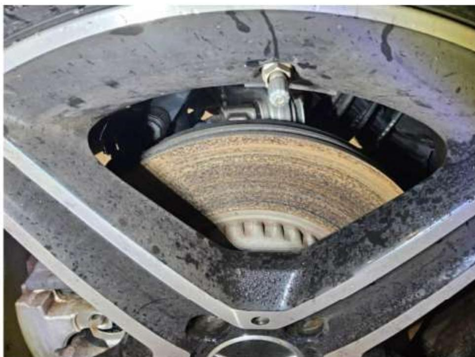
Bild 10 : Bremse vorn und hinten korrodiert
