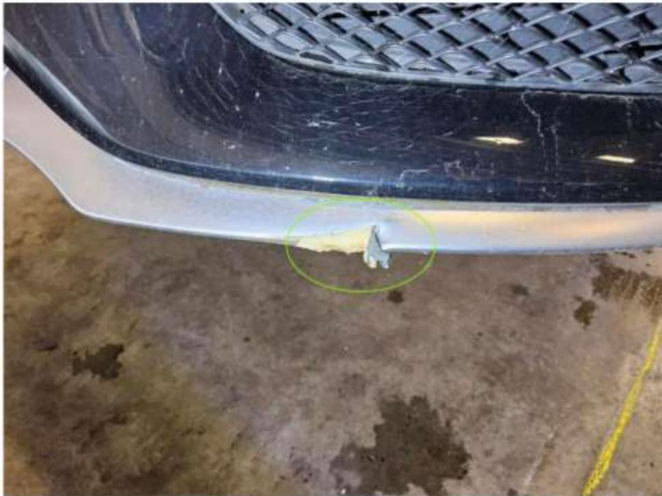
Bild 11 : Spoiler vorne links deformiert
