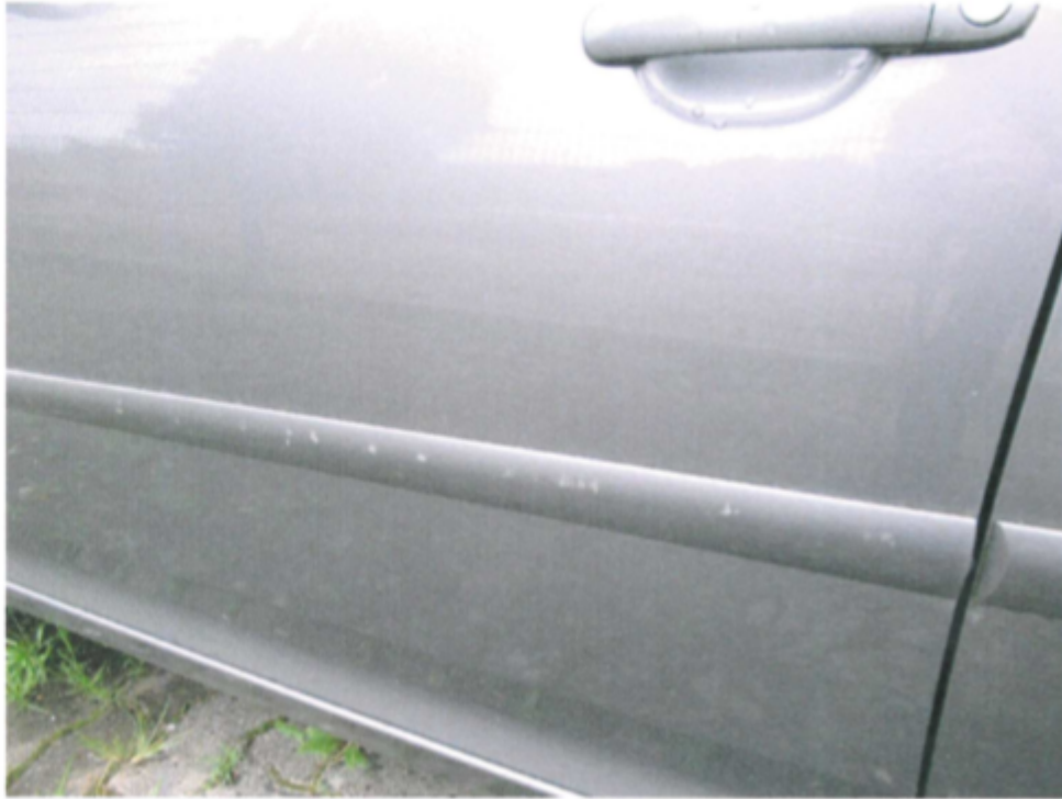
Bild 7 : Türstoßleist vorn links verschrammt
