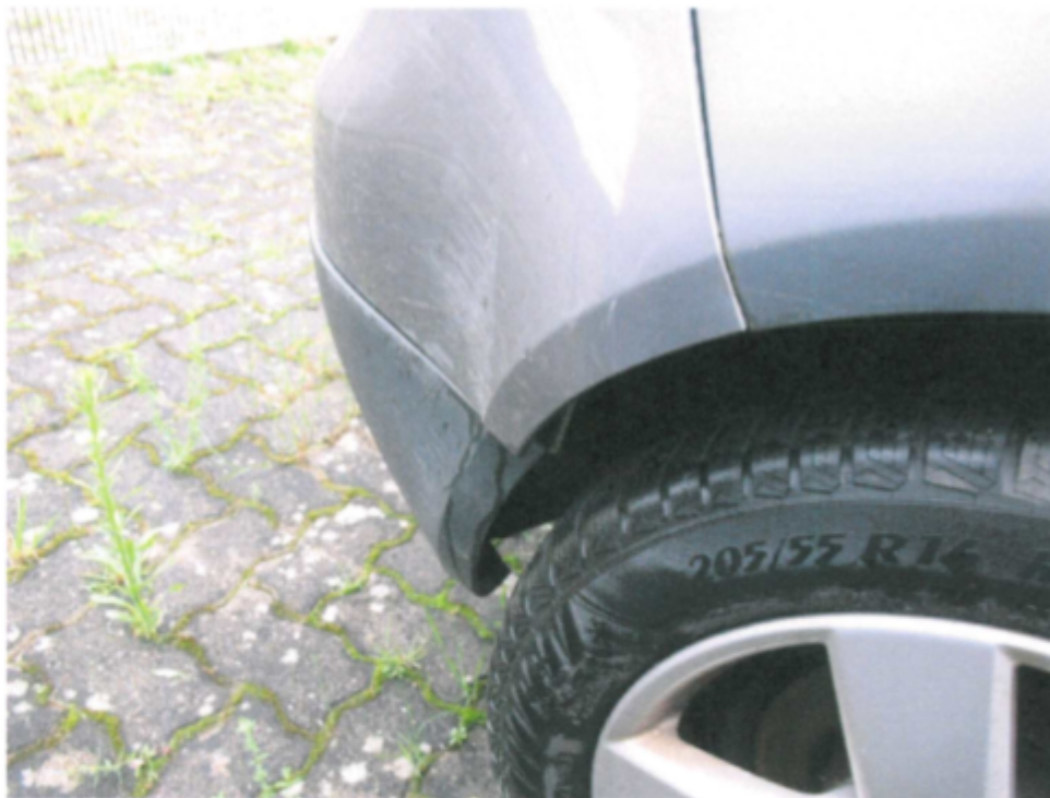
Bild 12 : Stoßfänger hinten deformiert
