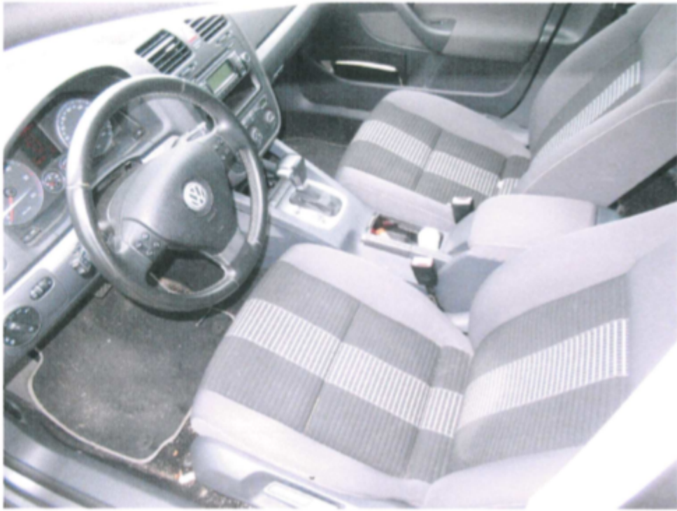
Bild 5 : Fahrzeug innen verschmutzt mit Stockflecken- nass
