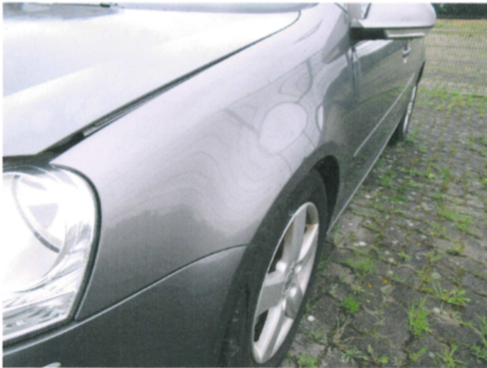
Bild 8 : Kotflügel links eingedrückt / verzogen
