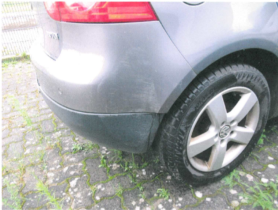
Bild 11 : Stoßfänger hinten deformiert
