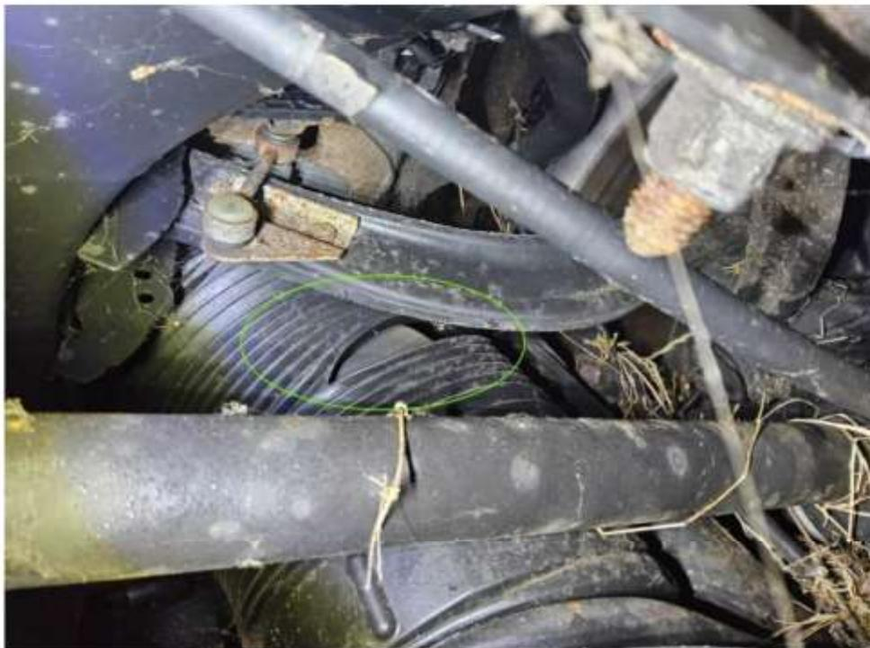
Bild 14 : Luftbalg hinten links Manschette defekt
