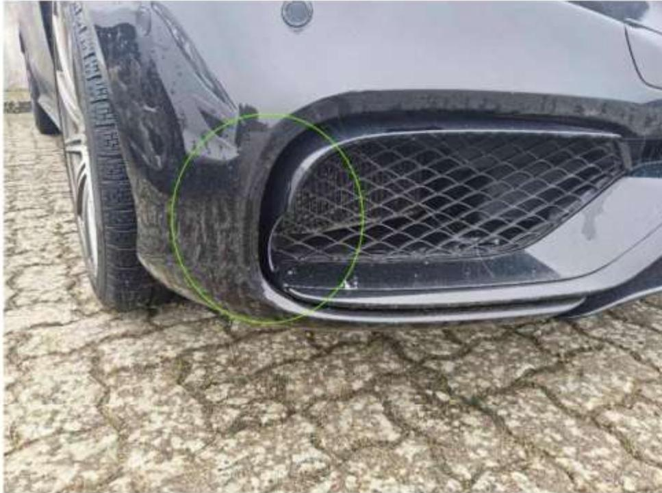
Bild 9 : Luftführung vorne rechts gebrochen
