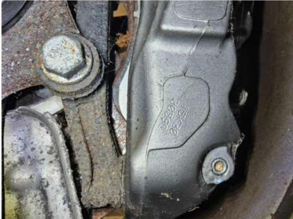
Bild 15 : Bremsen vorne und hinten korrodiert
