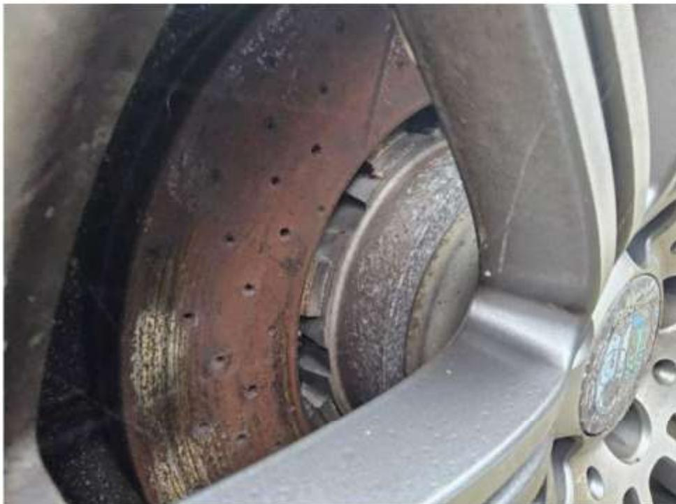
Bild 12 : Bremsen vorne und hinten korrodiert
