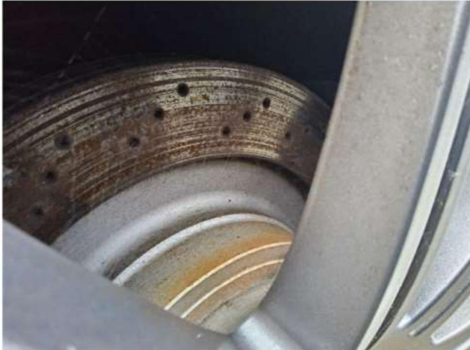
Bild 13 : Bremsen vorne und hinten korrodiert
