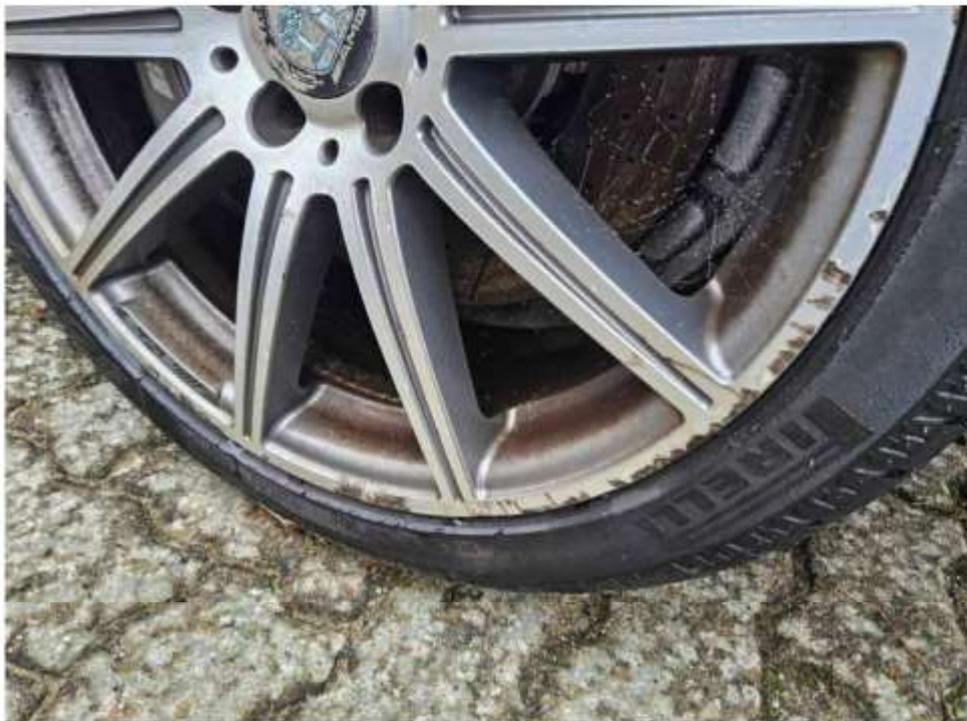
Bild 10 : Felge vorne rechts zerkratzt
