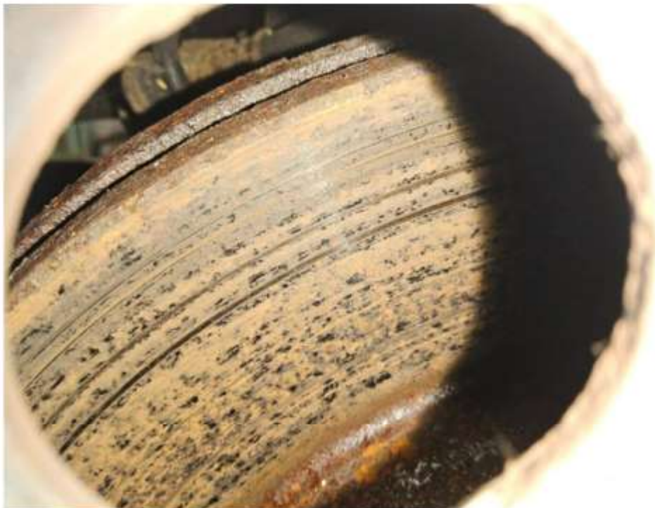
Bild 10 : Bremse vorn und hinten korrodiert
