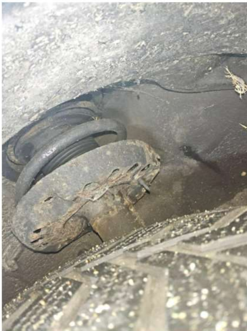
Bild 14 : Feder vorne links gebrochen
