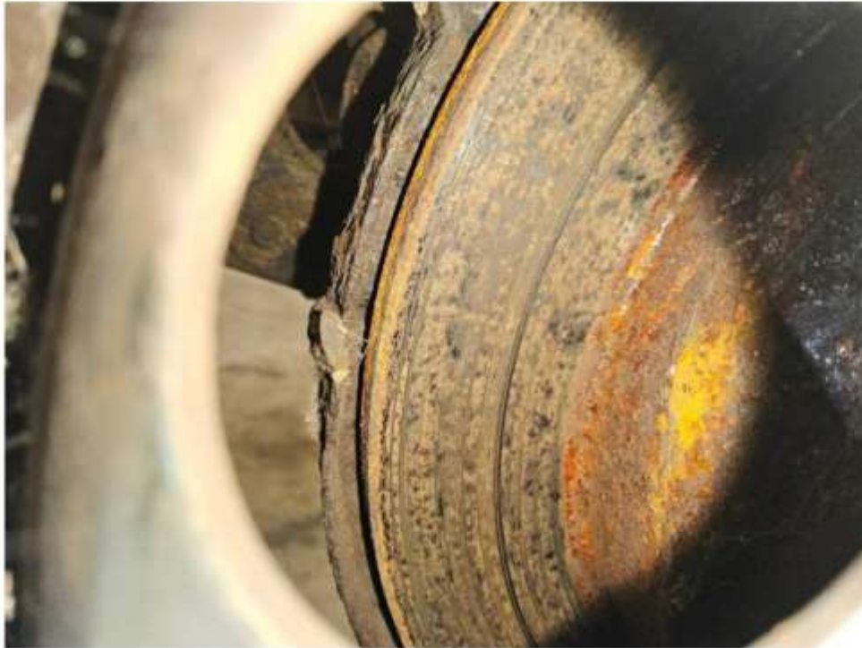
Bild 9 : Bremse vorn und hinten korrodiert
