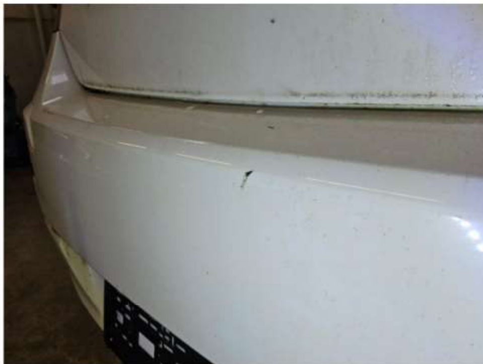
Bild 8 : Stoßfänger hinten gestaucht und zerkratzt
