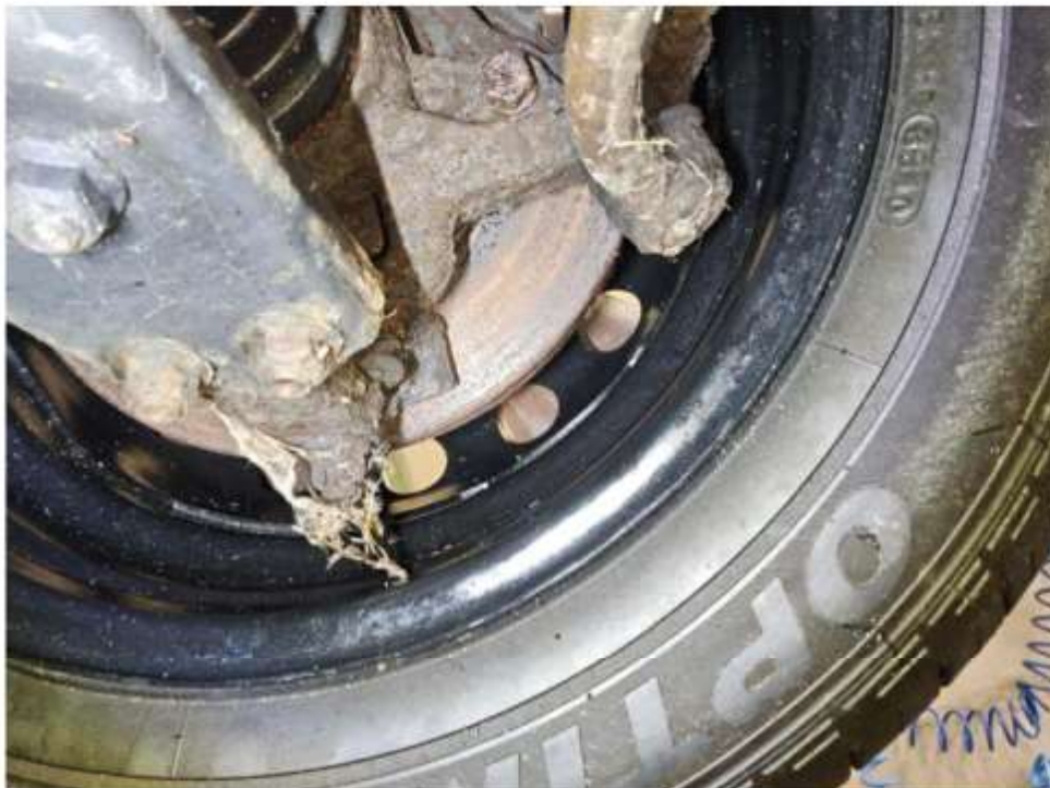
Bild 12 : Bremse vorn und hinten korrodiert
