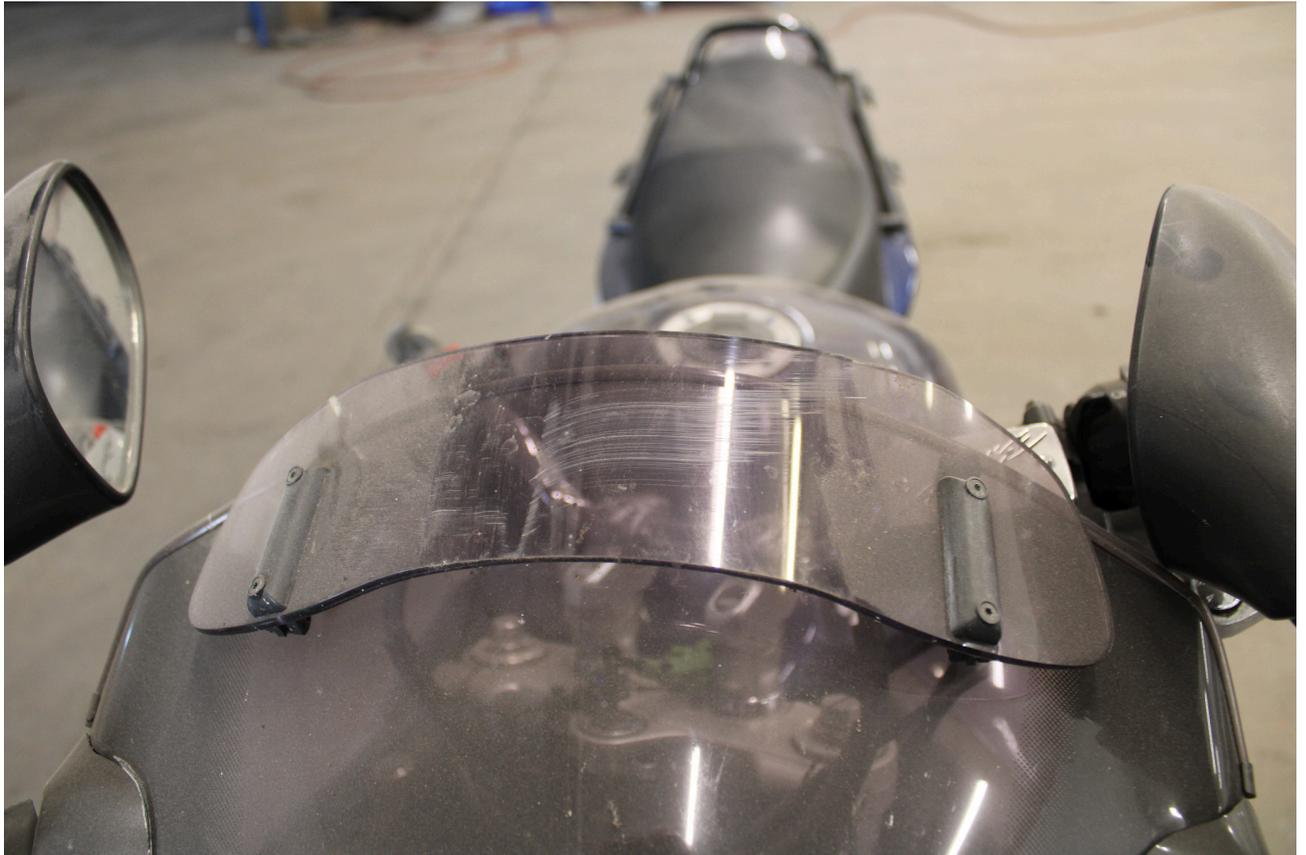
Bild 11: Zusatz Windschild verschrammt
