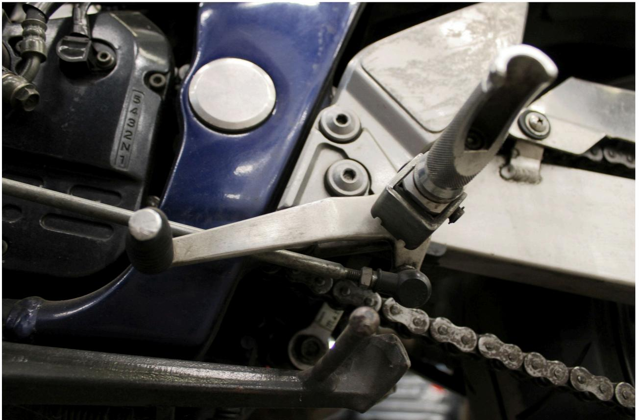
Bild 15: Schalthebel verschrammt
