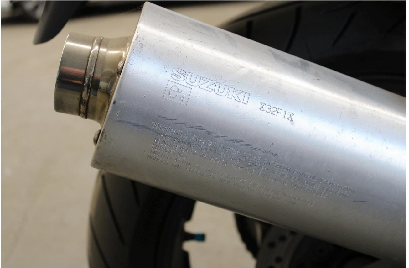
Bild 13: Schalldämpfer verschrammt
