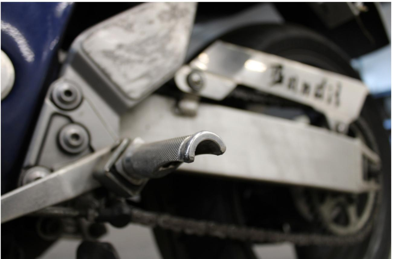
Bild 10: Fahrerfußraste links verschrammt
