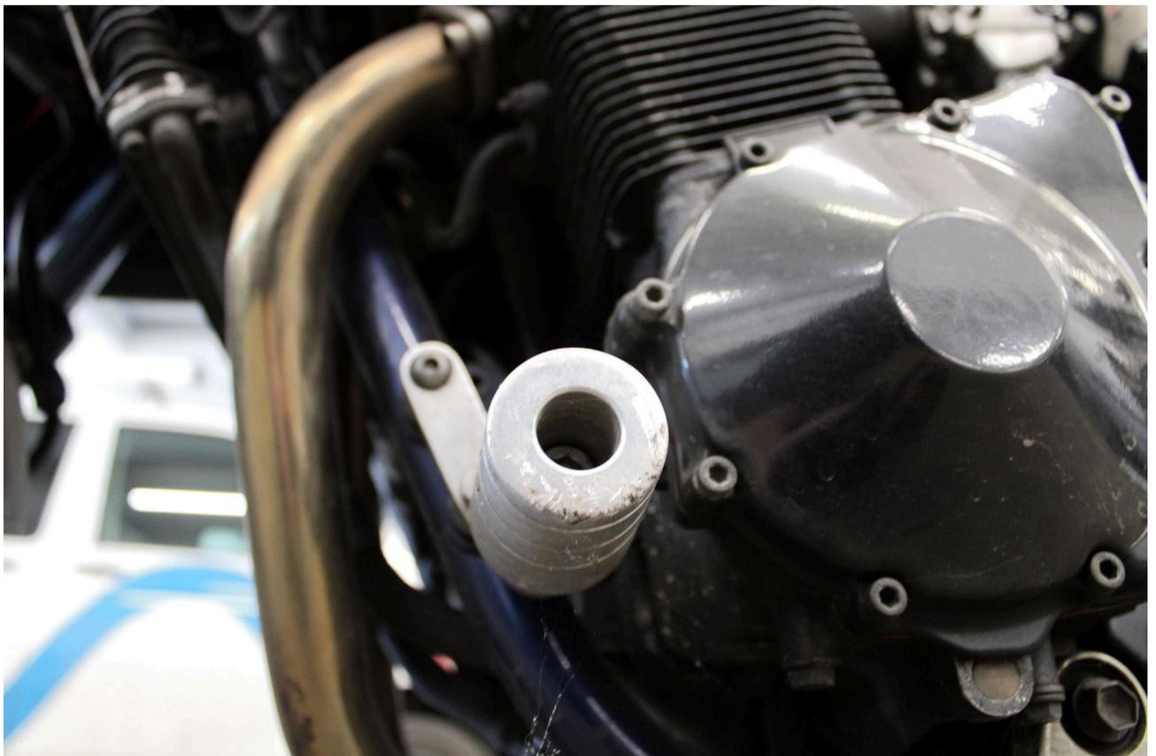
Bild 14: Sturzpad links verschrammt
