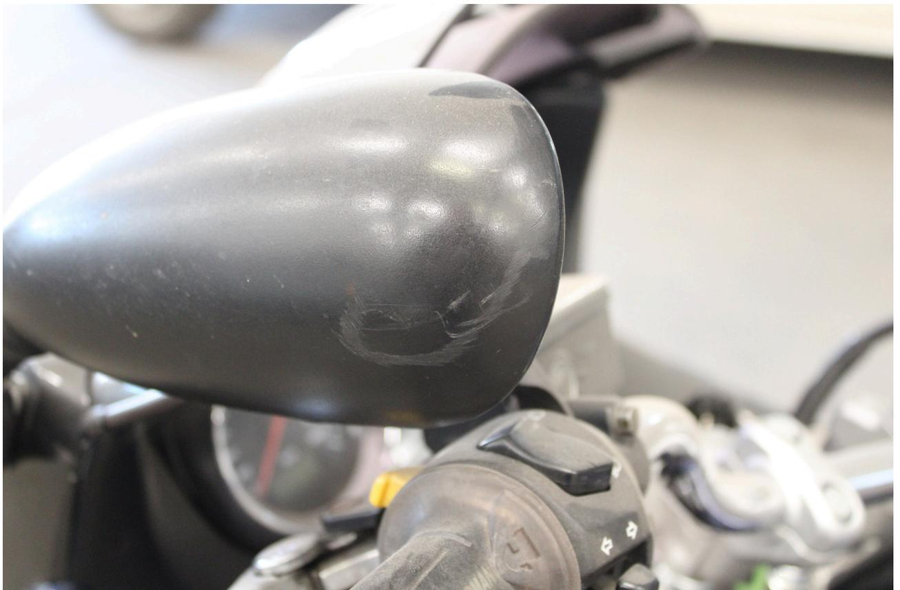
Bild 12: Rückspiegel links verschrammt
