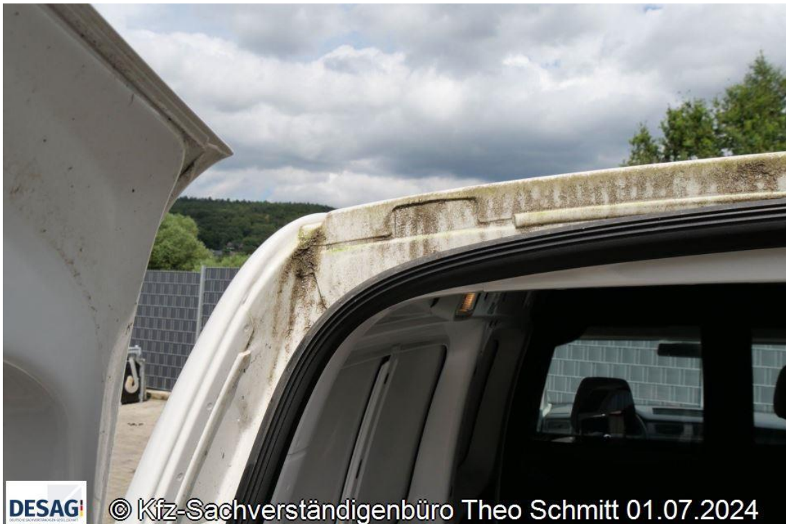
Foto 20: Übersichtsaufnahme Moosanlagerung in Kanten und Falzen
