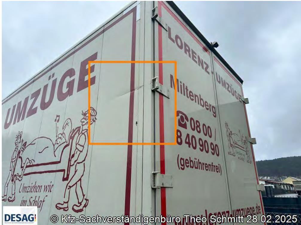
Foto 21: Kofferaufbau linke Flanke deformiert
