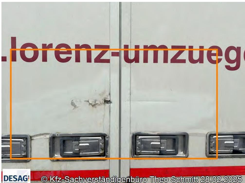
Foto 22: Hecktüren Kofferaufbau deformiert
