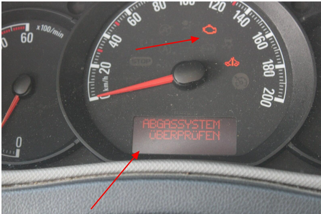
Bild 7 : Kombiinstrument zeigt Fehler im Bereich des Abgassystems an.
