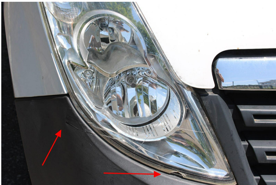
Bild 8 : Scheinwerfereinheit vorne rechts beschädigt / gesprungen
