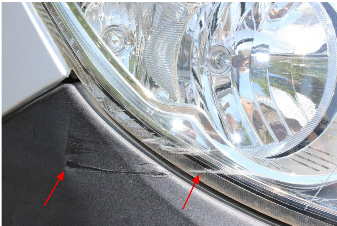
Bild 9 : Stoßfänger vorne rechts verschrammt
