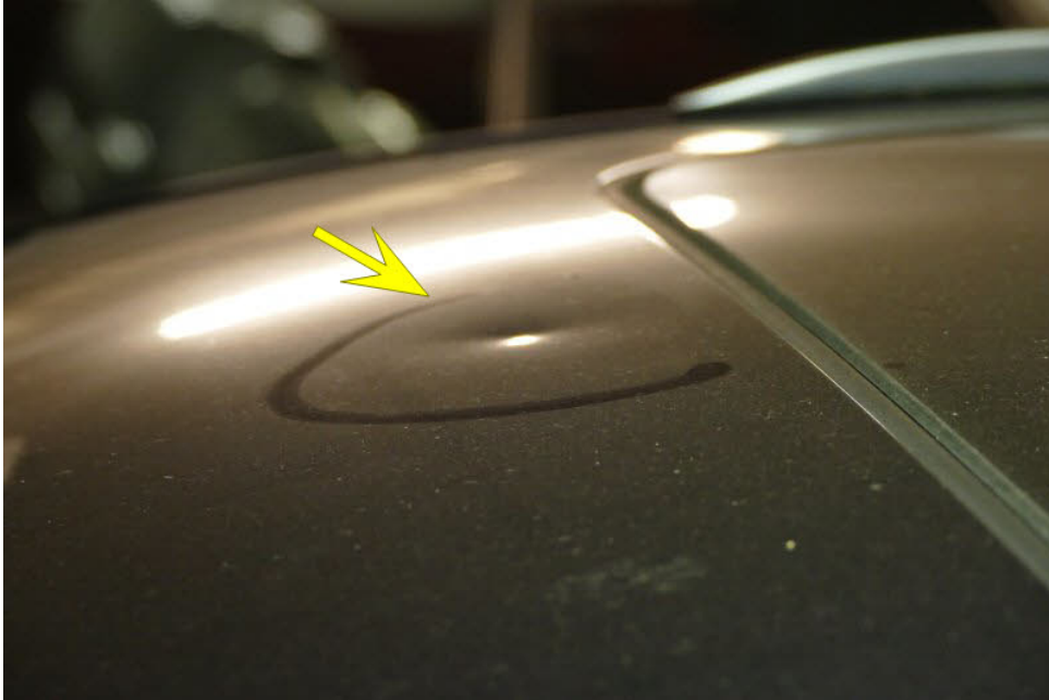
Dachbereich vorne eingeeult
