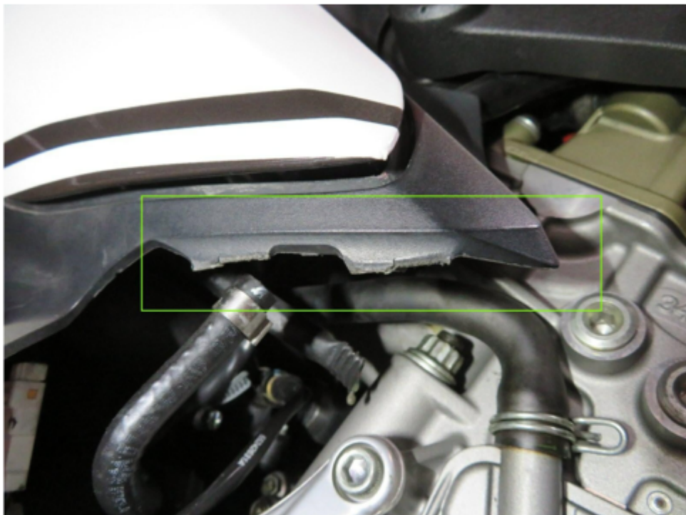
Bild 18 : Seitenverkleidung links gebrochen
