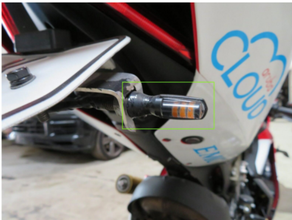
Bild 14 : Blinkerleuchte hinten links und rechts zerkratzt
