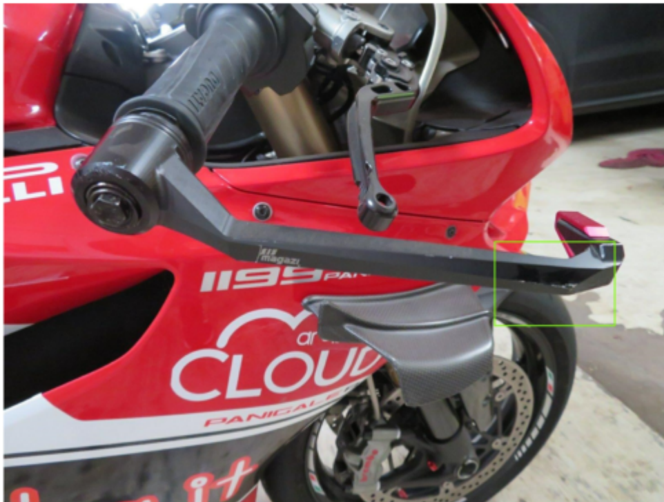
Bild 9 : Hebelstützer rechts zerkratzt
