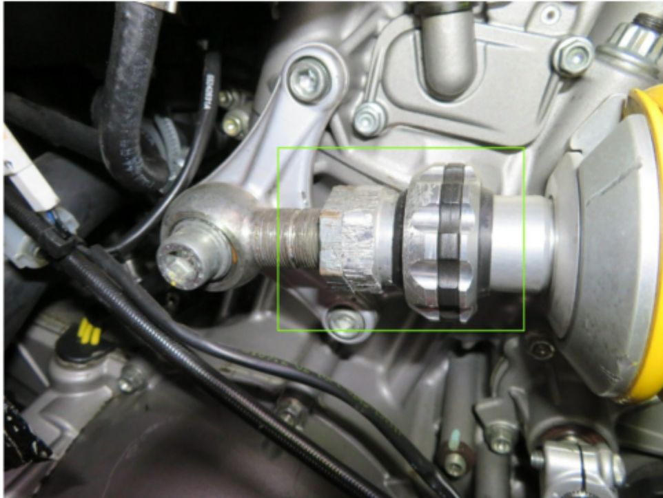
Bild 15 : Federbein Hinterachsschwinge Kontermuttern zerkratzt
