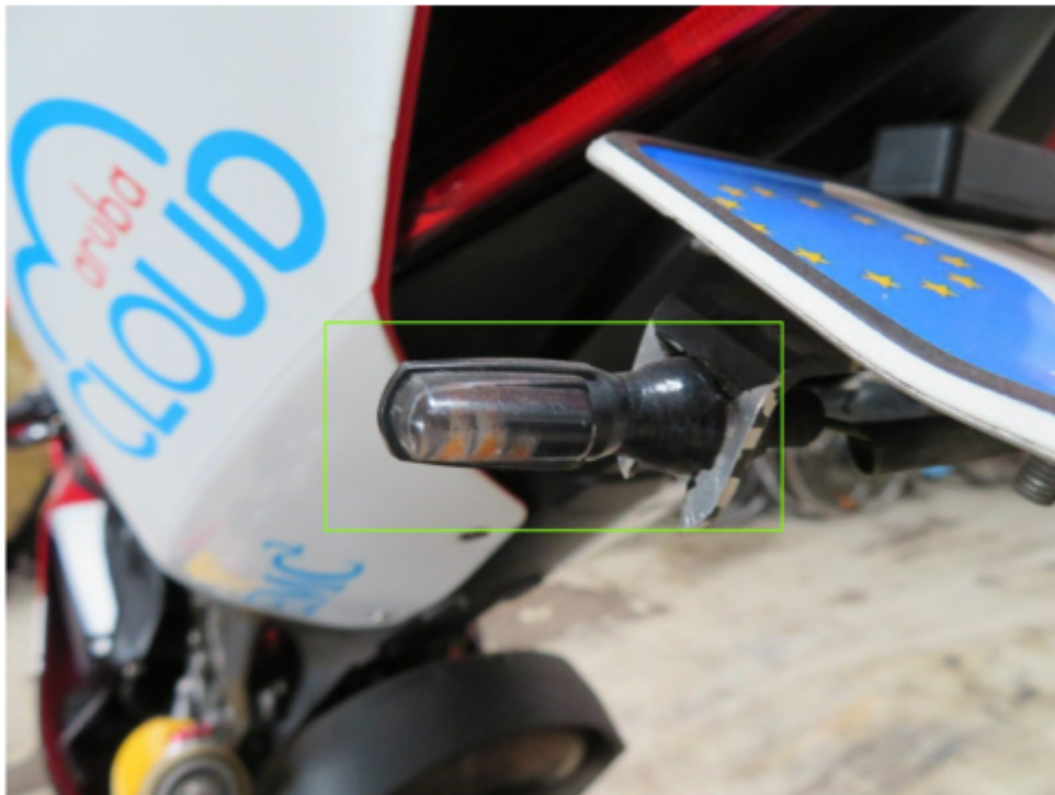
Bild 13 : Blinkerleuchte hinten links und rechts zerkratzt
