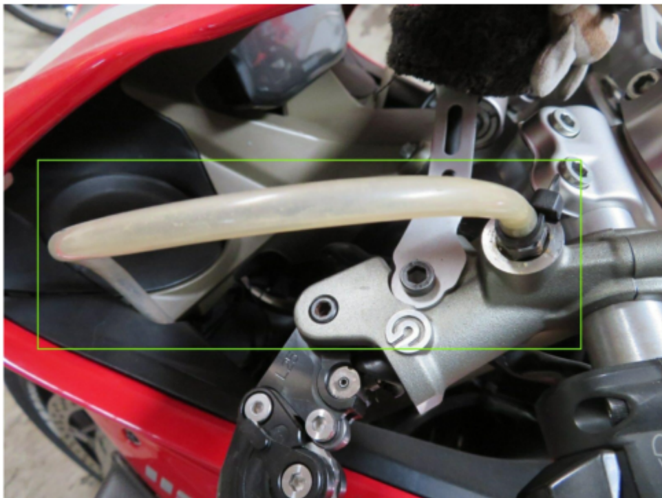
Bild 10 : Bremsanlage vorn nicht ordnungsgemäßer Zustand
