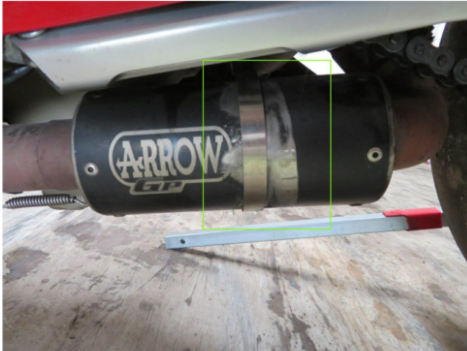
Bild 21 : Schalldämpfer Abgasanlage zerkratzt und eingedrückt
