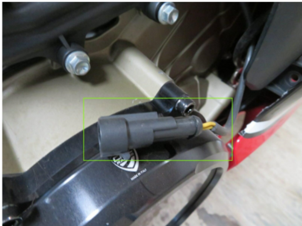
Bild 20 : Hauptkabelstrang Stecker lose
