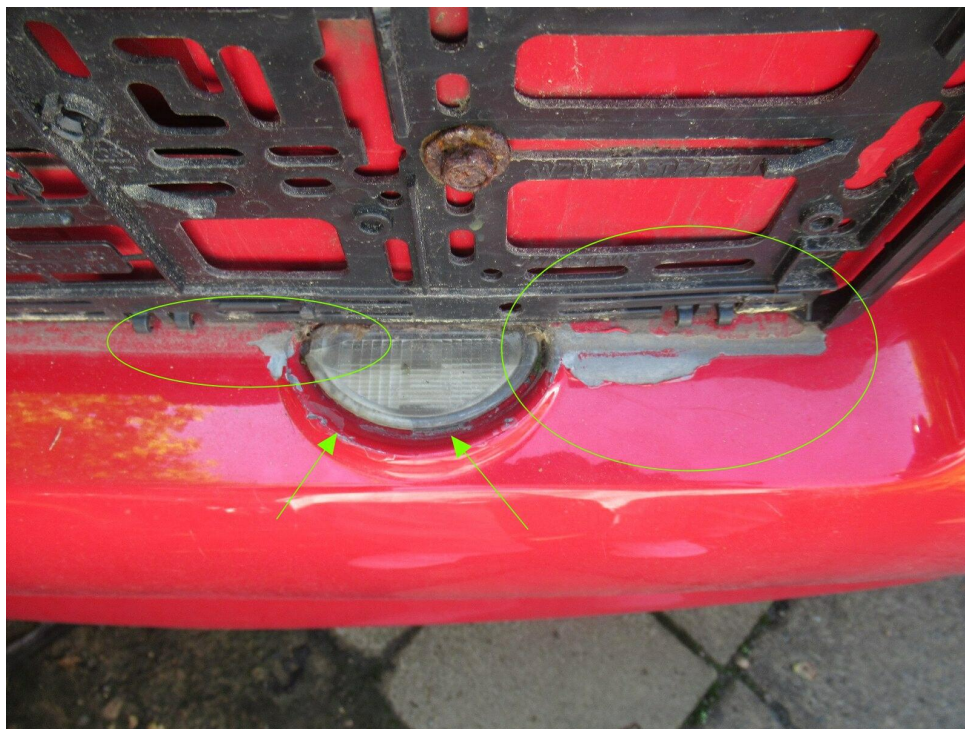
Bild 13 : Stoßfänger hinten mittig Lackabplatzer
