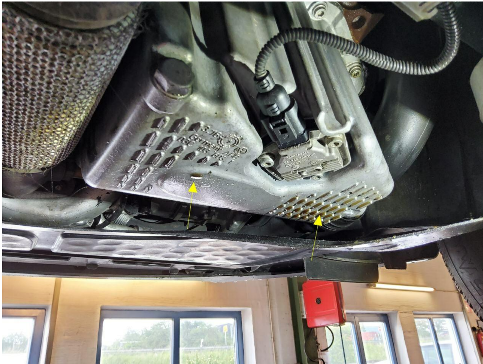
Bild 9 : Motor im Bereich des Kettentriebes und der Ölwanne undicht
