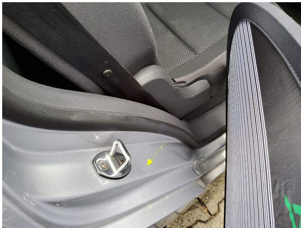
Bild 6 : Tür hinten rechts Einstieg, eingedellt, Gebrauchsspur
