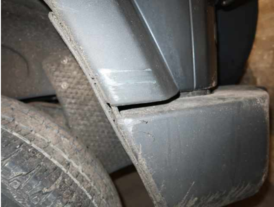
Verkratzte Radlaufverkleidung hinten links und Stoßstange
