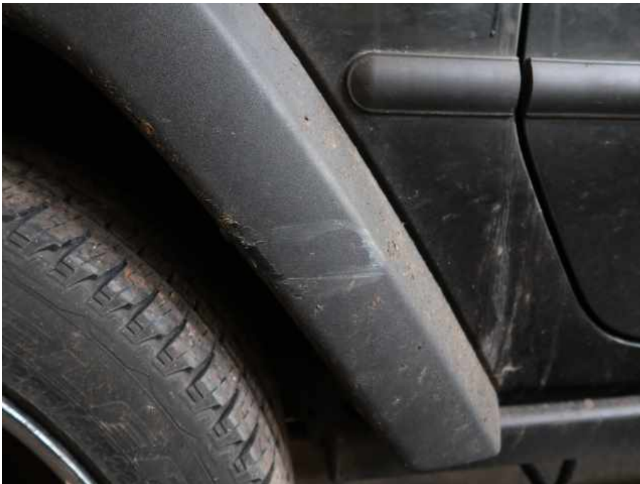
Verkratzte Radlaufverkleidung hinten rechts
