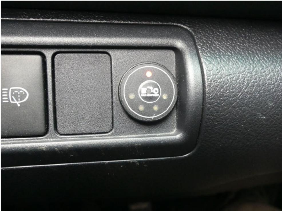
Bild: 15 Ausweisung Anzeige Gasanlage
