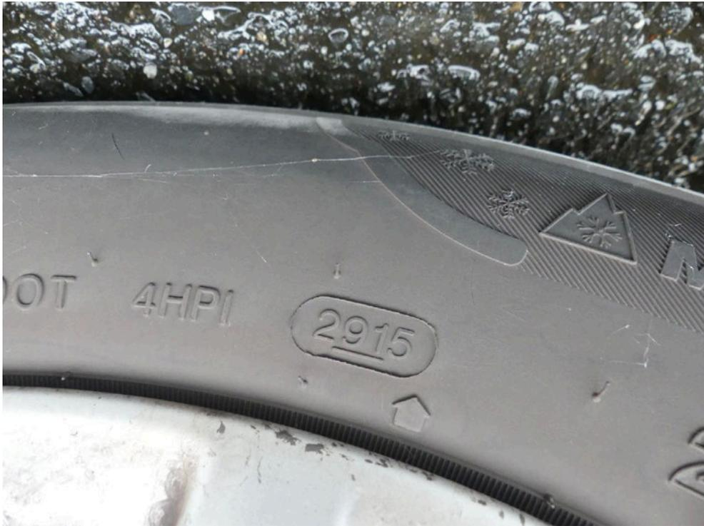
Bild: 29 Ausweisung der DOT Nummer Radialreifen vorn links
