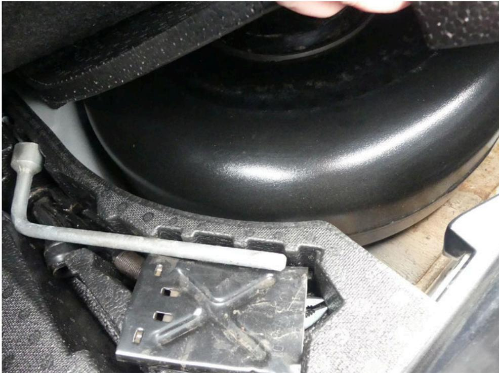
Bild: 21 Ansicht Autogastank im Kofferraum
