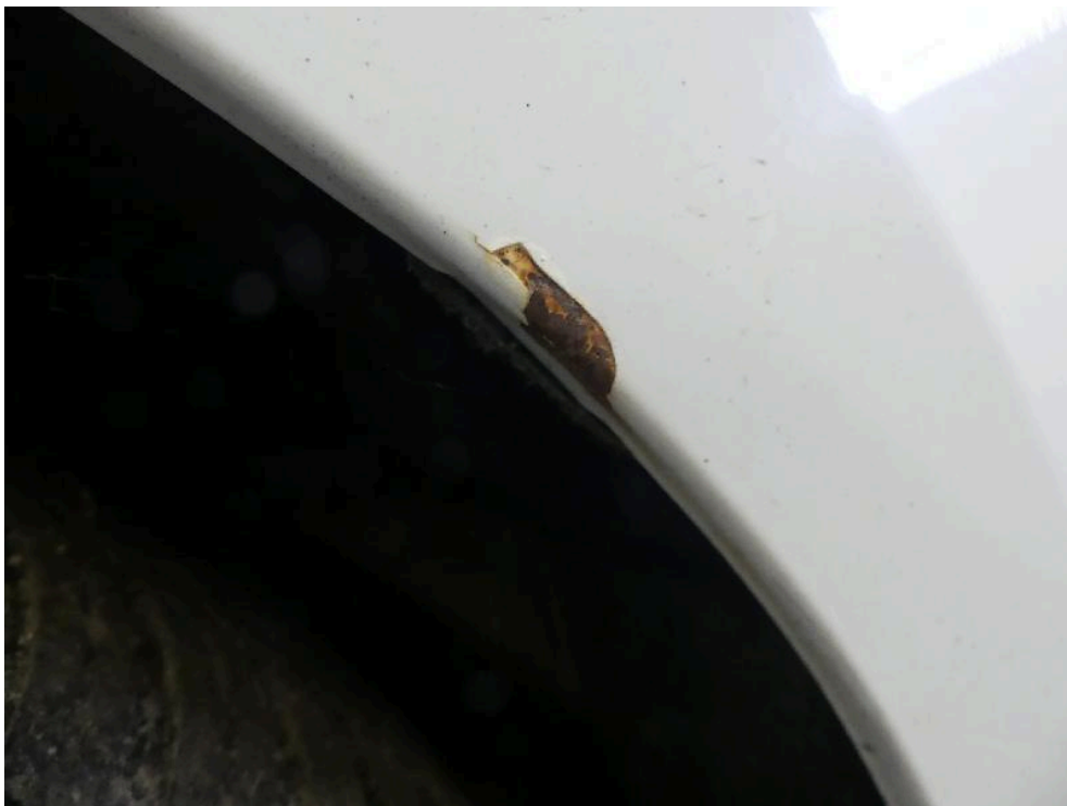
Bild: 45 ... der Lackaufbau ist partiell abgeplatzt, signifikante Korrosion ist vorhanden.
