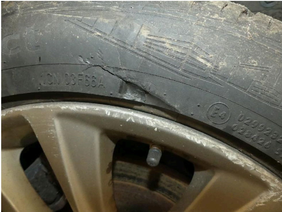
Bild: 36 Radialreifen hinten rechts erheblich beschädigt.
