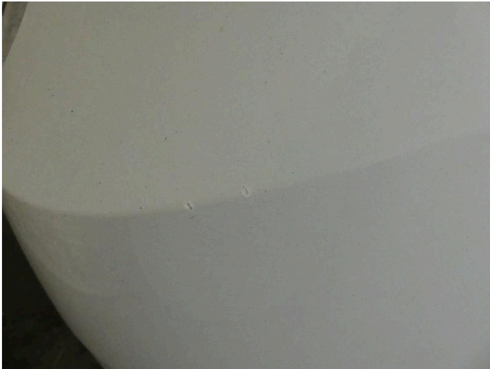
Bild: 50 Heckverkleidung partiell im Lackaufbau beschädigt.
