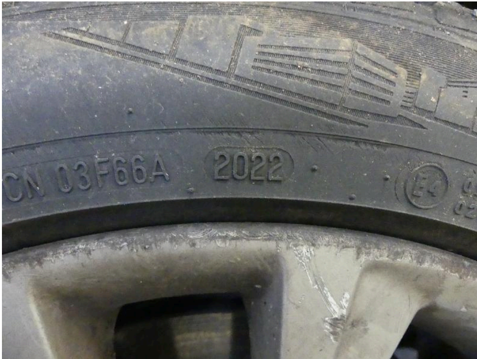
Bild: 40 Ausweisung der DOT Nummer der Radialreifen
