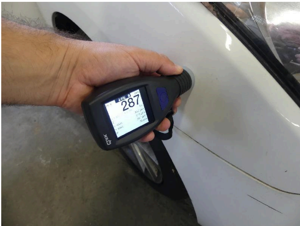
Bild: 31 Ausweisung Lackschichtdickenmessung vorgenommen, Messwerte dem beiliegenden Protokoll entnehmen.
