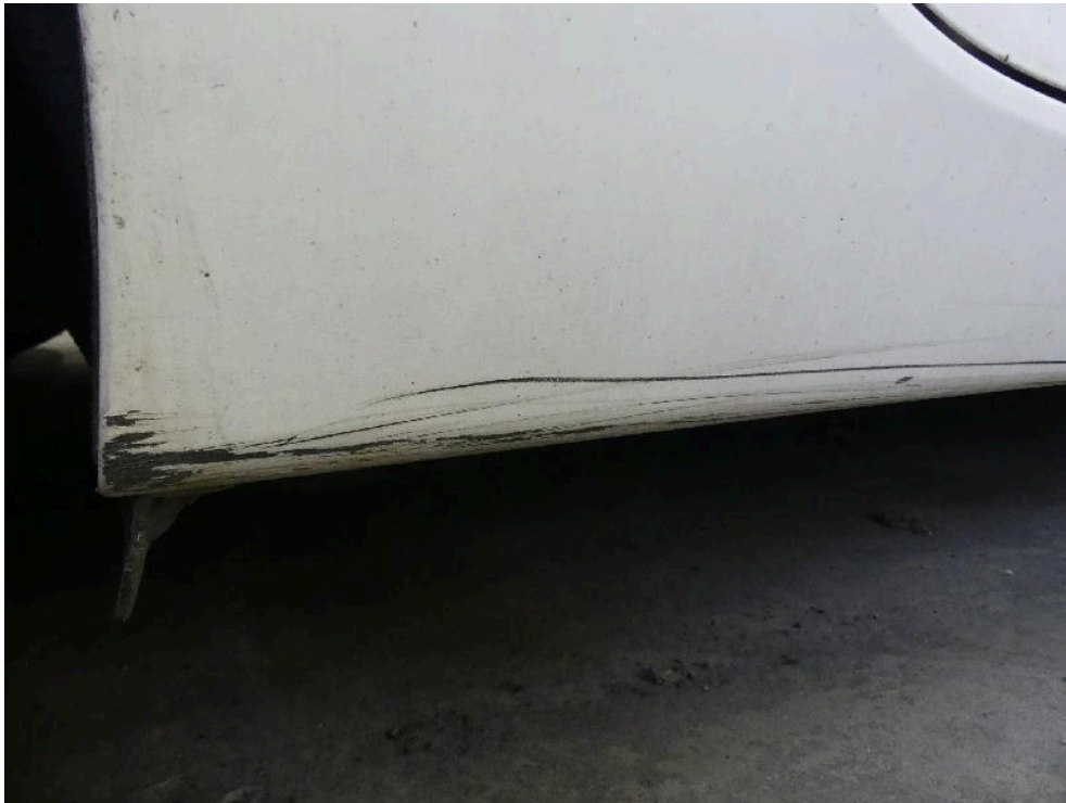
Bild: 52 Abdeckung Einstiegsschweller rechts im Lackaufbau markiert / beschädigt.
