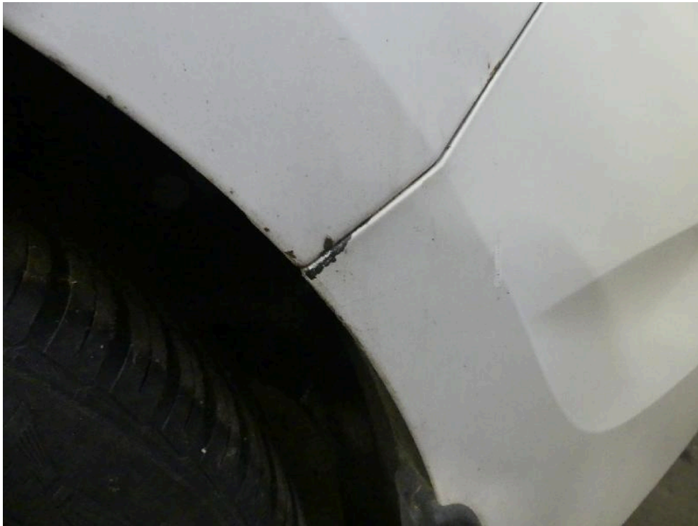
Bild: 48 Detailansicht Seitenwand links im Übergang zur Heckverkleidung, der Lackaufbau ist beschädigt.
