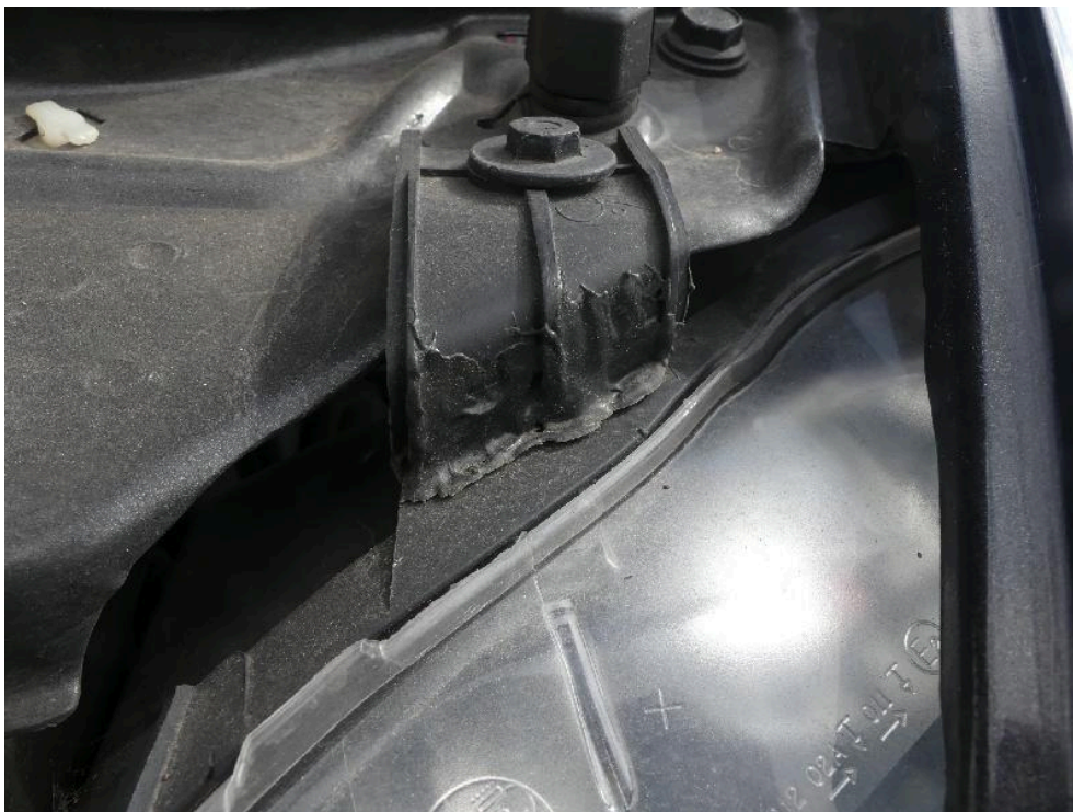
Bild: 46 Hauptscheinwerfer links im Befestigungspunkt repariert / geklebt.
