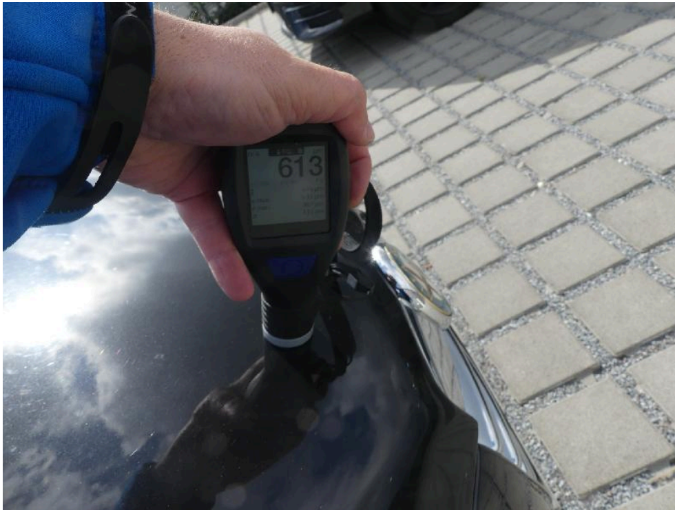
Bild: 81 Ausweisung Lackschichtdickenmessung vorgenommen, Messwerte dem beiliegenden Protokoll entnehmen.
