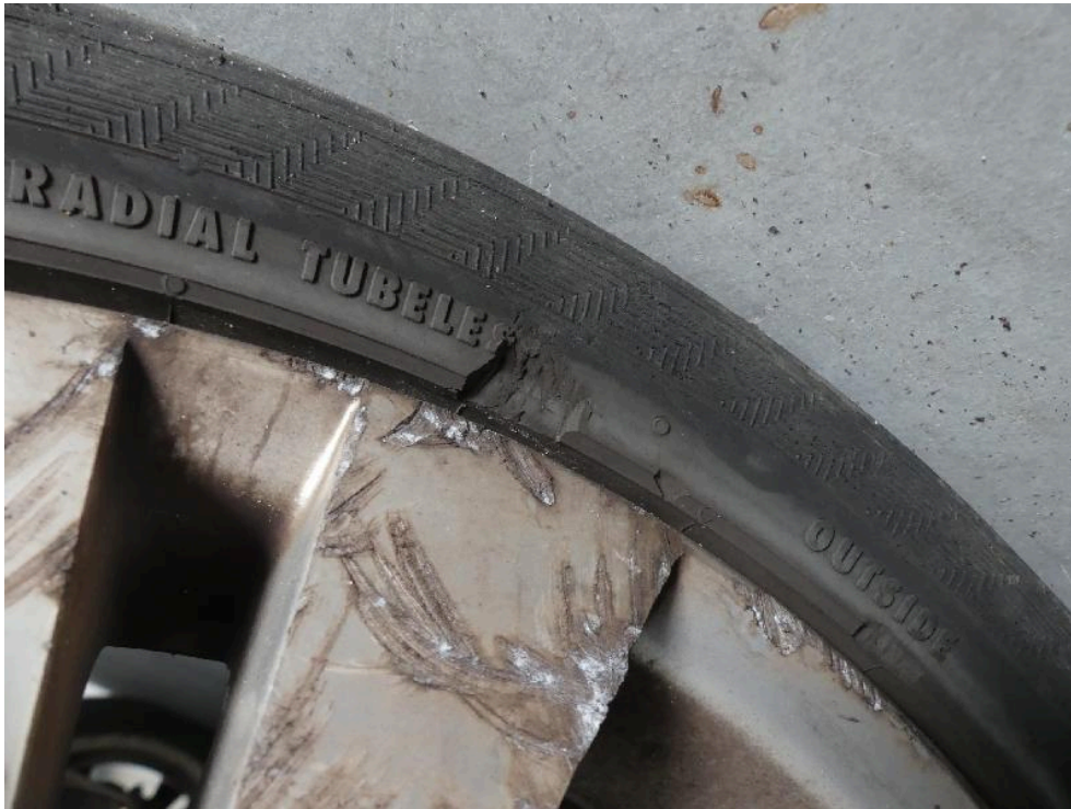
Bild: 11 Radialreifen partiell in der Reifenflanke abgetragen.
