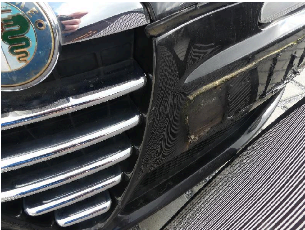
Bild: 68 Fortführend ist die Frontverkleidung links überstreckt deformiert.
