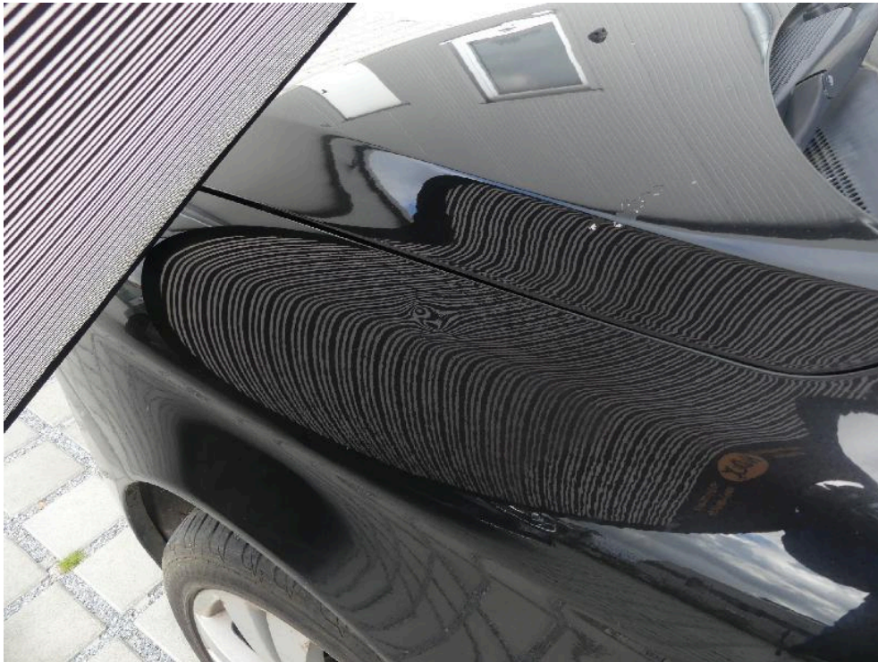
Bild: 47 Ansicht Kotflügel vorn link, punktuelle Deformation vorhanden.
