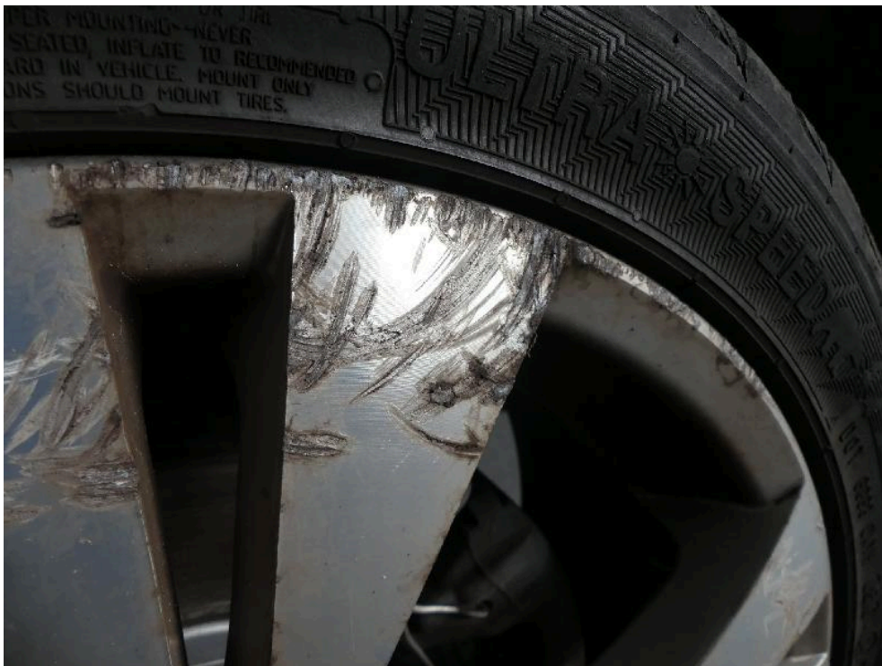
Bild: 10 LM-Felgen massiv im Grundmaterial abgetragen.
