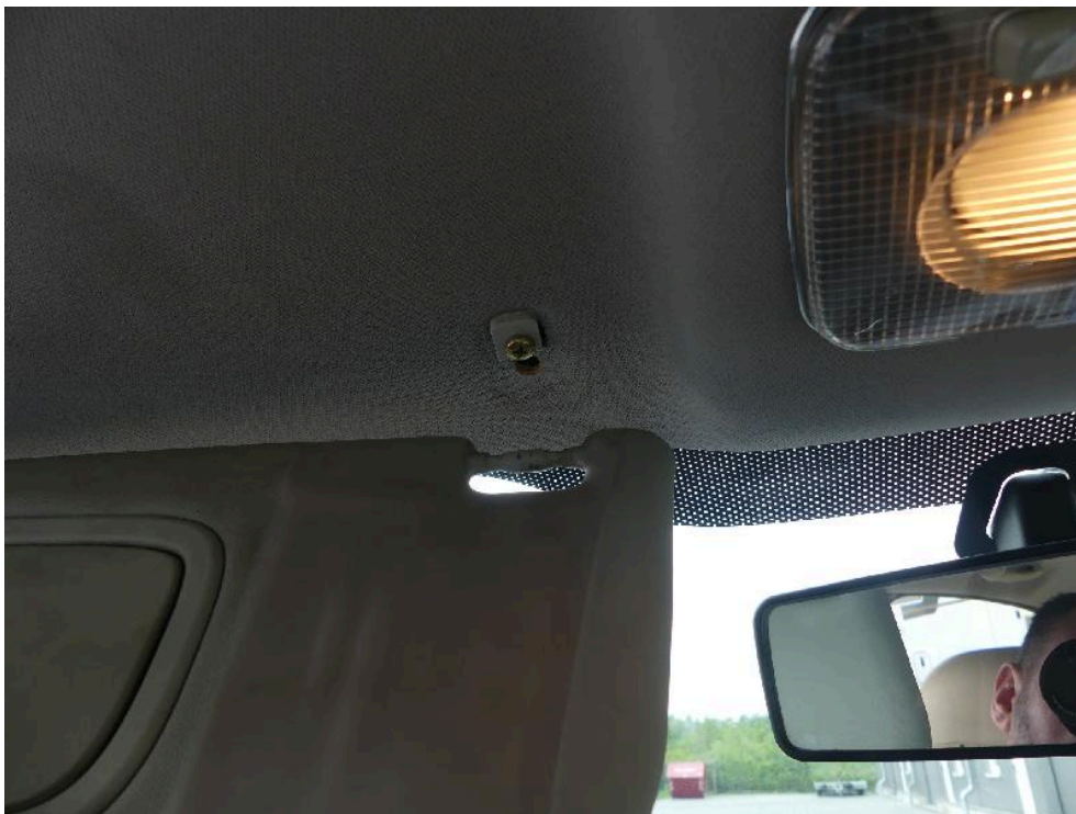
Bild: 26 Befestigung Sonnenblende links abgebrochen.
