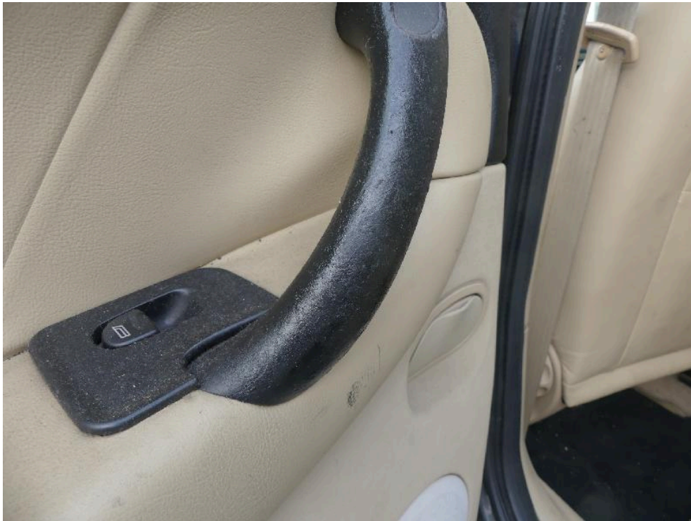
Bild: 29 Detailansicht Zuziehgriff Fondtür links, die Beschichtung ist flächig angelöst - sehr klebend.
