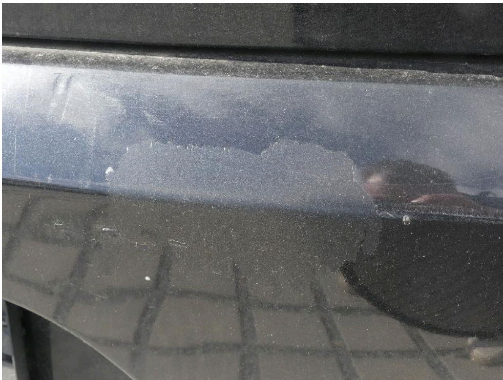
Bild: 56 Klarlackablösung Heckverkleidung.
