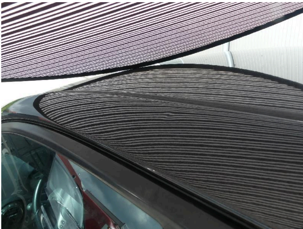
Bild: 52 Dachholm links Eindellung
