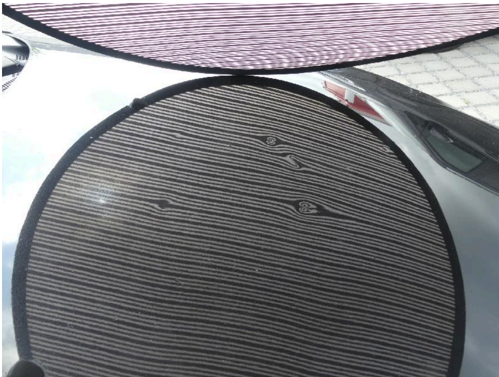
Bild: 66 Weiterführend sind mehrere punktuelle Eindellungen in der Motorhaube vorhanden.
