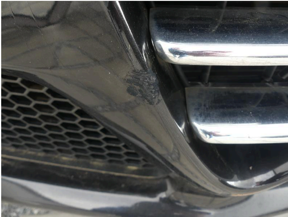
Bild: 67 Detailansicht Frontverkleidung, Deformation im Grundmaterial vorhanden.
