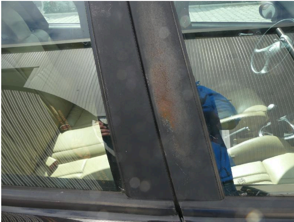
Bild: 61 Ansicht Fahrzeugtüren rechts, Folierung / Abdeckung beschädigt.
