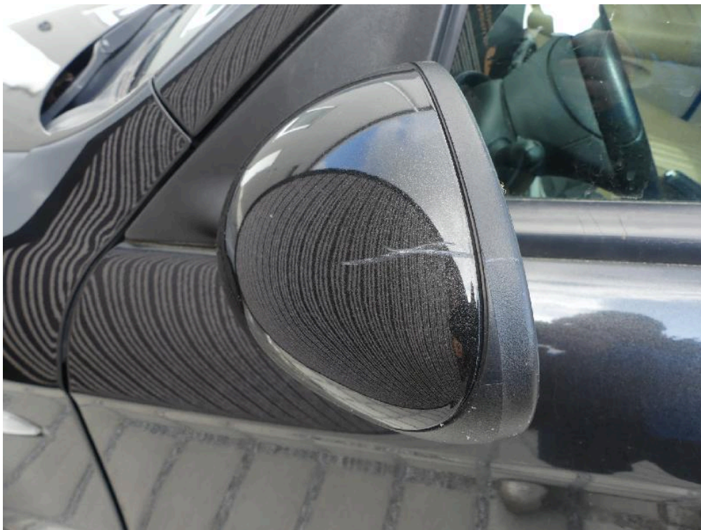
Bild: 48 Außenspiegel links beschädigt.
