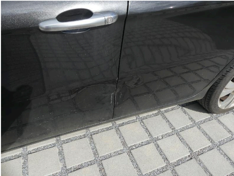
Bild: 49 Fahrzeugtüren links gestaucht.
