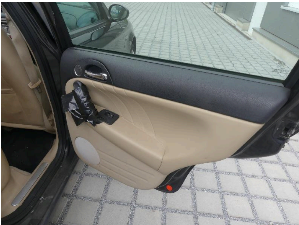
Bild: 36 Ansicht Türverkleidung hinten rechts / Zuziehgriff löst sich in der Beschichtung auf - sehr klebend !
