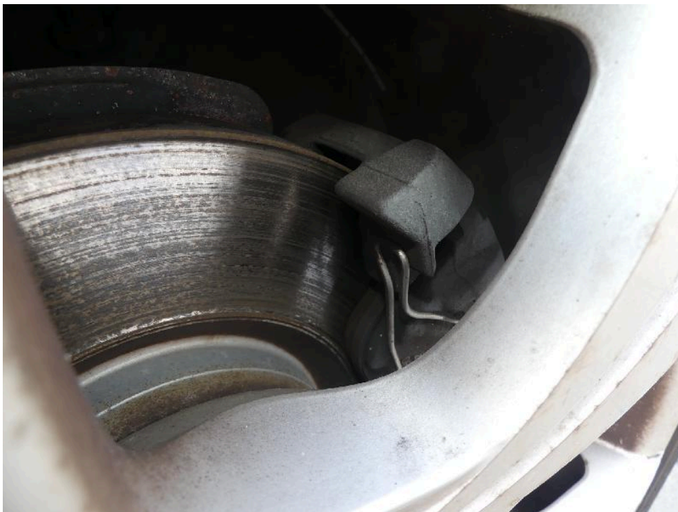
Bild: 74 Signifikante Standschäden in der Bremsanlage
