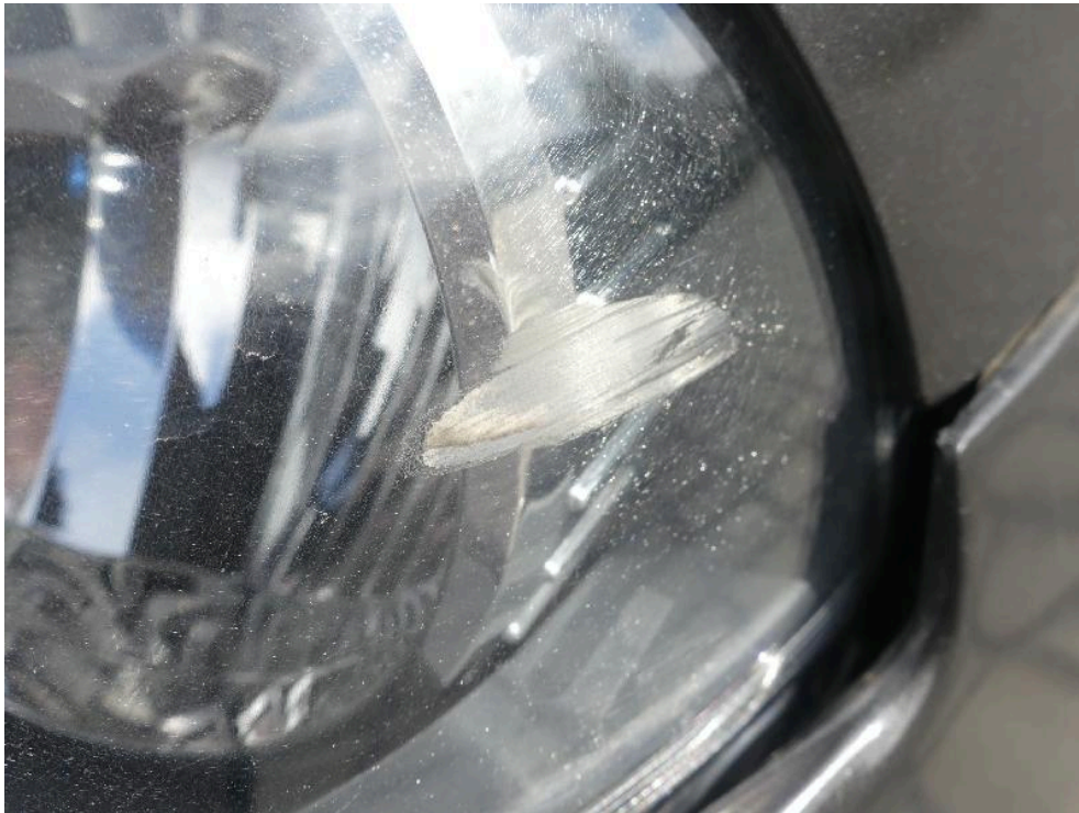
Bild: 71 Einzelansicht Hauptscheinwerfer links, Klarglasscheibe verkratzt.
