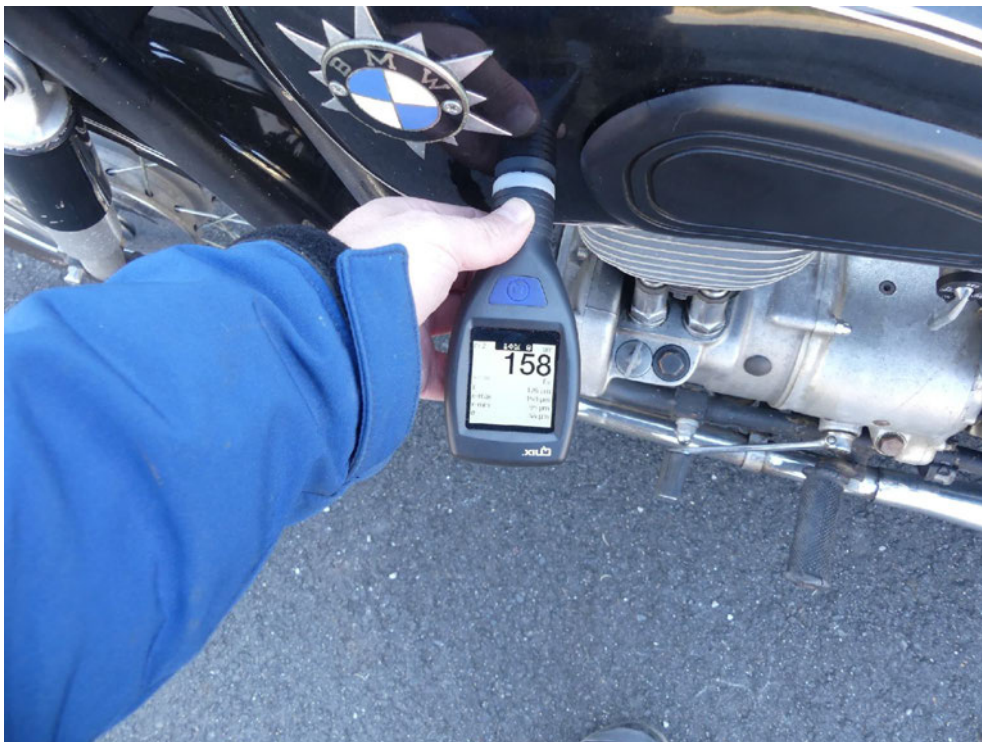
Bild: 41 Ausweisung Lackschichtdickenmessung Tank
