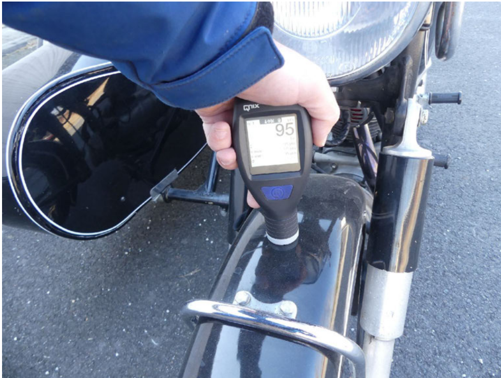
Bild: 40 Ausweisung Lackschichtdickenmessung Kotflügel vorn
