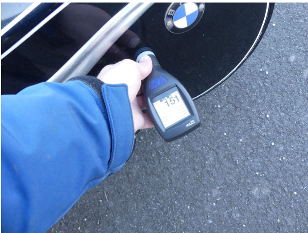
Bild: 43 Ausweisung Lackschichtdickenmessung Seitenwagen
