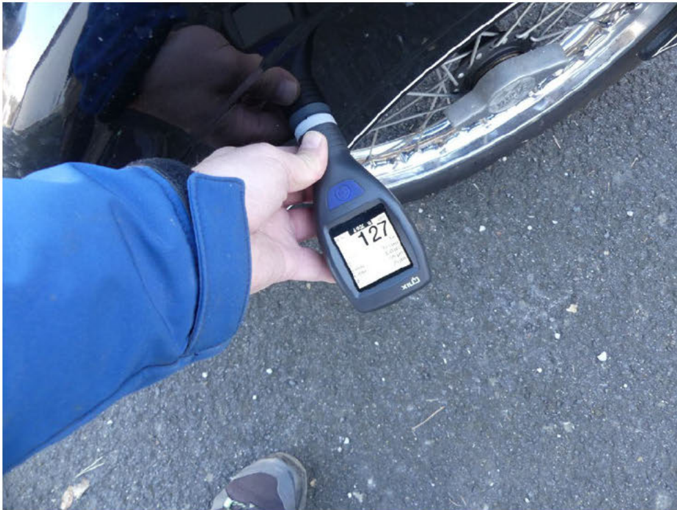
Bild: 44 Ausweisung Lackschichtdickenmessung Kotflügel Seitenwagen
