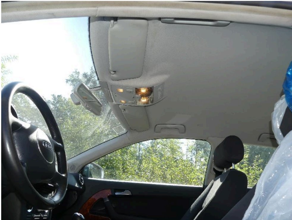
Bild: 17 Ansicht Innenhimmel, partiell im vorderen Segment abgelöst.
