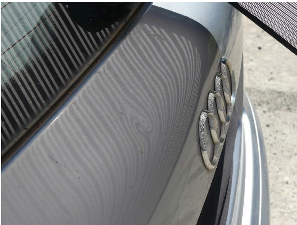
Bild: 46 Heckklappe ist im oberen Segment gestaucht.
