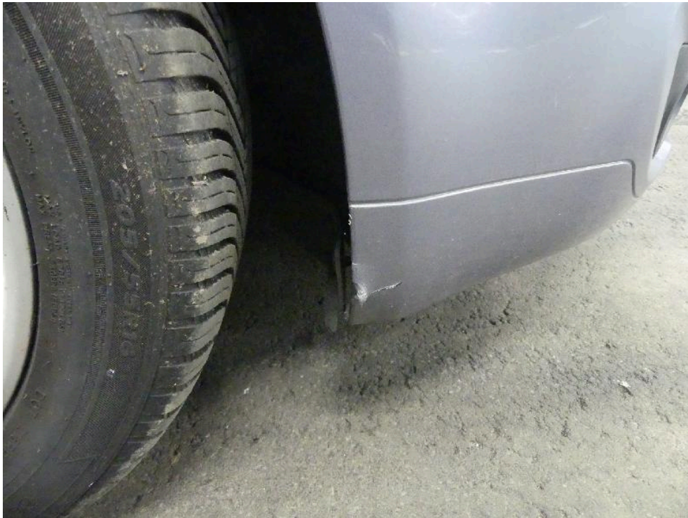
Bild: 55 Weiterführend ist die Frontverkleidug im unteren Segment im Grundmaterial gestauch und bleibend verworfen.
