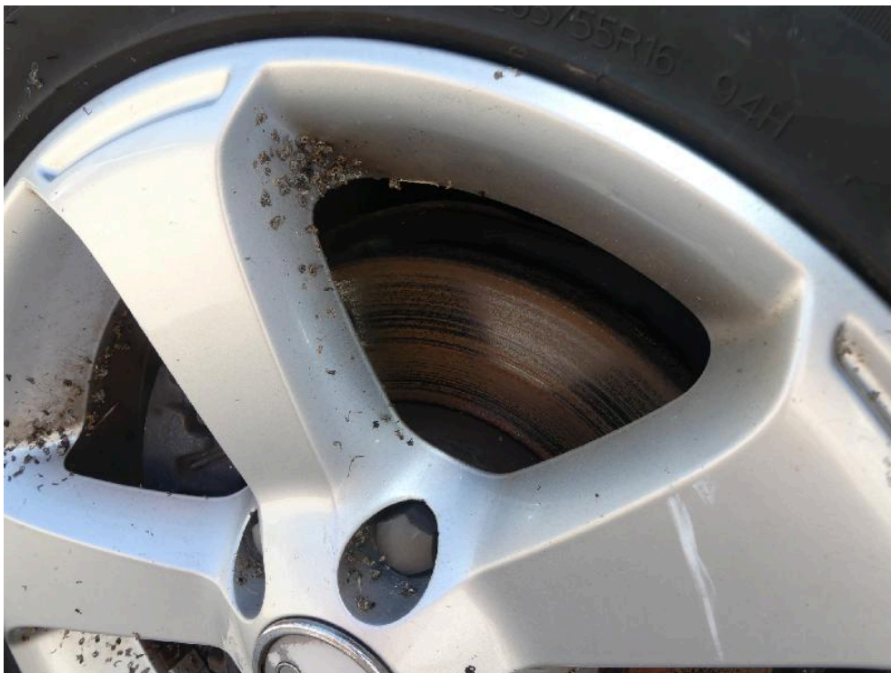
Bild: 34 Standschäden Bremsanlage
