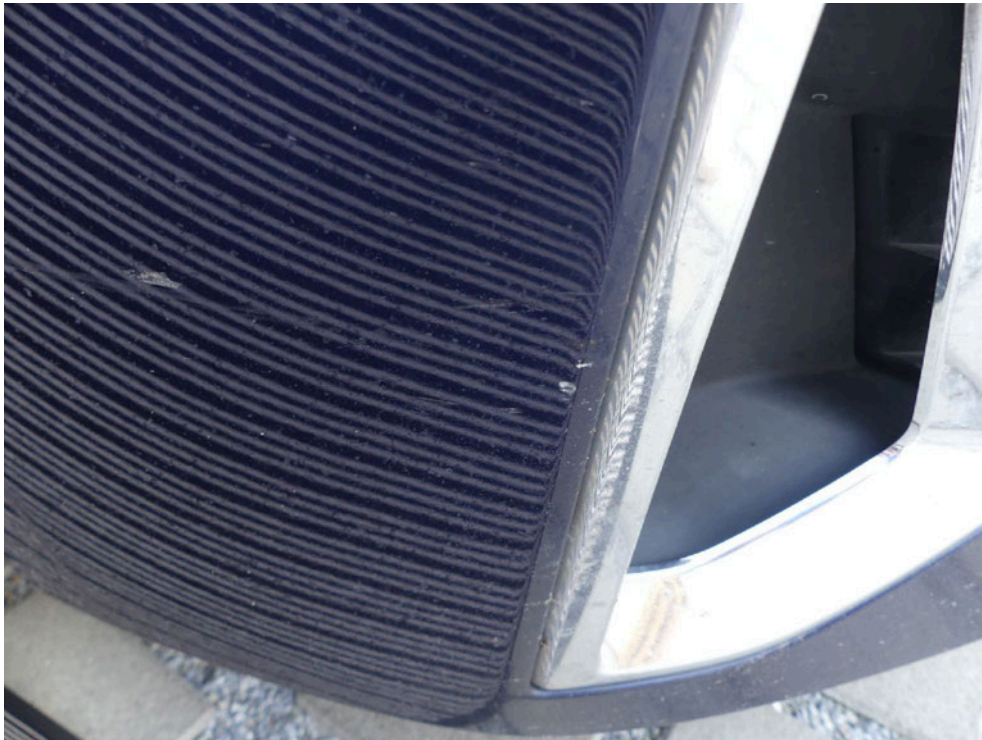
Bild: 66 Frontverkleidung rechts streifend beschädigt
