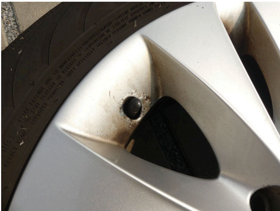
Bild: 61 LM-Felgen im Bereich Ventil beschädigt.
