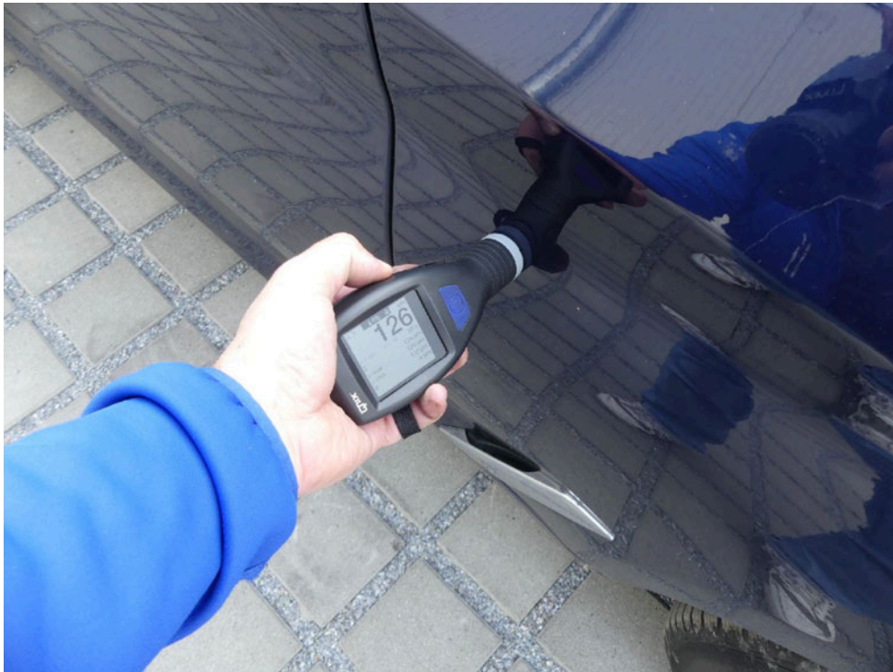
Bild: 52 Ausweisung Lackschichtdickenmessung vorgenommen, Messwerte dem beiliegenden Protokoll entnehmen.
