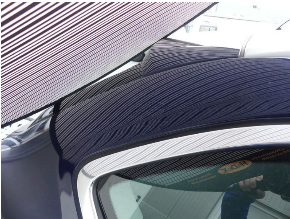
Bild: 73 Sachverständigeseits wurde ein Austausch der rechten Seitenwand festgestellt.
