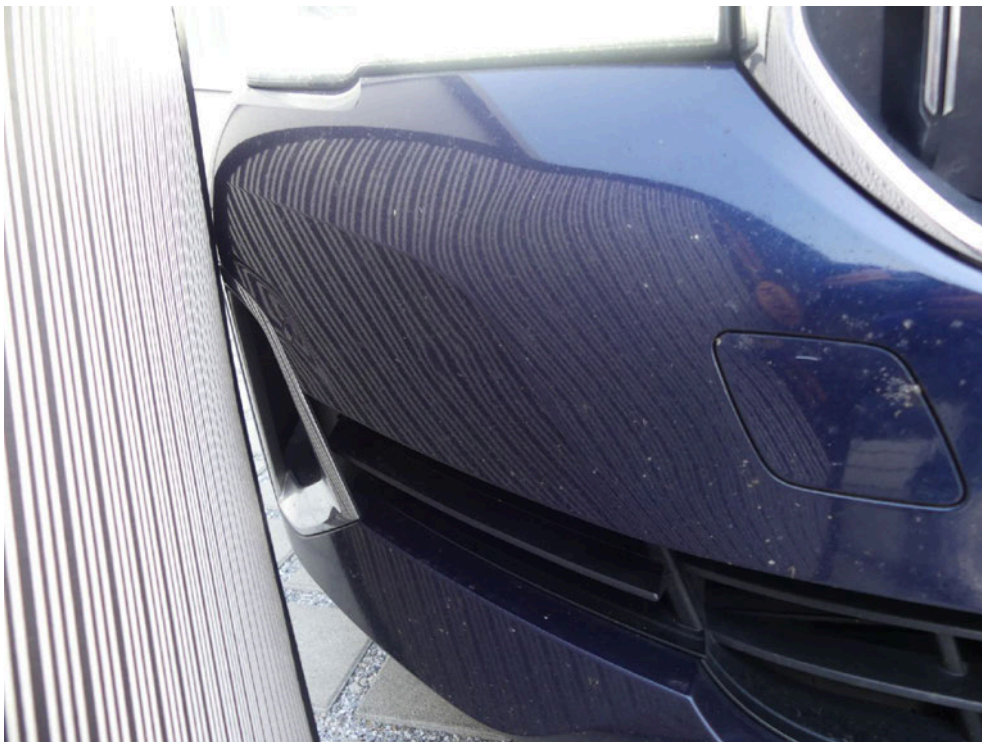
Bild: 67 Weiterführend ist das Grundmaterial der Frontverkleidung partiell gestaucht.
