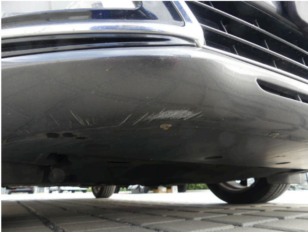
Bild: 45 ... der Lackaufbau ist partiell markiert/verkratzt.
