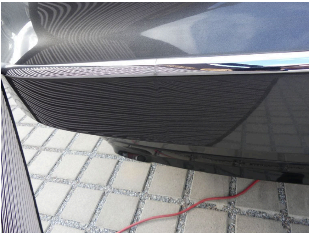
Bild: 52 Blende Heckklappe vertikal gestaucht, die Chromzierleiste ist sichtbar gebrochen.
