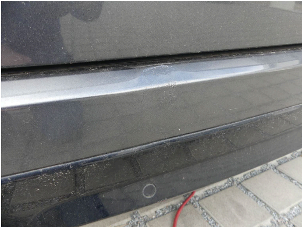
Bild: 47 ... diese ist im Grundmaterial bleibend deformiert.
