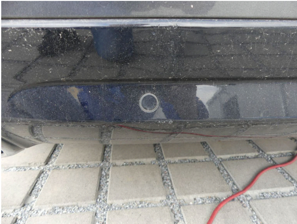
Bild: 49 ... zusätzlich ist der angrenzende unter Spoiler gestaucht.
