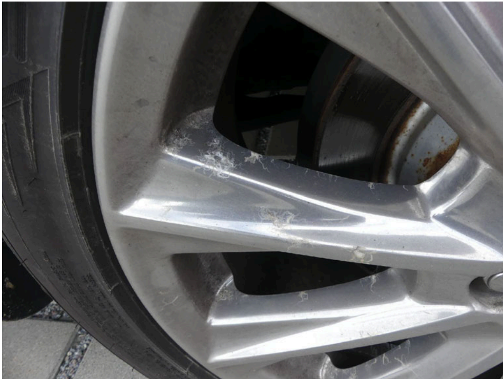
Bild: 35 Hierbei ist das selbige Schadenbild an der LM-Felge vorhanden.
