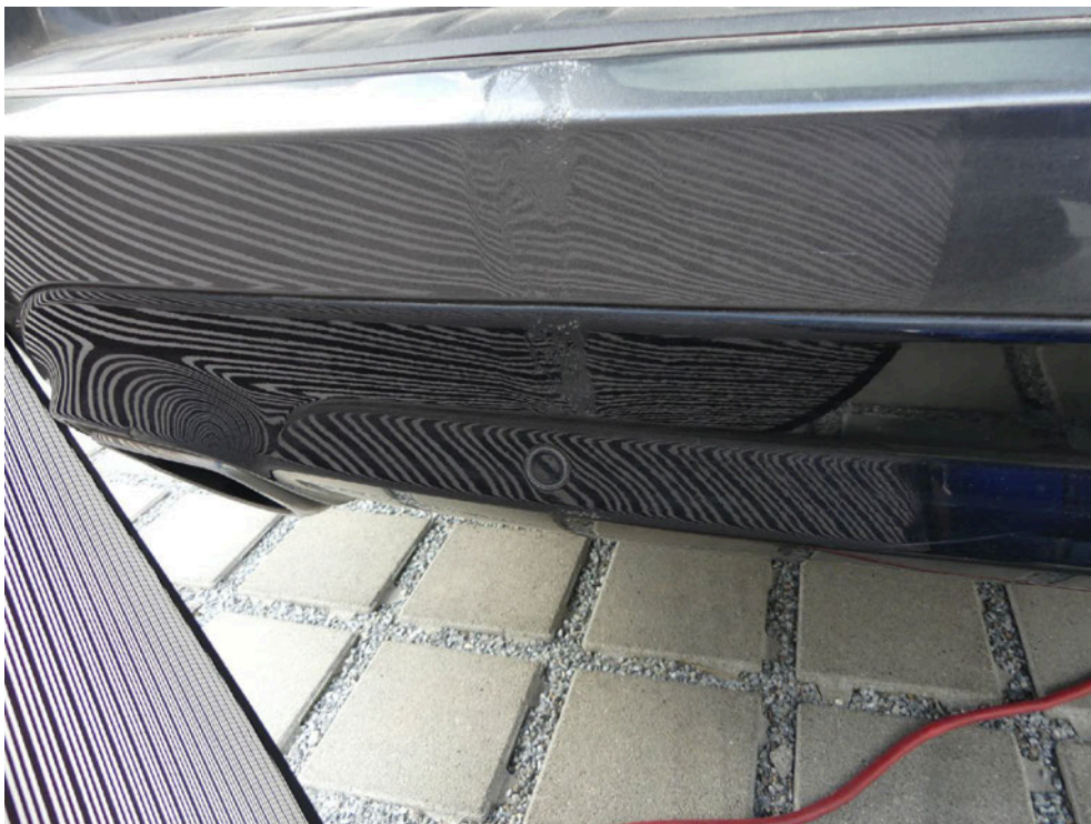
Bild: 50 Detaillierte Darstellung zur visuellen Verdeutlichung des Materialeinzuges mittels Liniensegels.
