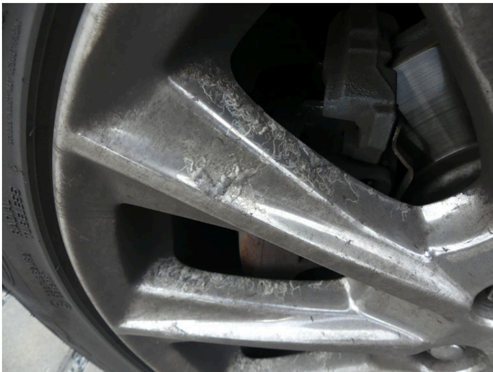
Bild: 32 Detailansicht LM-Felge vorn links, diese weist eine signifikante Oberflächenbeschädigung auf.
