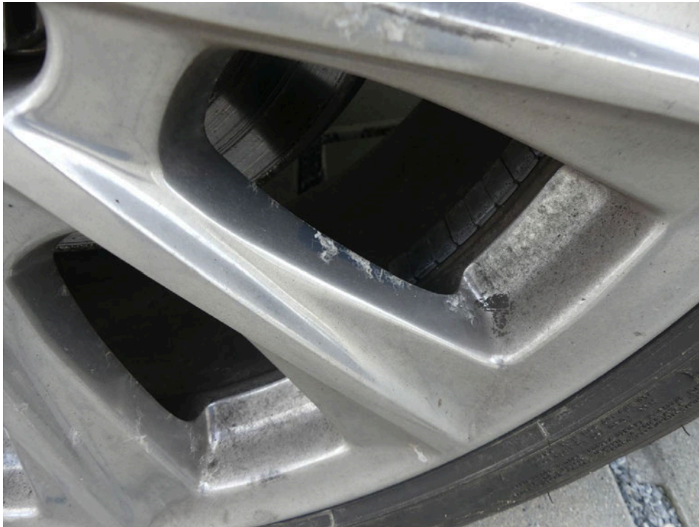
Bild: 39 LM-Felge hinten rechts ebenso in der Oberfläche beschädigt.
