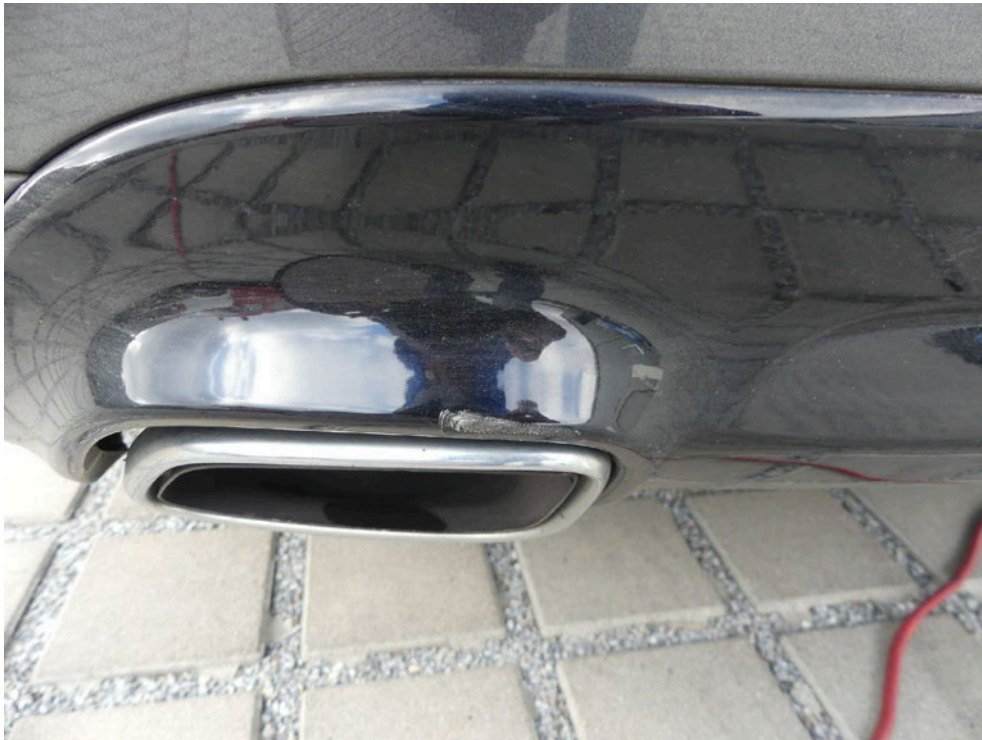
Bild: 51 Einzeldarstellung Spoileransatz, diese ist in Höhe Endrohr links beschädigt.
