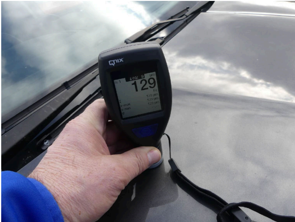
Bild: 63 Ausweisung Lackschichtdickenmessung vorgenommen, Messwerte dem beiliegenden Protokoll entnehmen.
