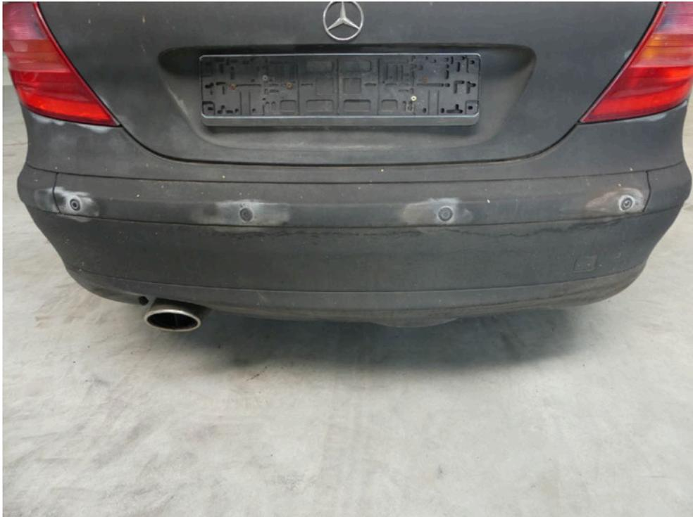
Bild: 45 Detailansicht Heckverkleidung mit PDC-Sensoren.
