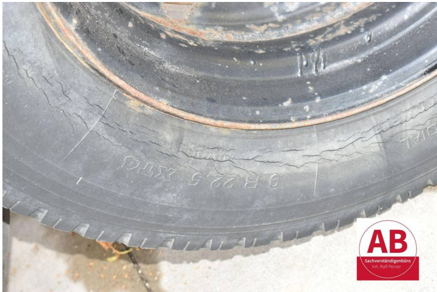
alle Reifen überaltert und mit starker Reißbildung (Darstellung exemplarisch)
