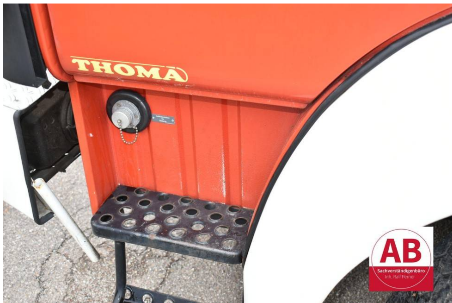
Einstieg Fahrerseite abgeschliffen
