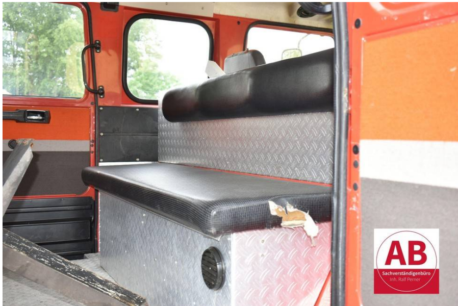
Ansicht Mitfahrerbereich hinten, Sitzbank aufgerissen
