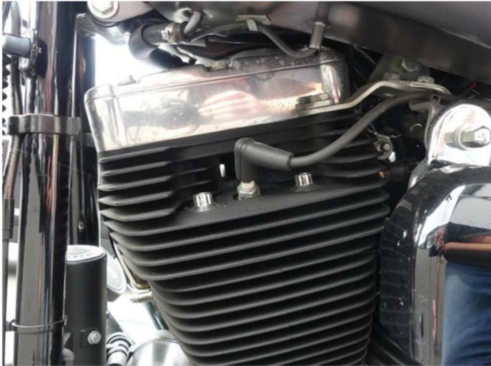
**Bild 13:** vorderer Zylinder
