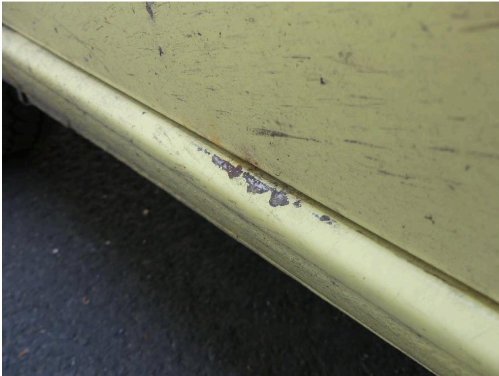
Bild: 61 Einstiegsschweller links - Lackaufbau abgetragen
