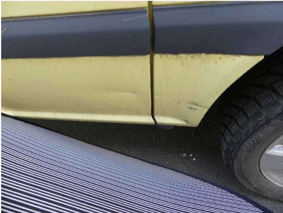
Bild: 63 Schiebetür unterhalb sowie Seitenwand rechts streifend gestaut.
