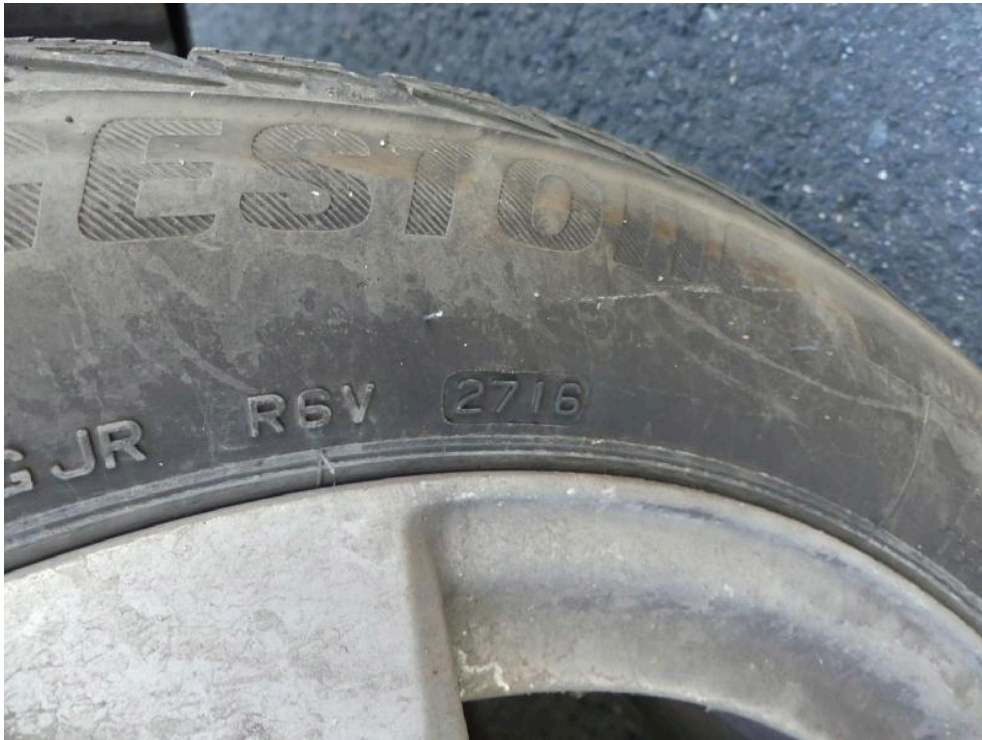
Bild: 45 Ausweisung der DOT Nummer der Radialreifen
