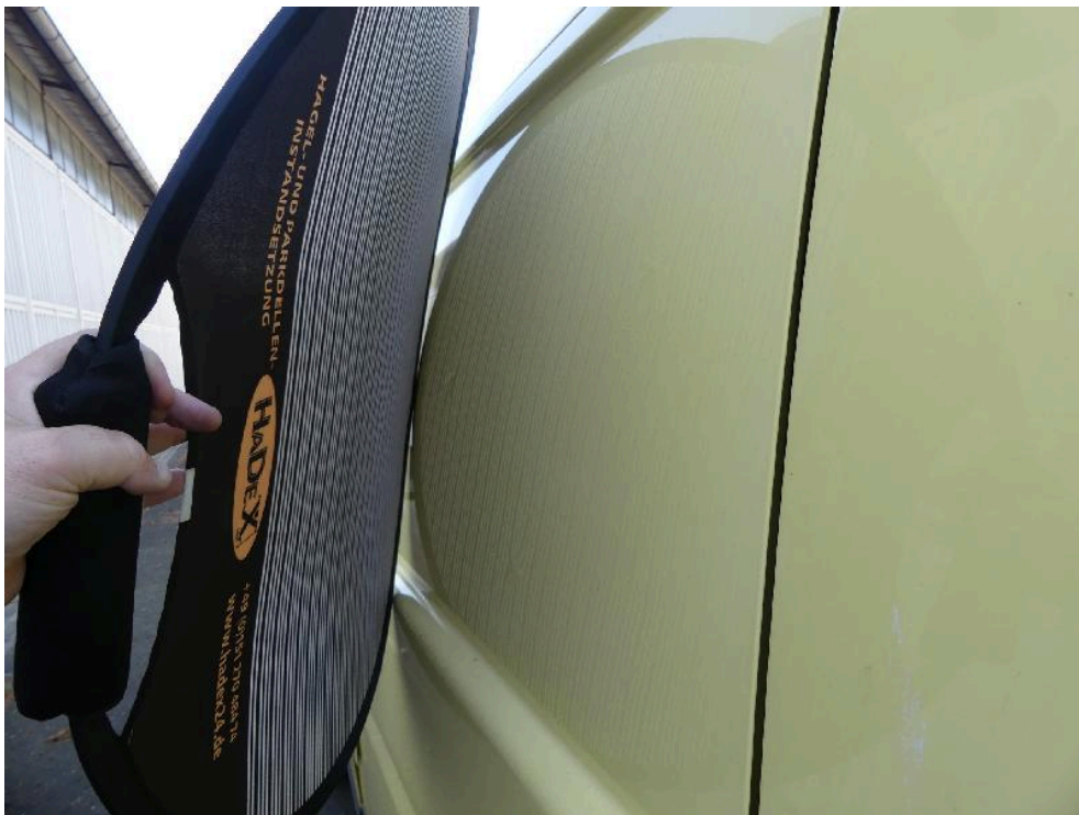
Bild: 62 Schiebetür links mehrfach deformiert.
