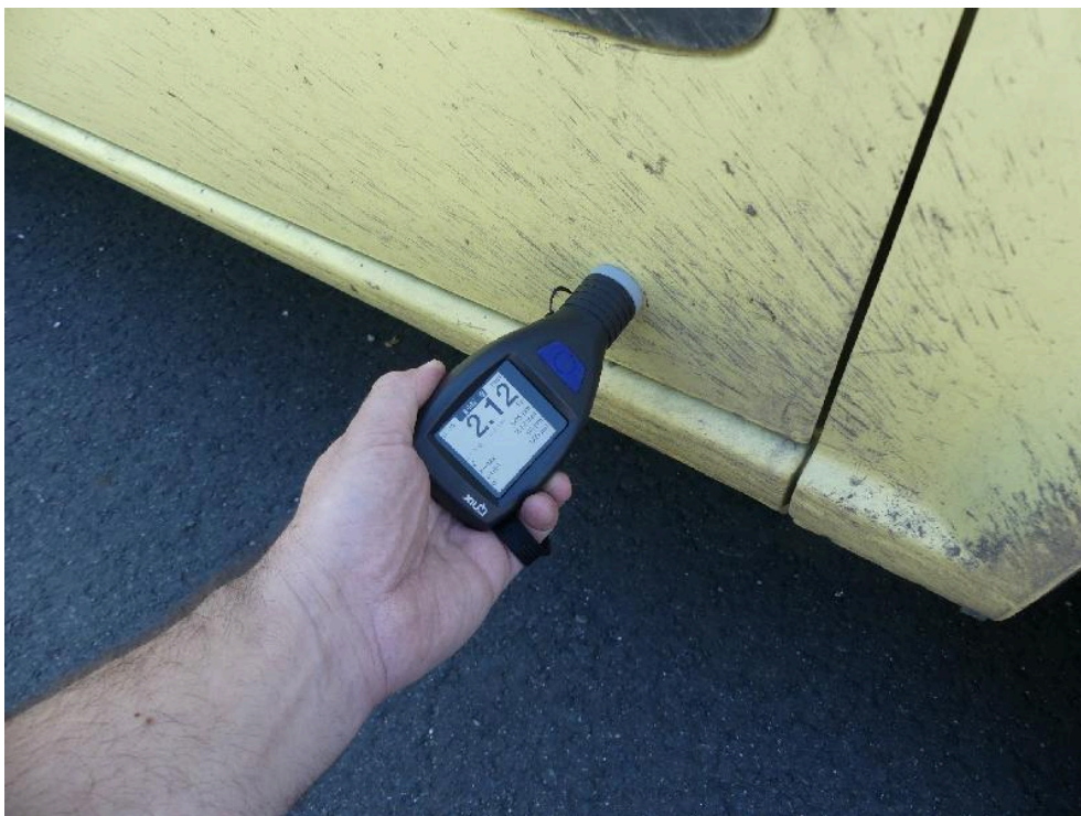
Bild: 56 Explizite Ausweisung Lackschichtdickenmessung Beifahrertür unterhalb der Zierleiste.
