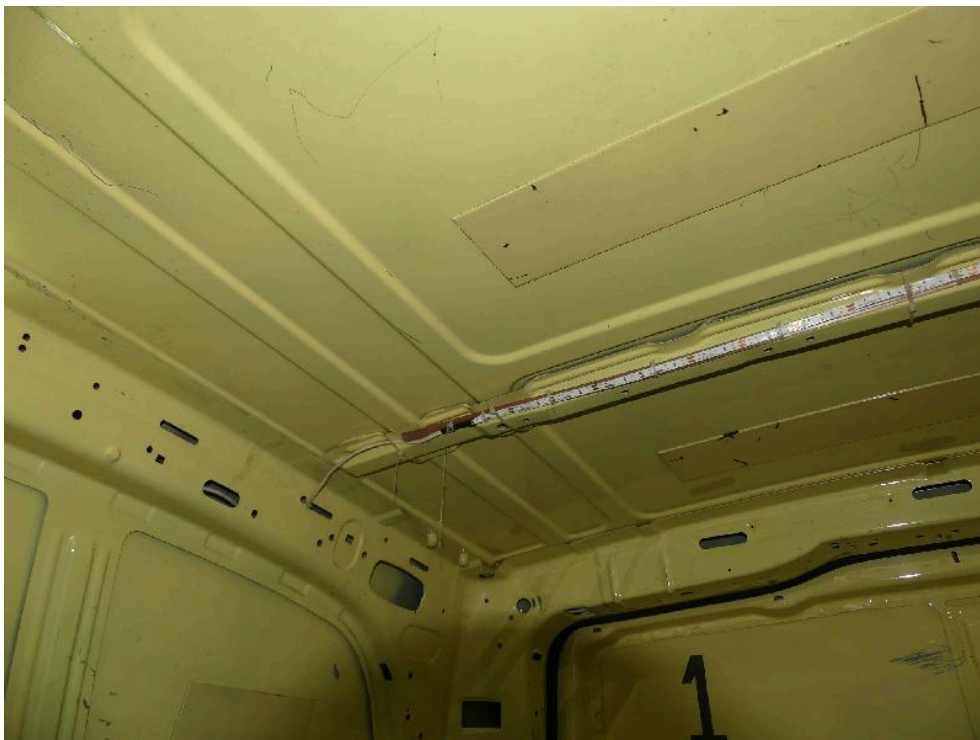
Bild: 28 3. LED-Stripe ohne Funktion
