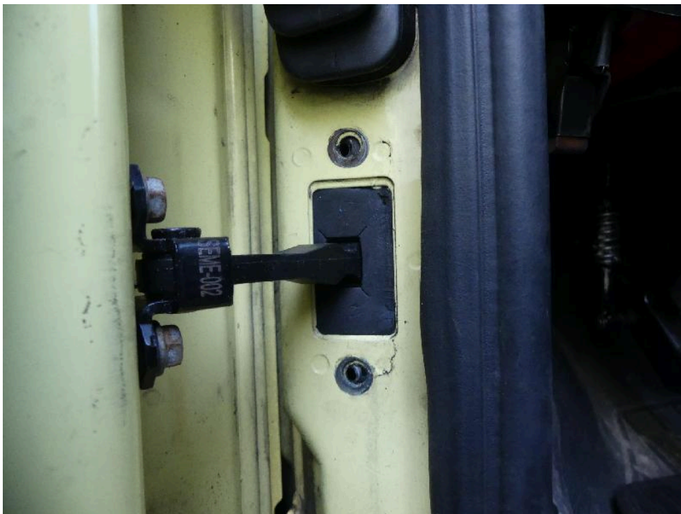
Bild: 18 Türfangband Fahrertür ohne Befestigung / A-Säule partiell gerissen.
