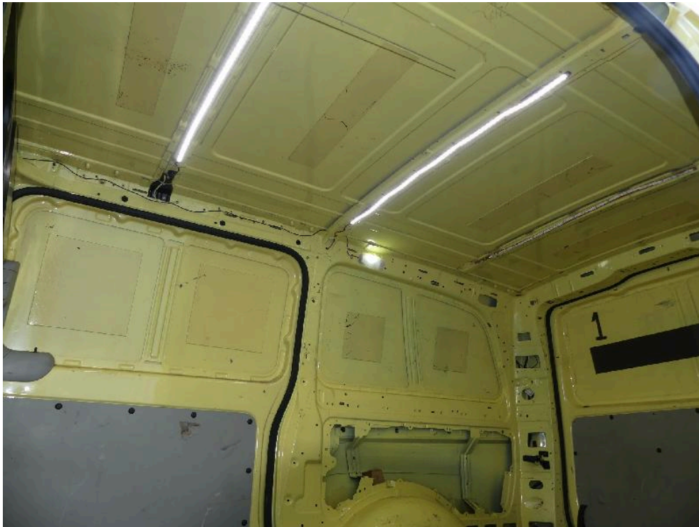
Bild: 23 LED-Stripes im Laderaum nachgerüstet
