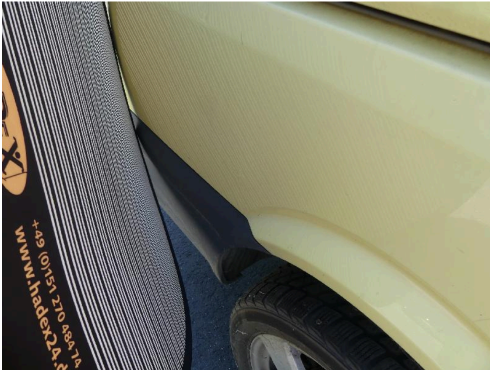
Bild: 67 Seitenwand rechts mehrfach deformiert.
