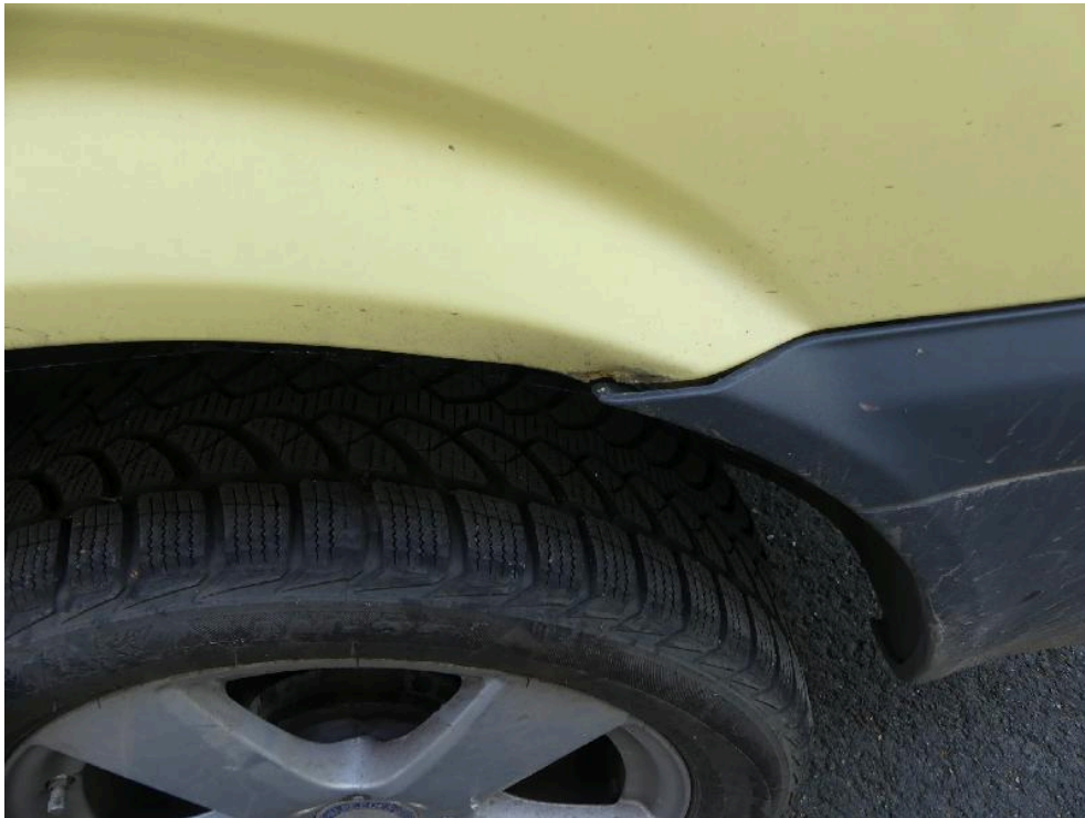
Bild: 65 Ansicht Seitenwand, diese ist im Übergang zur Heckverkleidung gestaucht.
