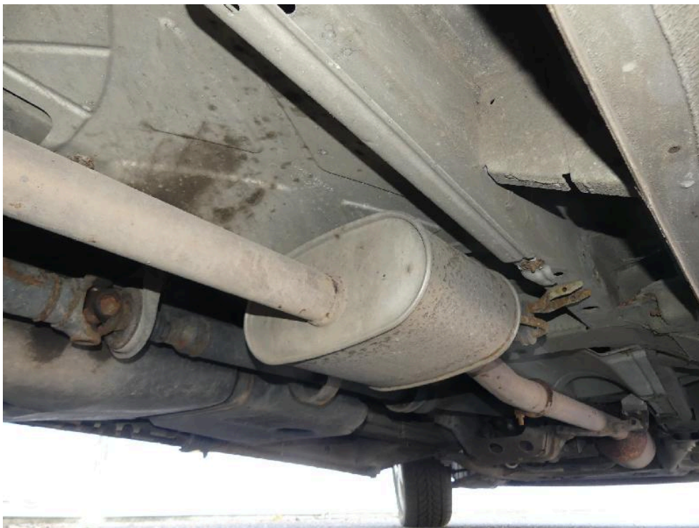
Bild: 54 Detailansicht Abgasanlage
