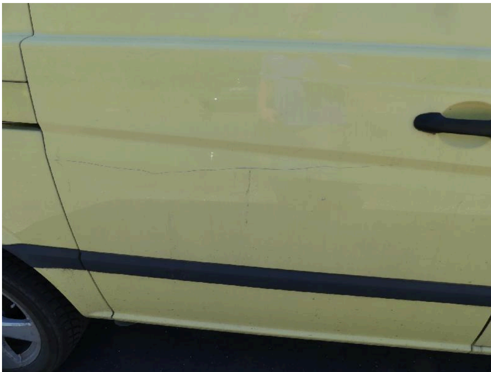
Bild: 68 Ansicht Schiebtür rechts, diese ist horizontal streifend im Lackaufbau abgetragen.
