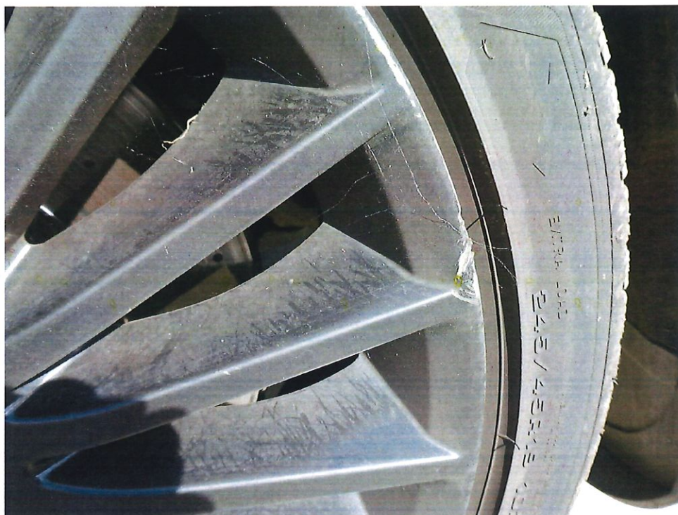
Bild 7 : LM-Felge vo. rechts beschädigt , Substartverlust am Felgenhorn
