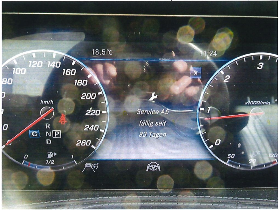
Bild 5 : Wartungsnachweis Service A 5 lt. dynamischer Anzeige fällig
