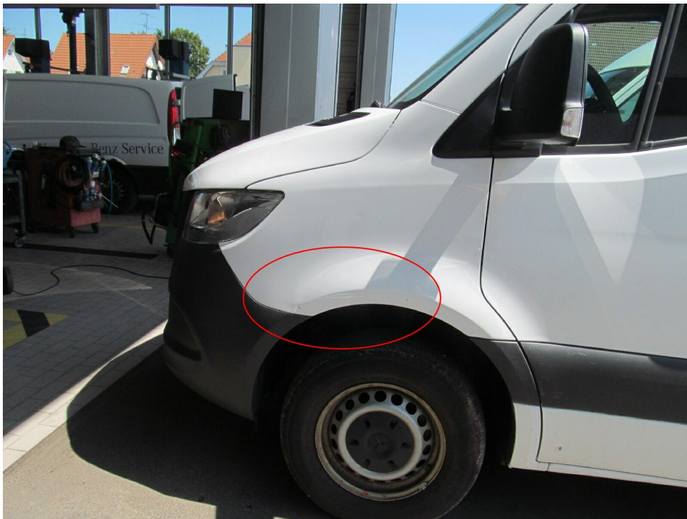
Bild 12 : Kotflügel links eingedellt
