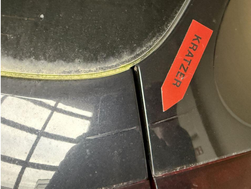
Foto 35: Schaden: Heckklappe und Seitenwand hinten links Lackierung beschädigt/Kratzer
