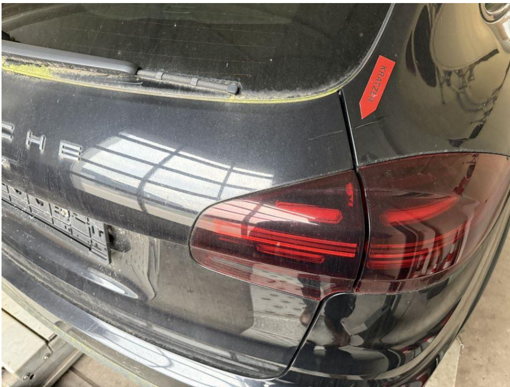
Foto 34: Schaden: Heckklappe und Seitenwand hinten links Lackierung beschädigt/Kratzer
