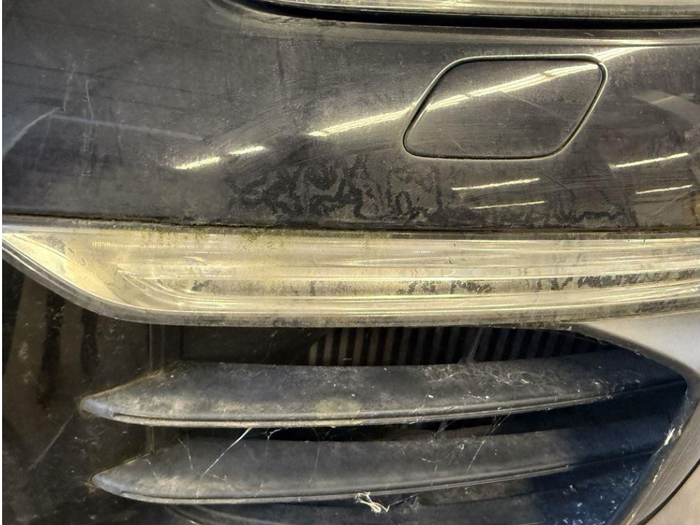
Foto 17: Schaden: Fahrzeug verwittert
