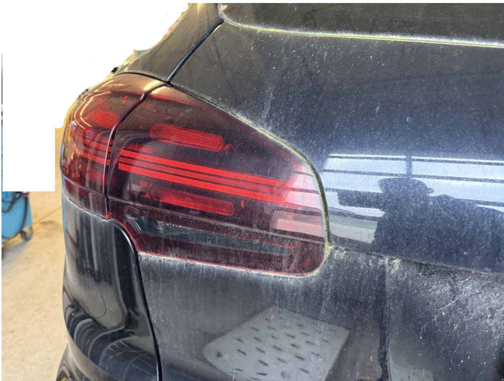
Foto 20: Schaden: Fahrzeug verwittert
