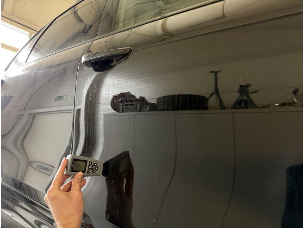
Foto 13: Tür vorne rechts: erhöhte Lackschichtdicke
