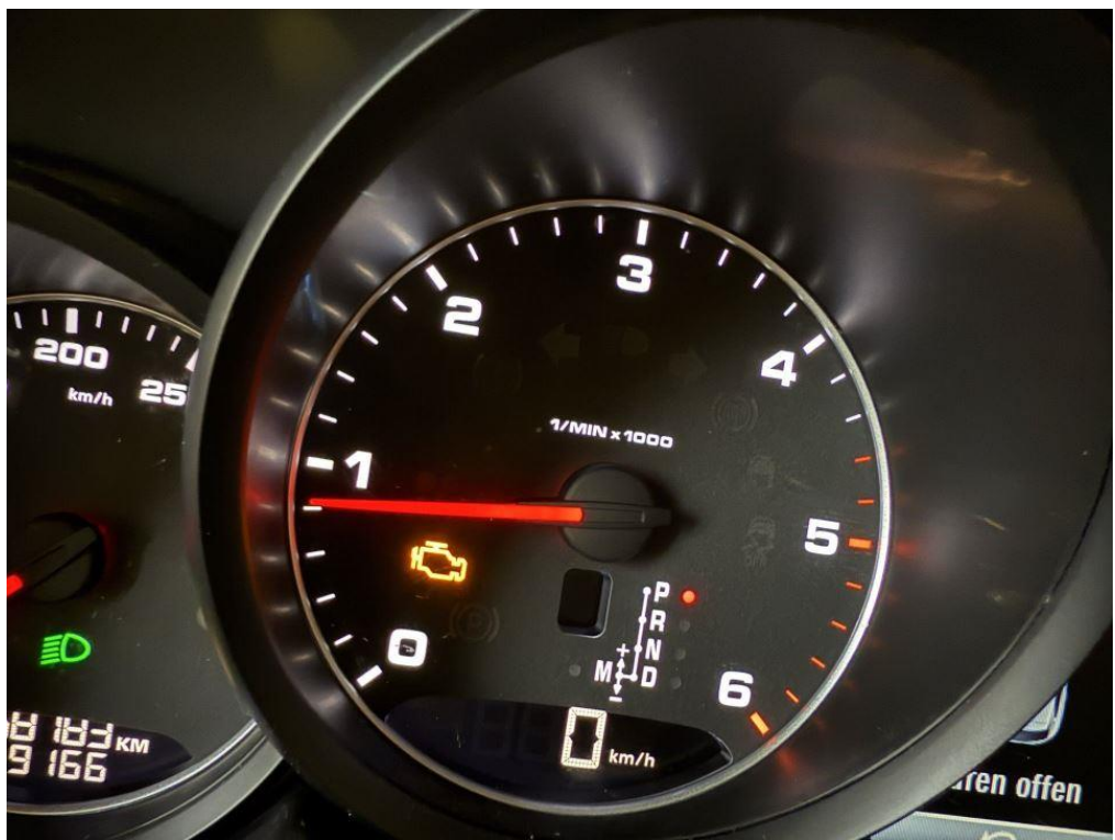
Foto 44: Schaden: Motorkontrollleuchte leuchtet
