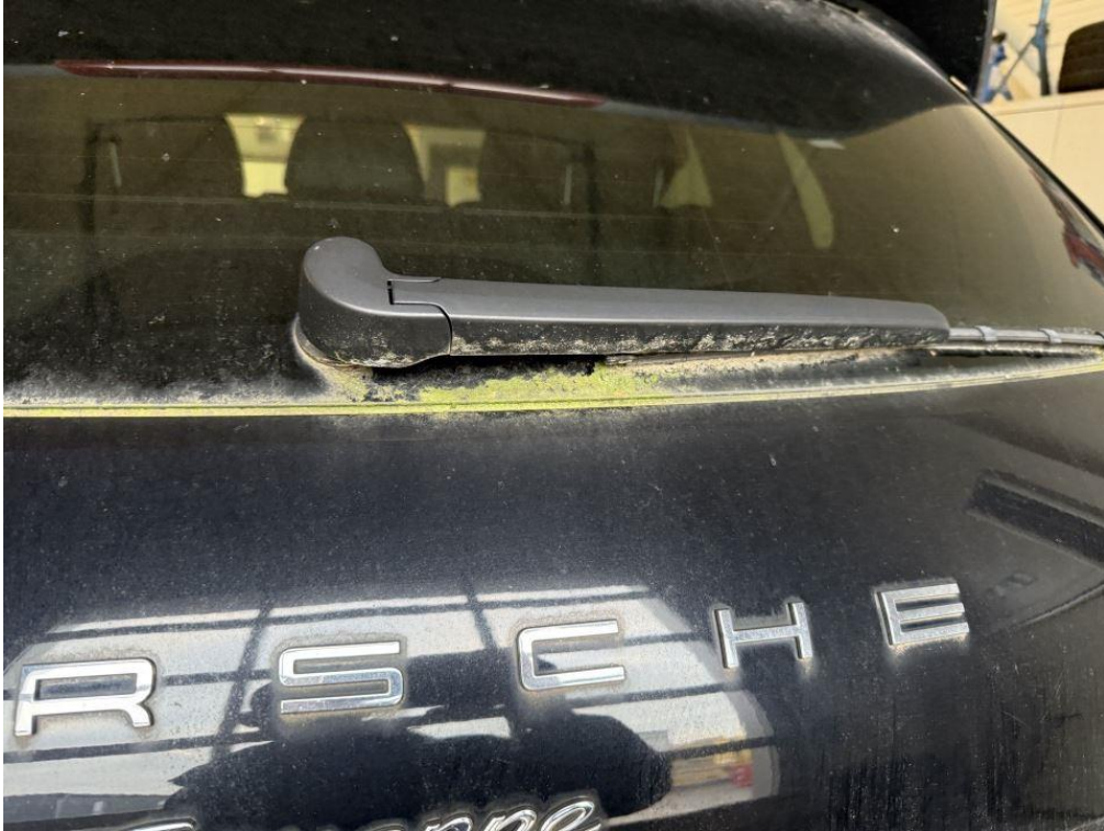
Foto 19: Schaden: Fahrzeug verwittert
