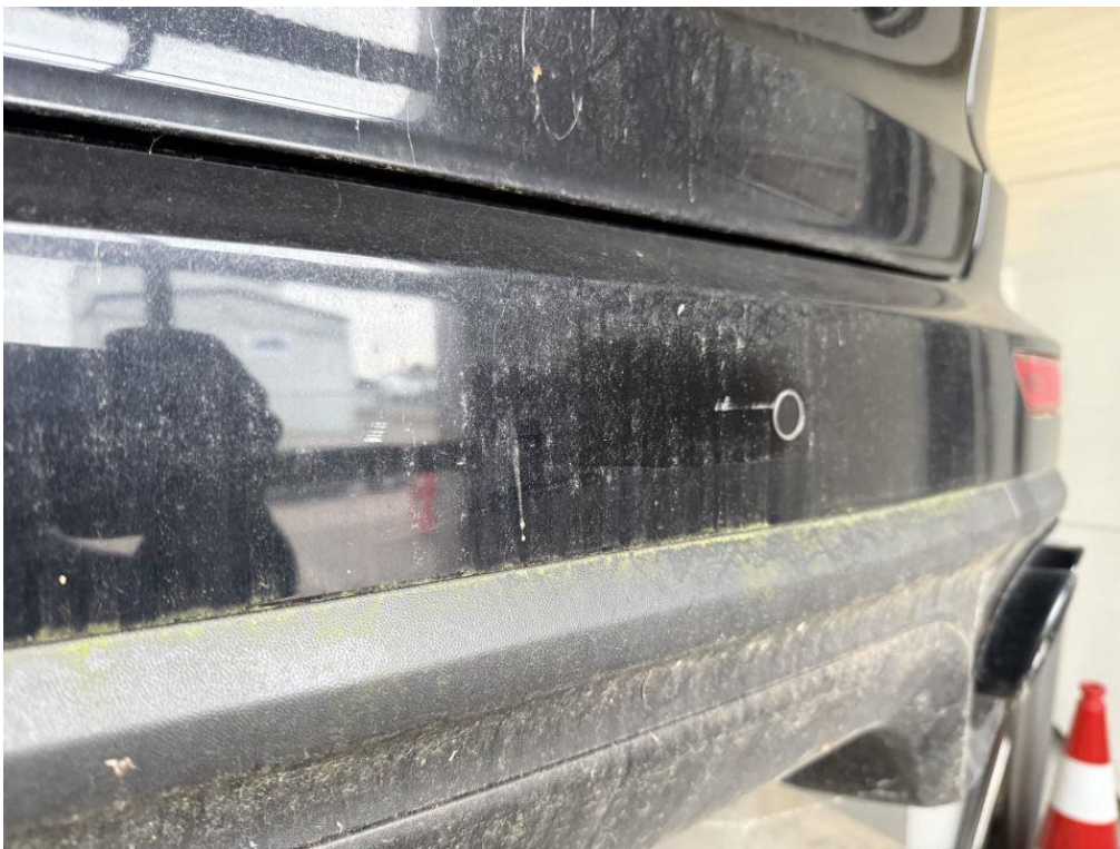
Foto 36: Schaden: Stoßfängerverkleidung hinten Lackierung beschädigt und eingedellt
