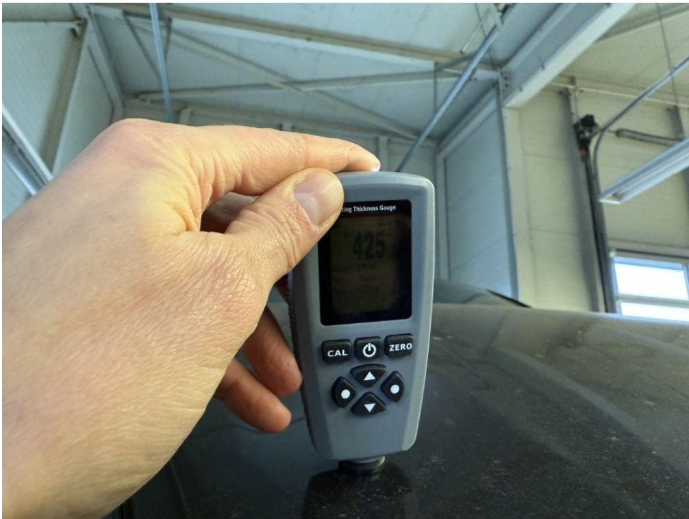
Foto 14: Motorhaube: erhöhte Lackschichtdicke
