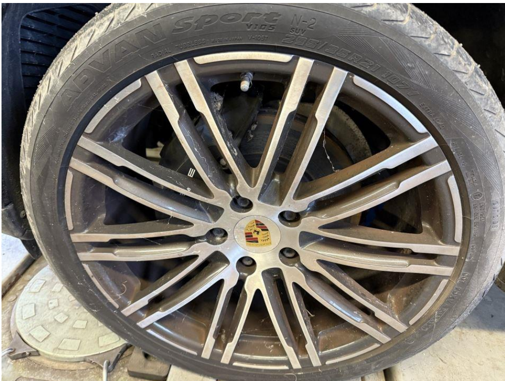
Foto 42: Schaden: Bremsscheiben Vorderachse stark korrodiert
