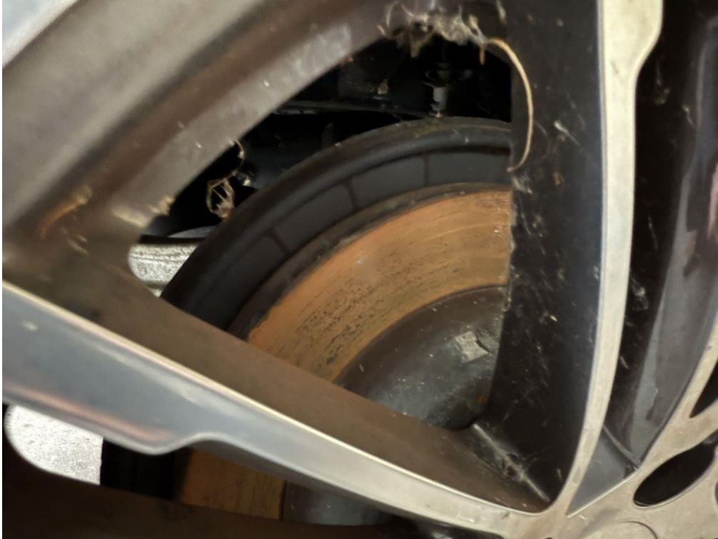
Foto 41: Schaden: Bremsscheiben Hinterachse stark korrodiert
