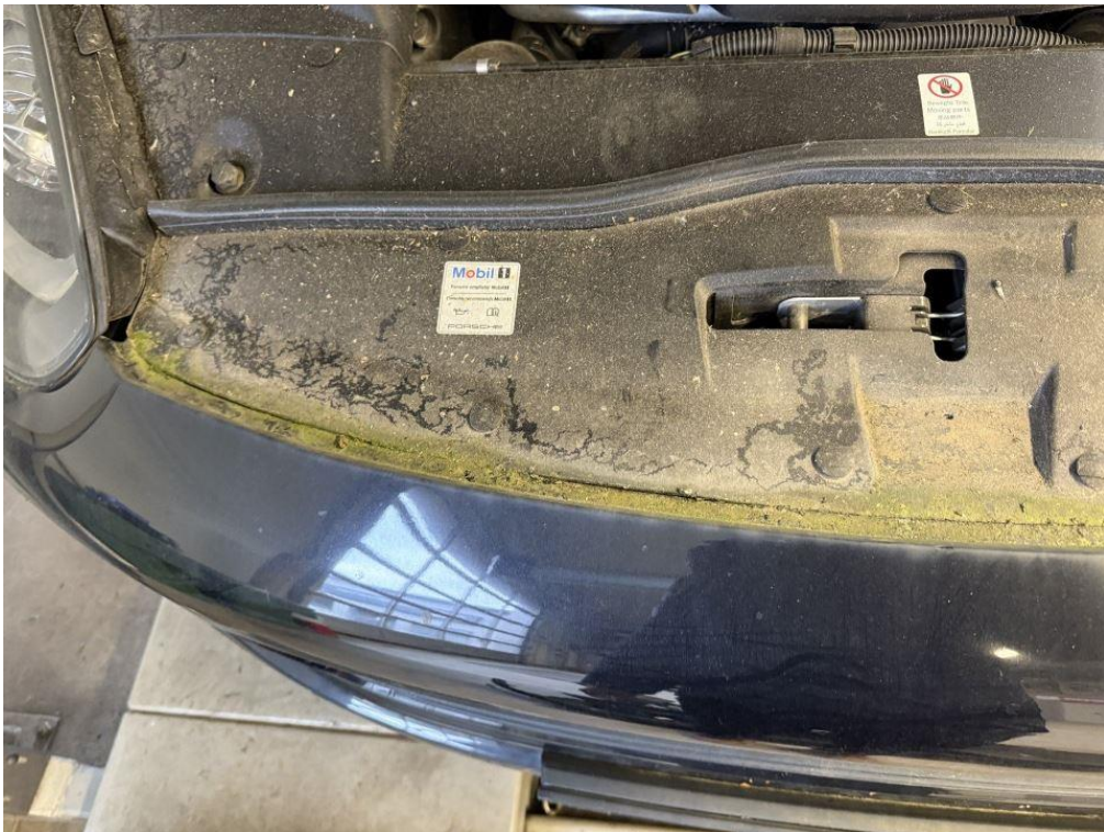
Foto 16: Schaden: Fahrzeug verwittert
