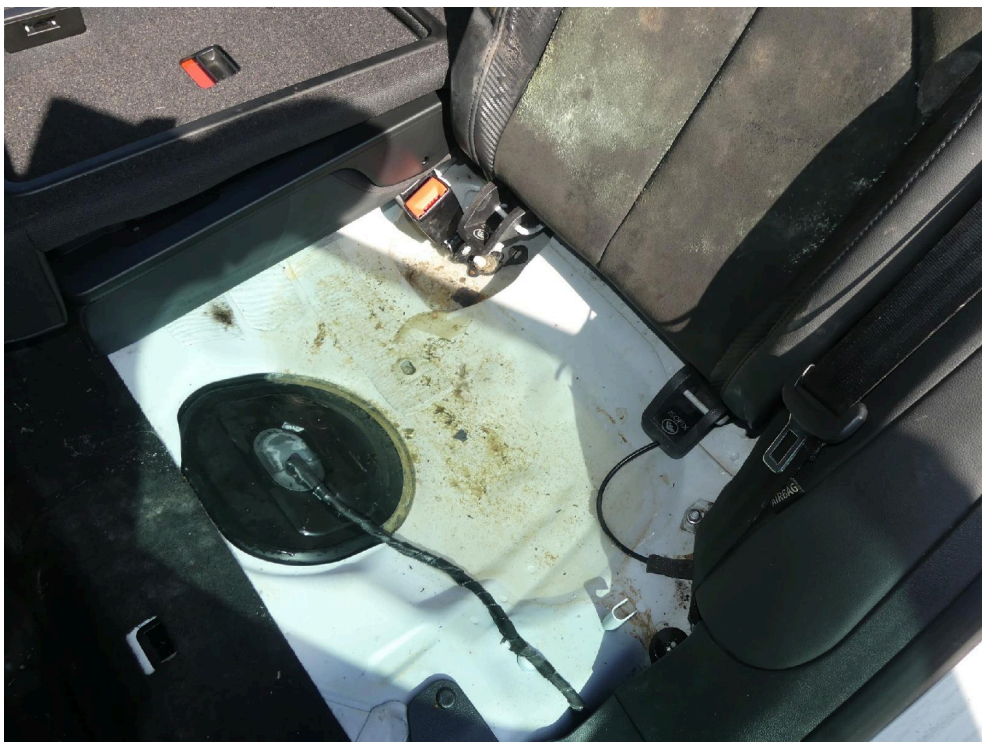
Bild: 26 Wassereintritt im Fondbereich ....
