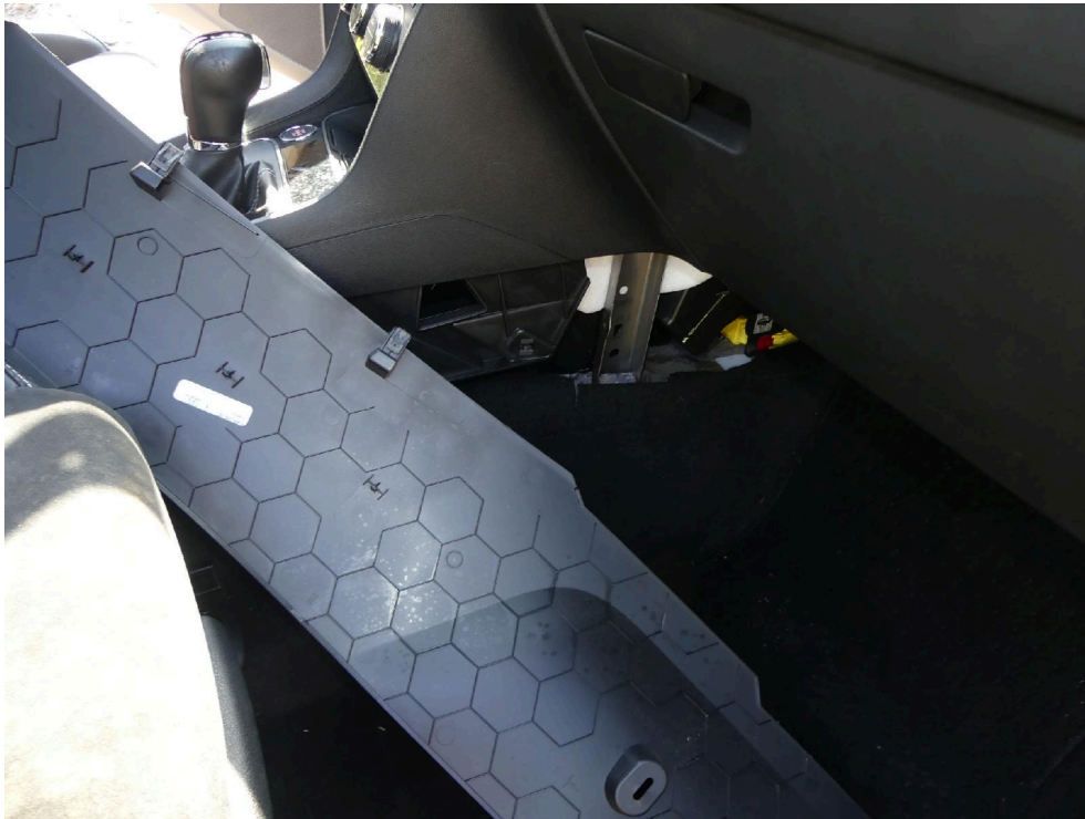
Bild: 35 Die seitliche Verkleidung Mittelkonsole ist demontiert.
