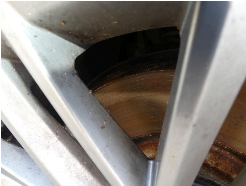
Bild: 48 Standschäden Bremsanlage
