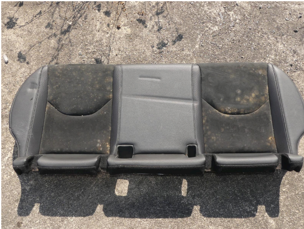
Bild: 24 Übersichtsaufnahme Rücksitzbank mit Schimmelspuren.
