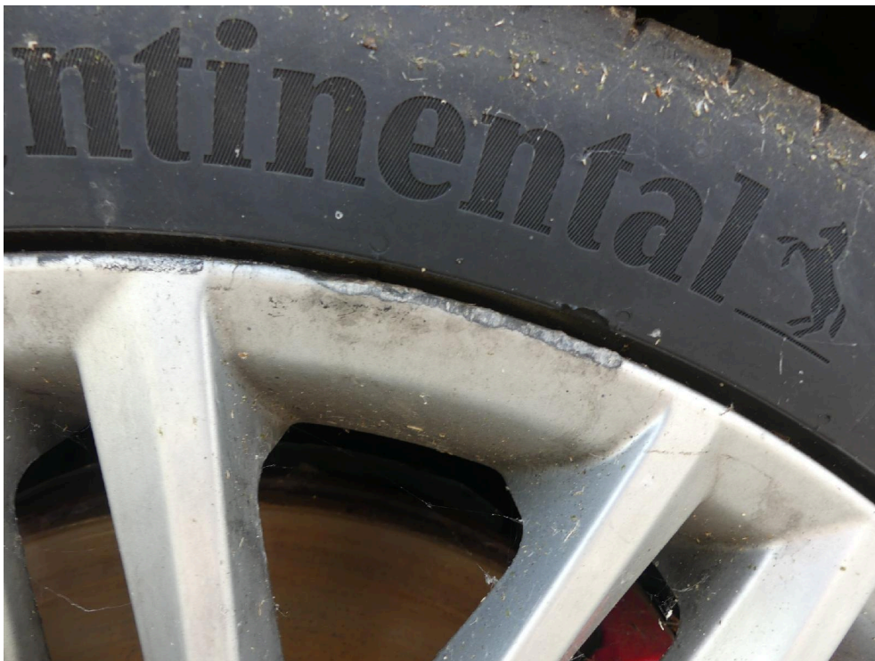
Bild: 44 LM-Felge vorn rechts beschädigt.
