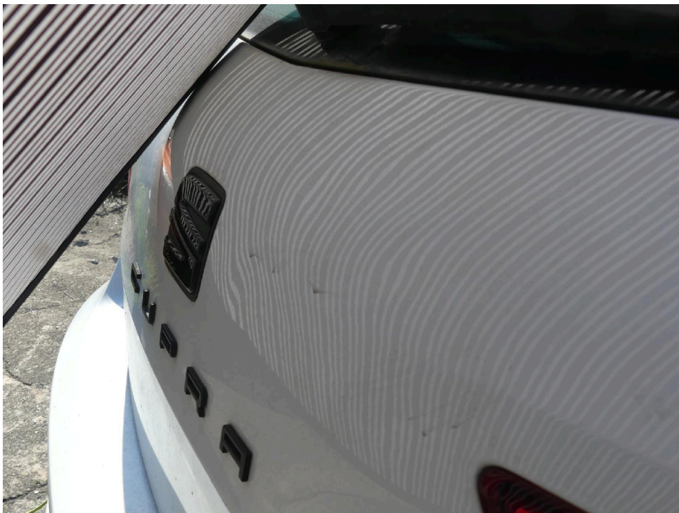
Bild: 52 Heckklappe partiell gestaut.
