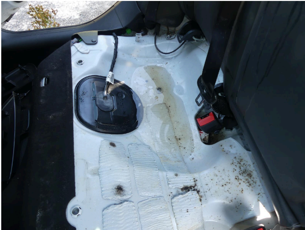
Bild: 27 ... im Bereich Fondsitzbank ist Wasser vorhanden.
