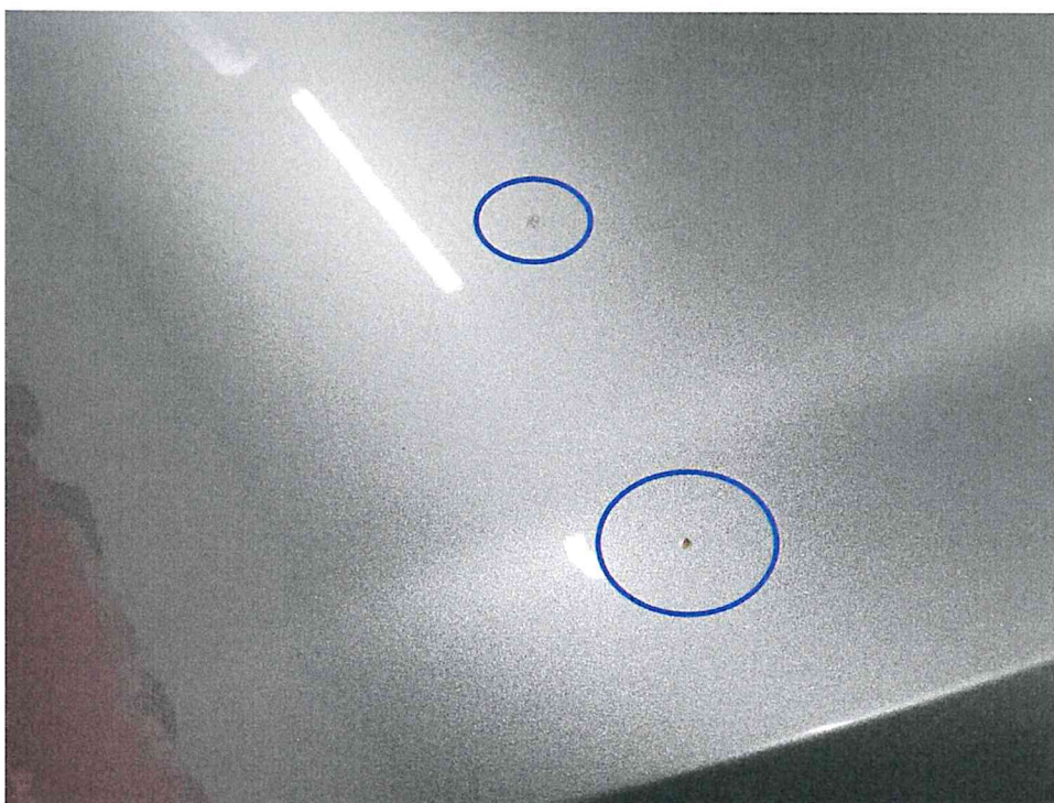
Bild 20 : Motorhaube, mehrfach eingedellt, instandsetzen und lackieren mit Lackaufbau
