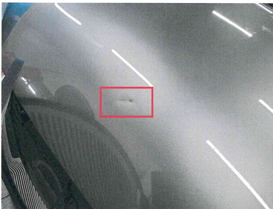
Bild 19 : Motorhaube, mehrfach eingedellt, instandsetzen und lackieren mit Lackaufbau
