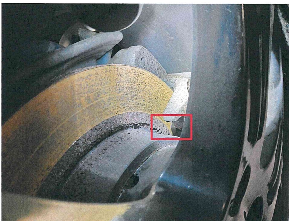
Bild 22 : Bremsbeläge hinten verschlissen u. Bremsscheiben korrodiert
