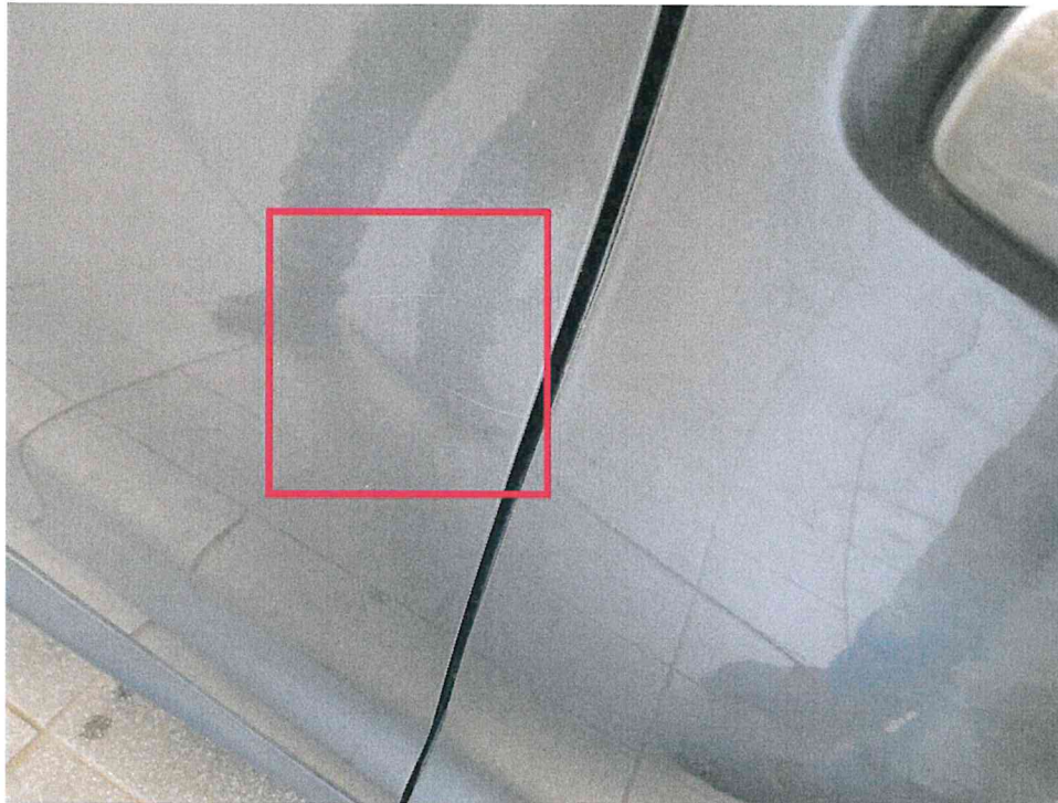
Bild 17 : Tür HR leicht verschrammt
