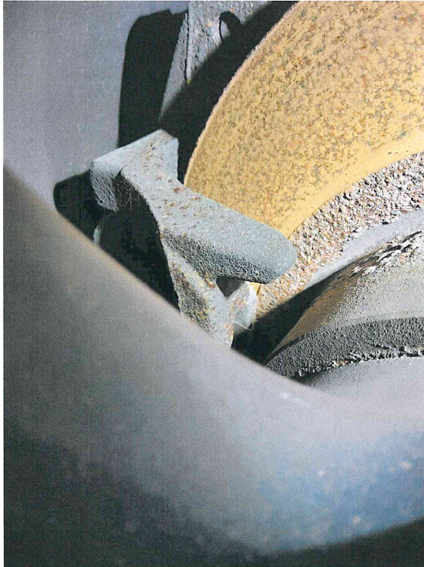
Bild 23 : Bremsbeläge hinten verschlissen u. Bremsscheiben korrodiert
