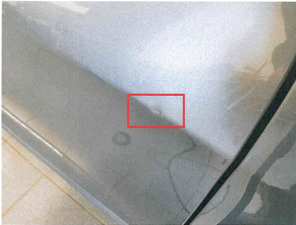
Bild 15 : Tür vorne rechts, mehrfach eingedellt, instandsetzen und lackieren mit Lackaufbau
