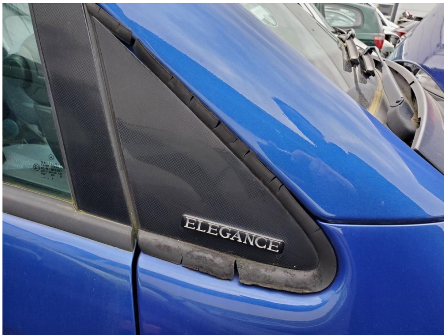
Schadenbereich : Dichtung Blende Kotflügel rechts eingerissen
