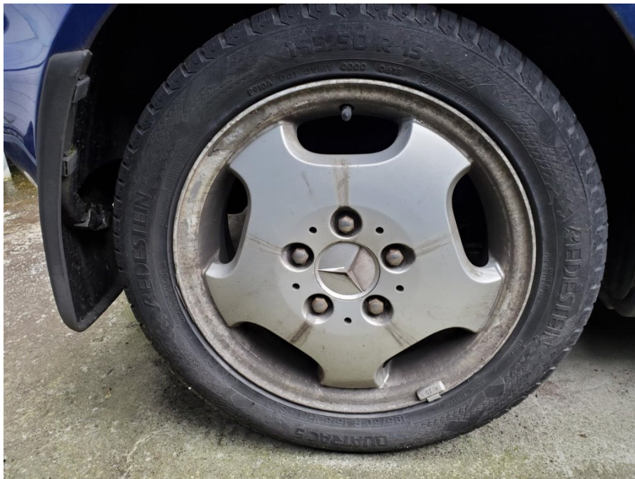
Schadenbereich: LM-Felge hinten rechts -Lackabplatzungen/ Reifen Ausbrüche im Flankenbereich
