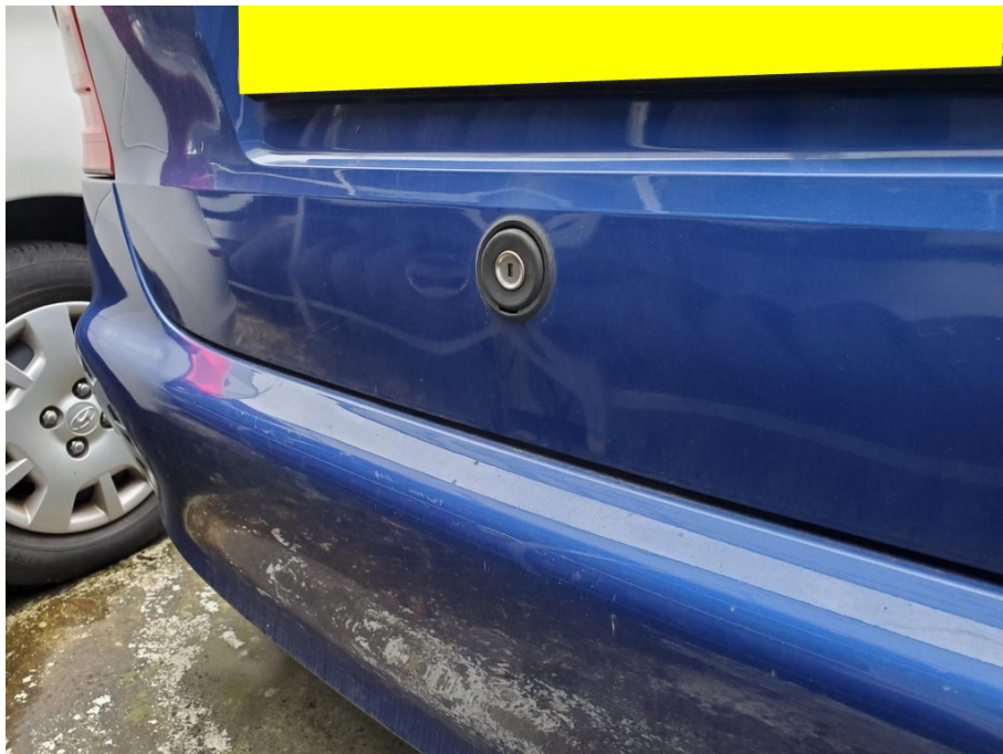
Schadenbereich: Heckklappe - Verformungen im Schließzylinderbereich
