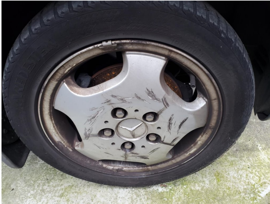
Schadenbereich: LM-Felge vorne rechts verschürt/ Reifen vorne rechts Ausbrüche im Flankenbereich
