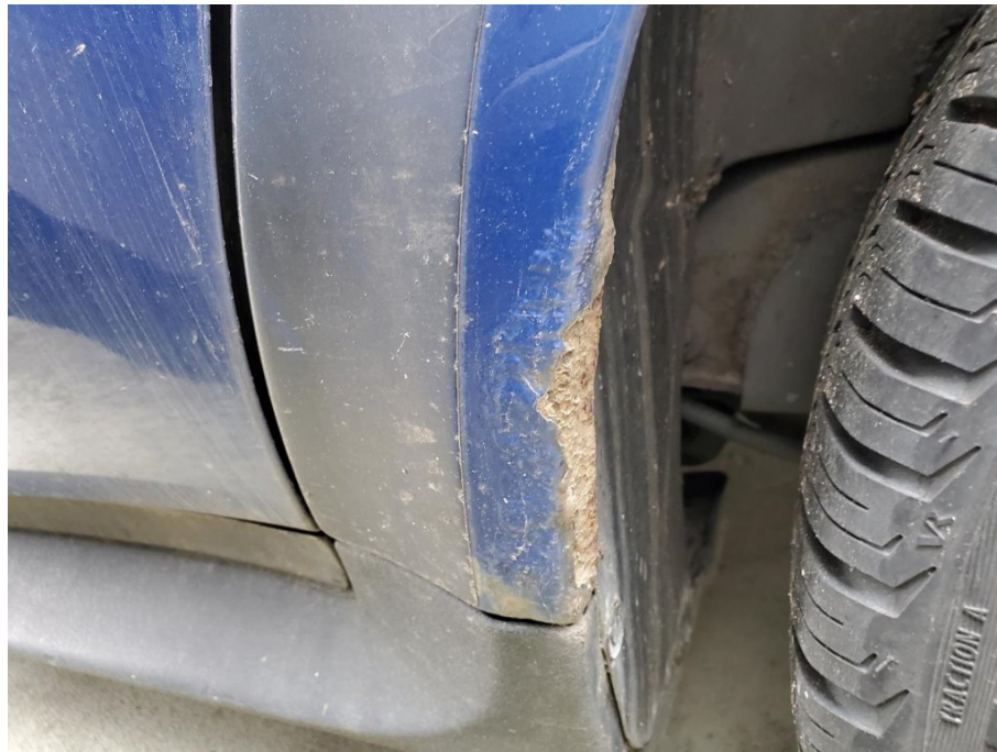
Schadenbereich: Seitenwand links Anrostungen
