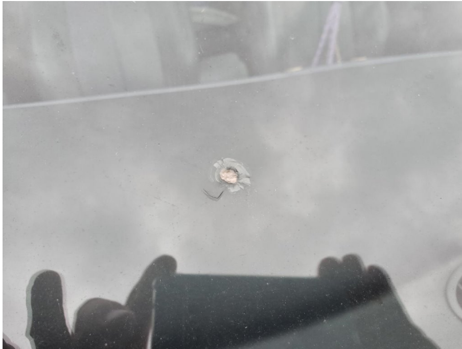
Schadenbereich : Steinschlag Frontscheibe im Bereich Beifahrerseite
