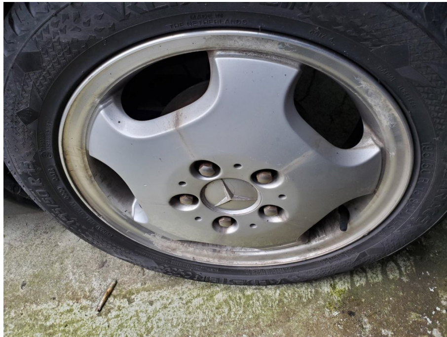
Schadenbereich: LM-Felge hinten links Abplatzungen
