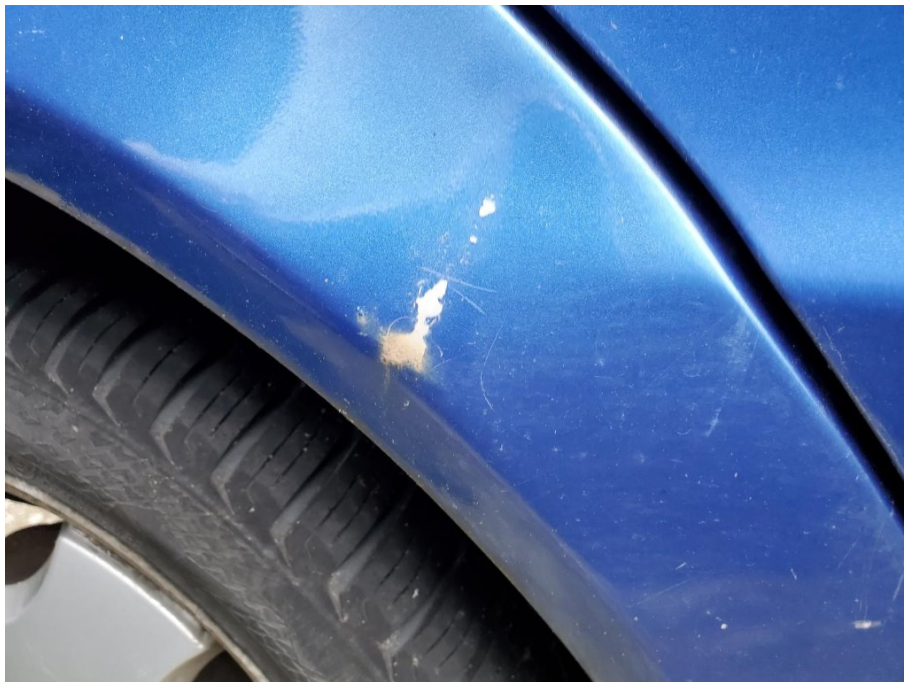
Schadenbereich: Seitenwand rechts - Lackbeschädigungen
