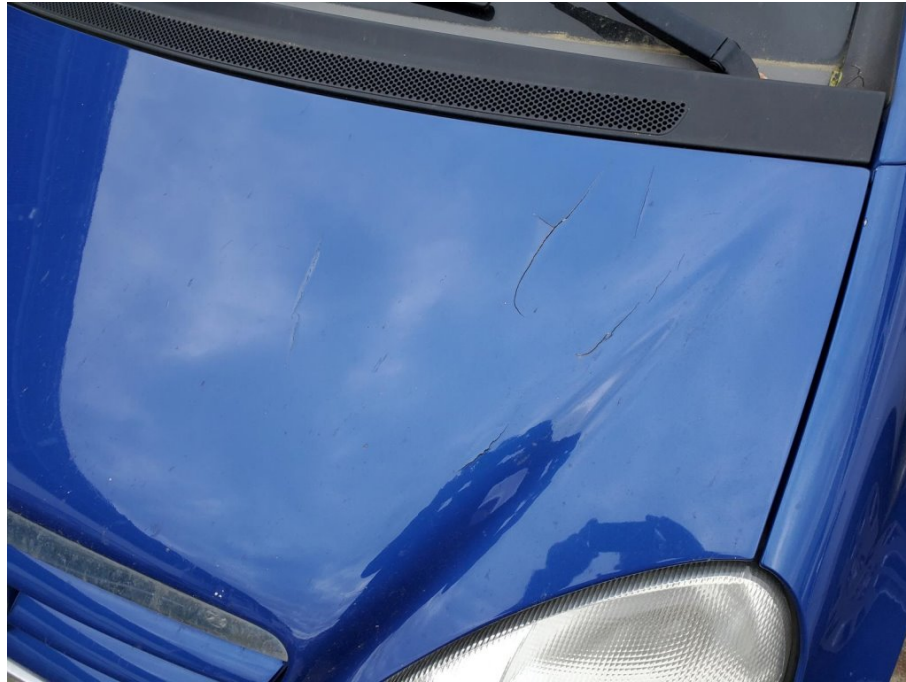
Schadenbereich : Lackabplatzungen und Risse im Bereich der Motorhaube
