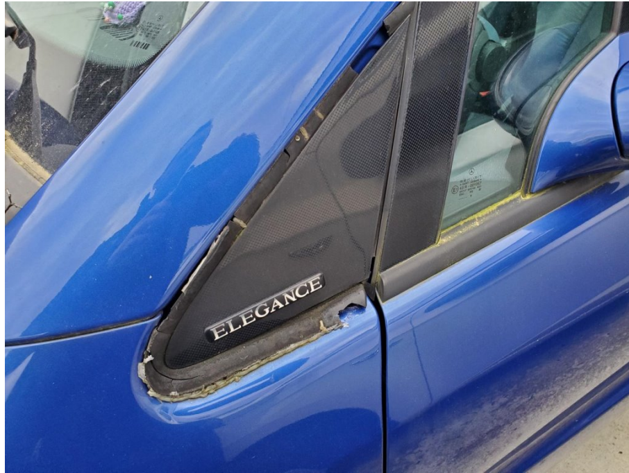
Schadenbereich: Dichtung Blende Kotflügel links- eingerissen
