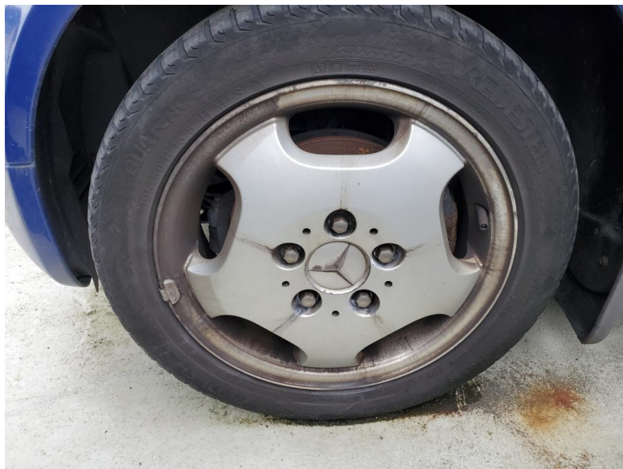
Schadenbereich : LM-Felge vorne links - Lackabplatzungen / Reifen Ausbrüche im Flankenbereich
