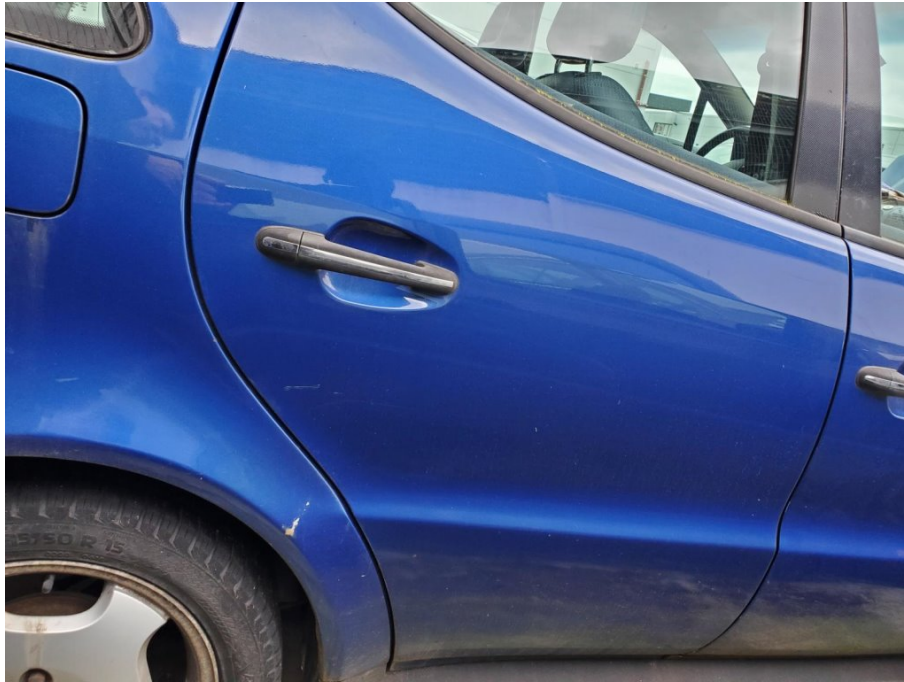
Schadenbereich: Tür hinten rechts- Lackbeschädigungen
