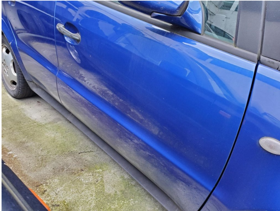
Schadenbereich: Lackbeschädigungen im Türbereich vorne rechts
