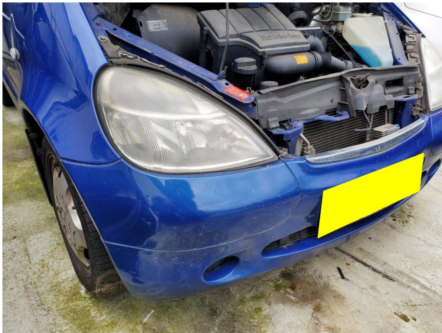
Schadenbereich: Hauptscheinwerfer rechts lose / Halterungen gebrochen/ Stoßfängerverkleidung verformt
