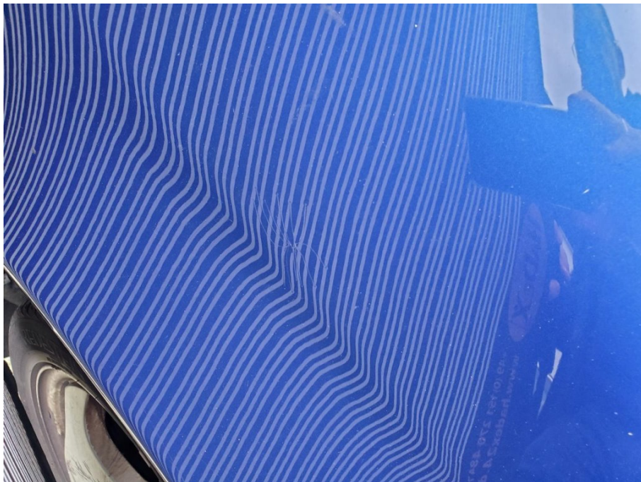
Schadenbereich : Lackrisse Kotflügel rechts
