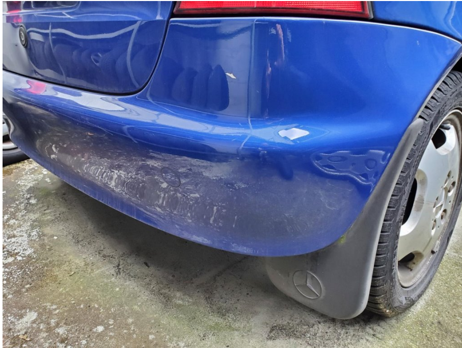
Schadenbereich: Stoßfängerverkleidung hinten verformt/ Lackbeschädigungen
