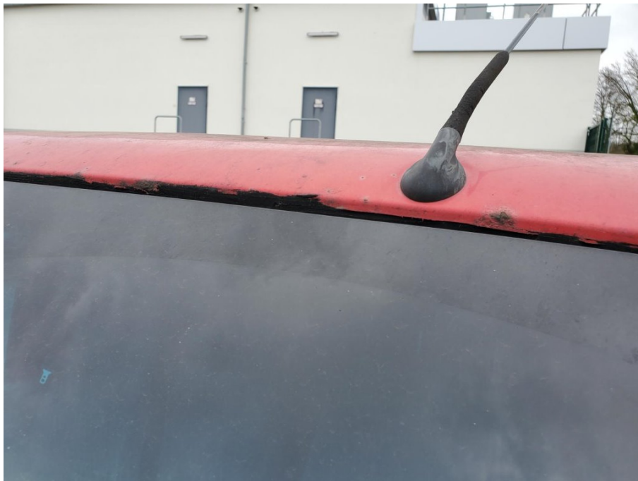
Schadenbereich : Dachkante vorne Lackabplatzungen mit Rostansatz
