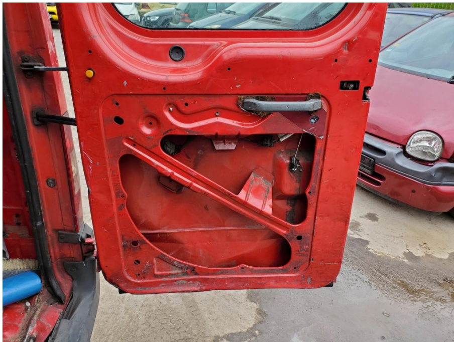
Schadenbereich: Die Heckflügeltür rechts ist deformiert
