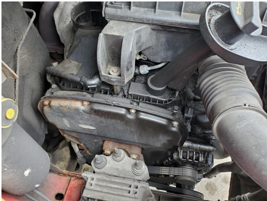
Ansicht : Ölverlust Motor
