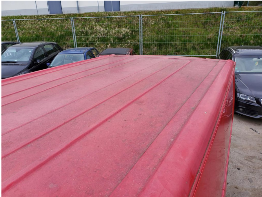
Ansicht Dachbereich-leichte Eindellungen
