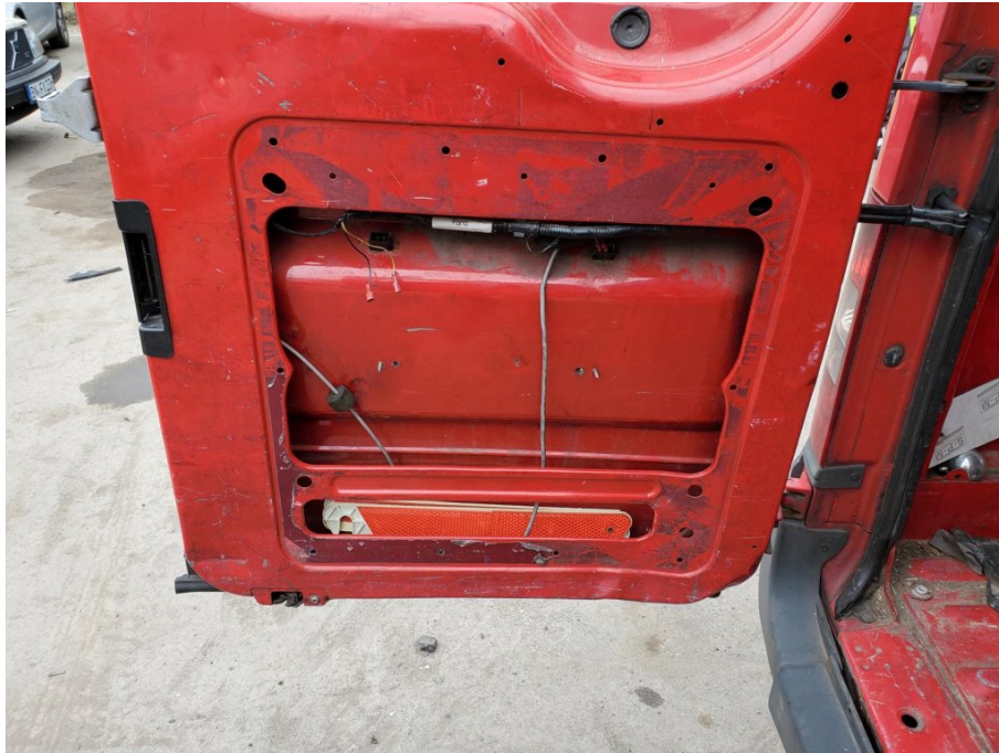
Schadenbereich : Die Heckflügeltür links ist deformiert
