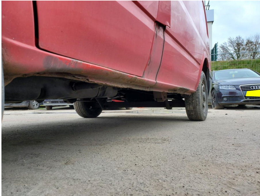
Schadenbereich: Der Schweller links ist deformiert und zeigt Durchrostungen
