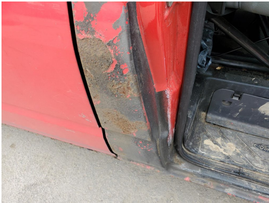
Schadenbereich: Die Bäule rechts ist notdürftig ausgebessert worden/Rostanatz
