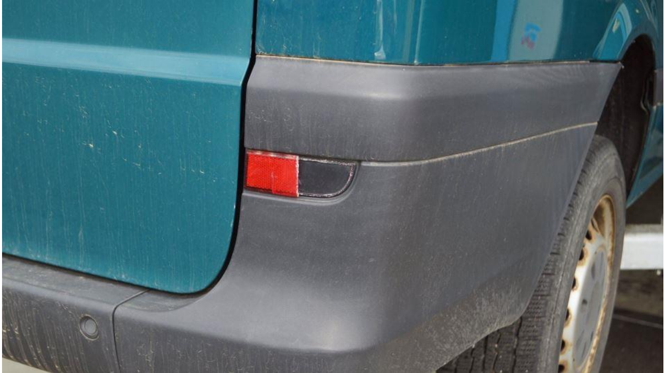
Foto 15: Reflektor HR gebrochen
