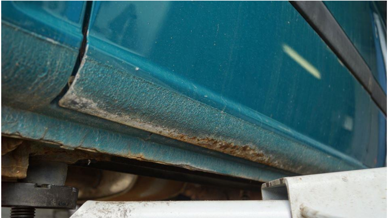
Foto 13: Schiebetür rechts unterhalb Rostansatz
