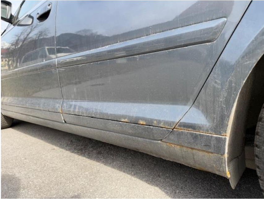
Roststellen linke Fahrzeugseite
