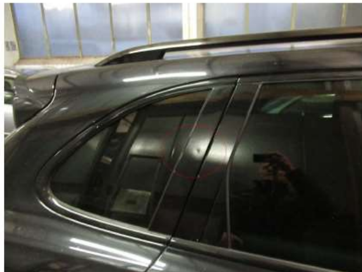
Bild 18 : Blende C-Säule außen rechts eingedellt
