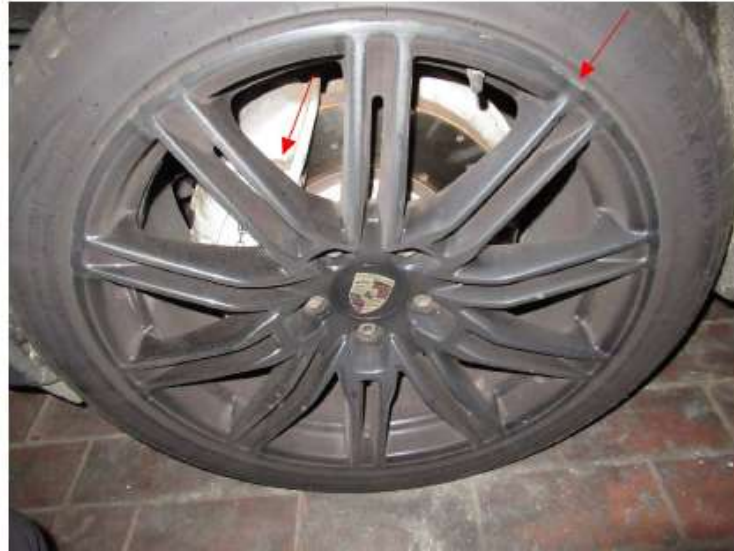
Bild 25 : Leichtmetallrad vorne links verkratzt Entlüfterschraube / Ventil am Bremssattel vorne links abgerissen
