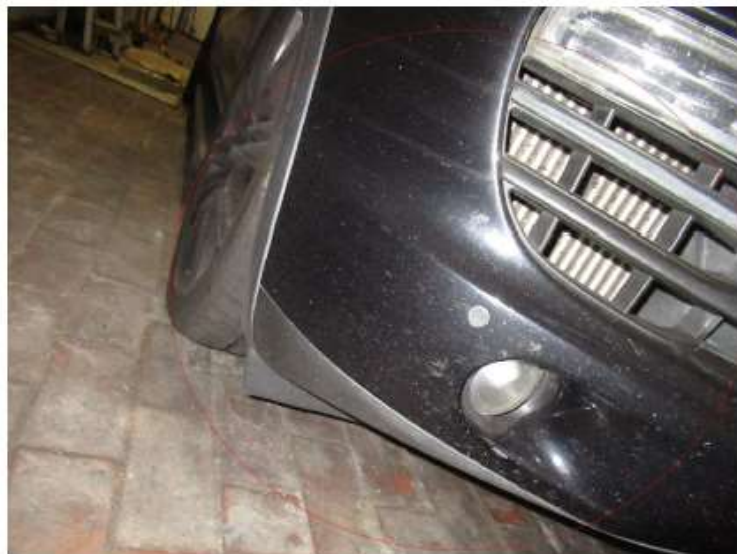
Bild 16 : Steinschlagschäden Stoßfänger vorne
