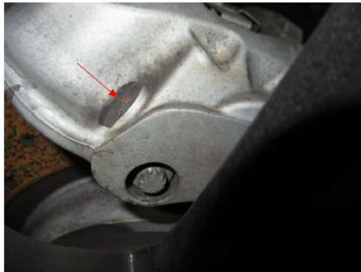
Bild 24 : Entlüfterschraube / Ventil am Bremssattel vorne rechts abgerissen
