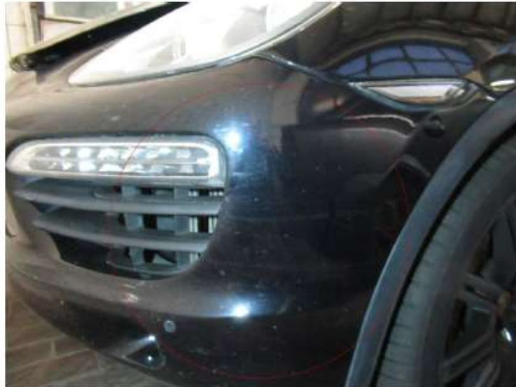
Bild 15 : Steinschlagschäden Stoßfänger vorne
