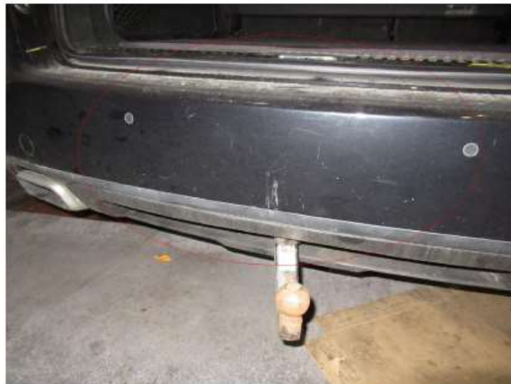
Bild 20 : Stoßfänger hinten lackbeschädigt
