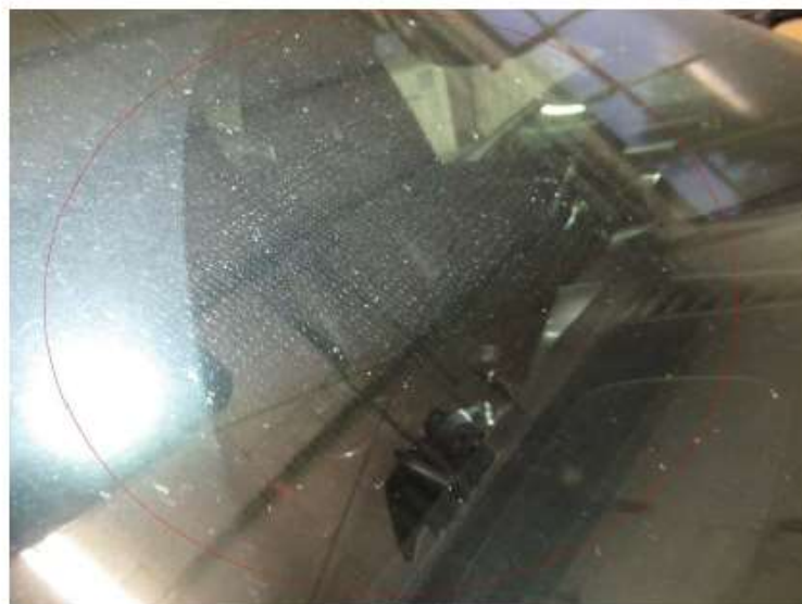
Bild 14 : Oberflächliche Steinschlagschäden Frontscheibe
