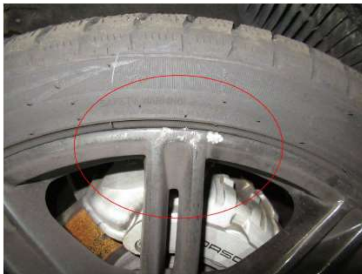
Bild 22 : Leichtmetallrad vorne rechts verkratzt
