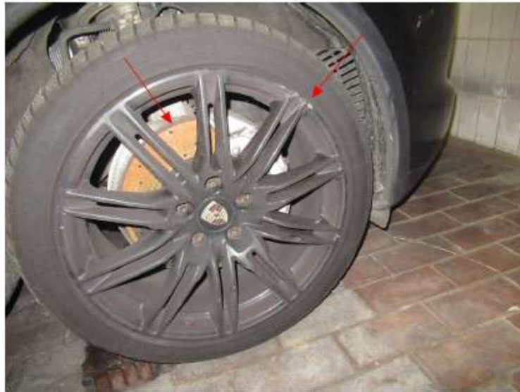
Bild 21 : Leichtmetallrad vorne rechts verkratzt Standschäden, Bremsscheibe korrodiert
