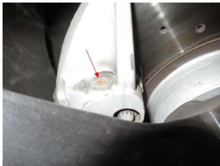
Bild 26 : Entlüfterschraube / Ventil am Bremssattel vorne links abgerissen
