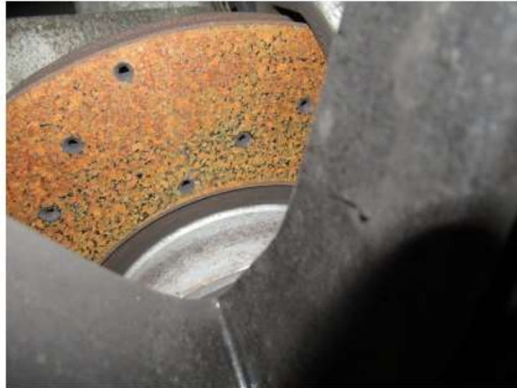
Bild 23 : Vorne rechts, Standschäden, Bremsscheibe korrodiert
