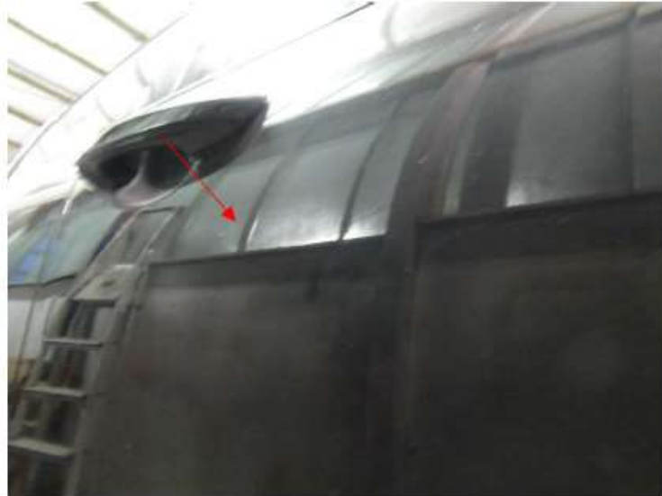
Bild 17 : Leichte Eindellung Tür vorne rechts
