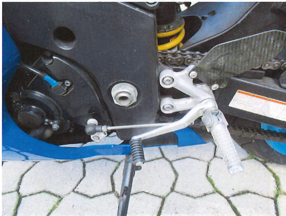
Bild 13 : Kupplungshebel wurde erneuert
