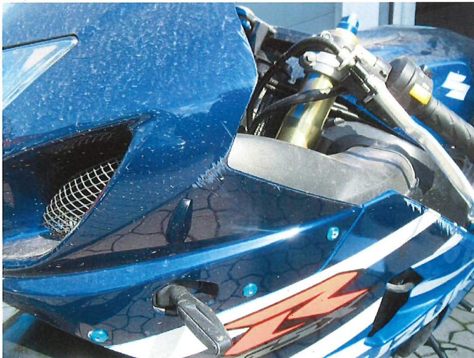
Bild 16 : Seitenverkleidung/ Frontverkleidung links verkratzt
