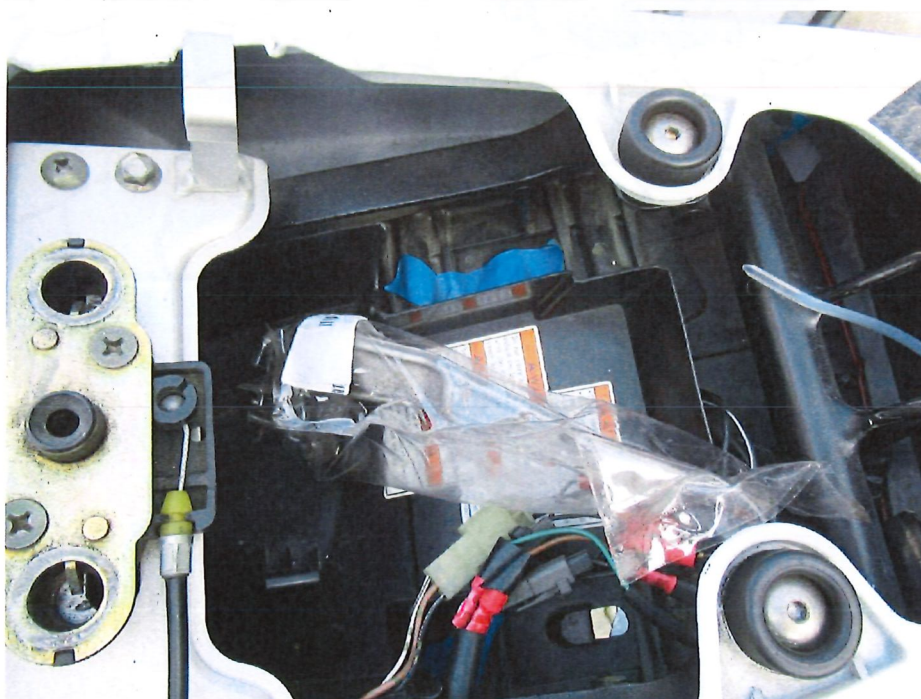
Bild 10 : Batterie entladen / defekt
