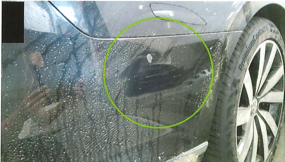
Bild 13 : Stoßfänger hinten, deformiert, instandsetzen und lackieren mit Lackaufbau
