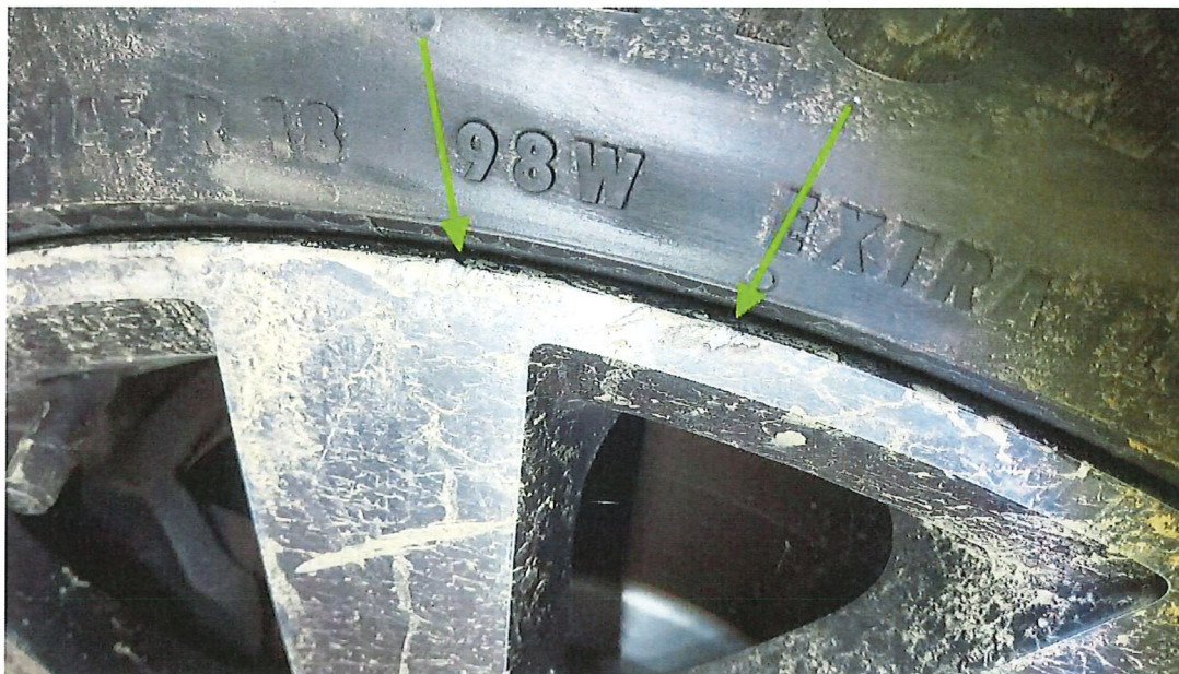
Bild 9 : Felge vorne links, Lackierung, verschrammt
