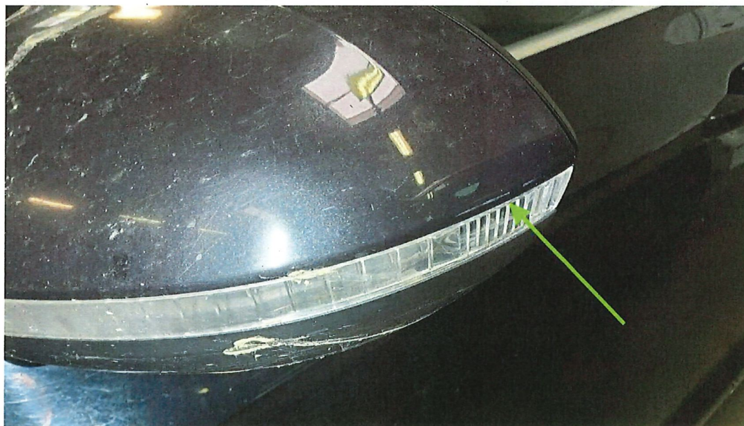
Bild 10 : Außenspiegel links Lackierung, zerkratzt, lackieren mit Lackaufbau
