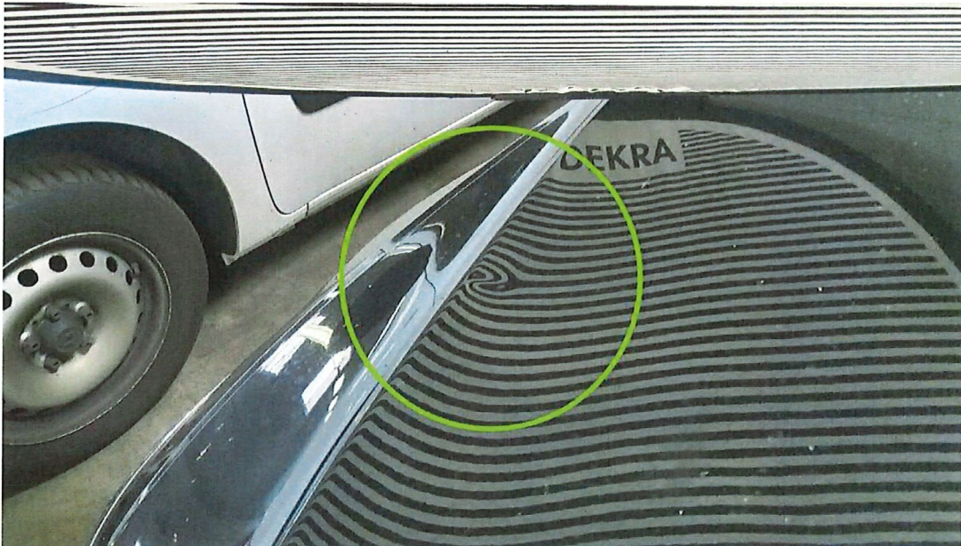
Bild 11 : Motorhaube, deformiert, instandsetzen und lackieren mit Lackaufbau
