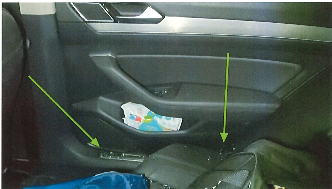
Bild 8 : Tür hinten rechts, Fensterscheibe, zerbrochen
