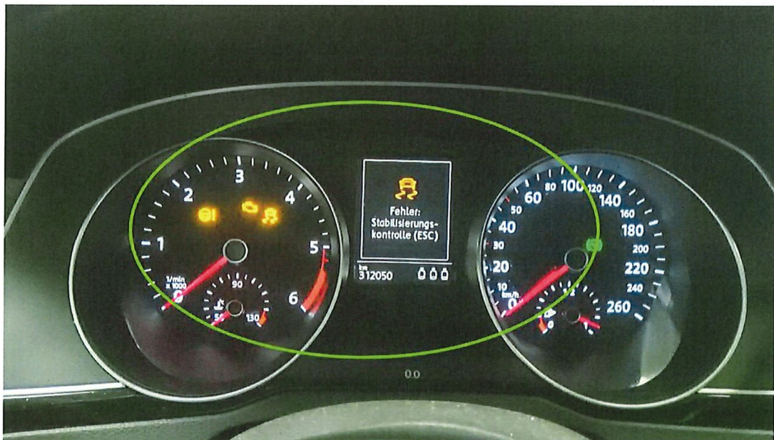
Bild 14 : Motor startet nicht / Fehlermeldungen Kombiinstrument
