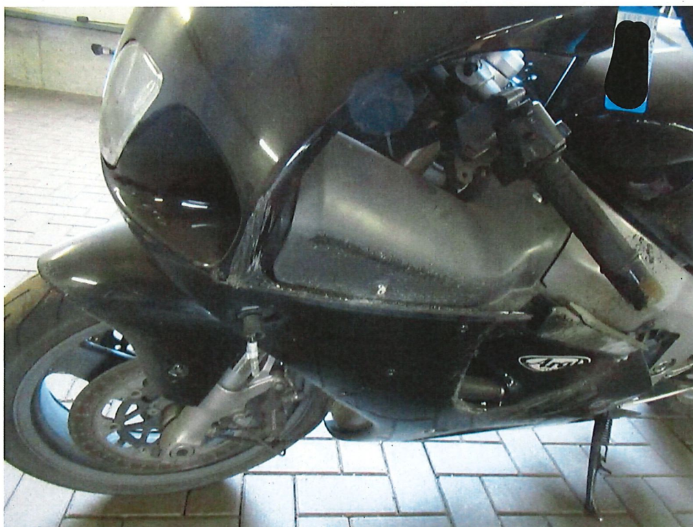
Bild 10: Weitere Schürfspuren im vorderen, linken Bereich
