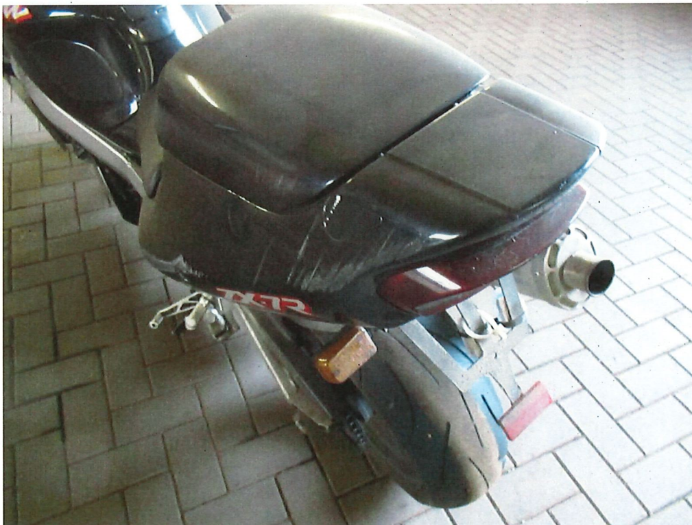
Bild 4: Schürfspuren an der seitlichen Verkleidung hinten links
