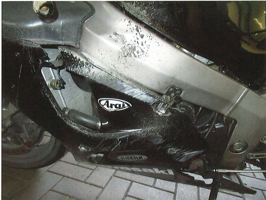
Bild 7: Schürfspuren an der linken Fahrzeugseite unterhalb des Rahmens
