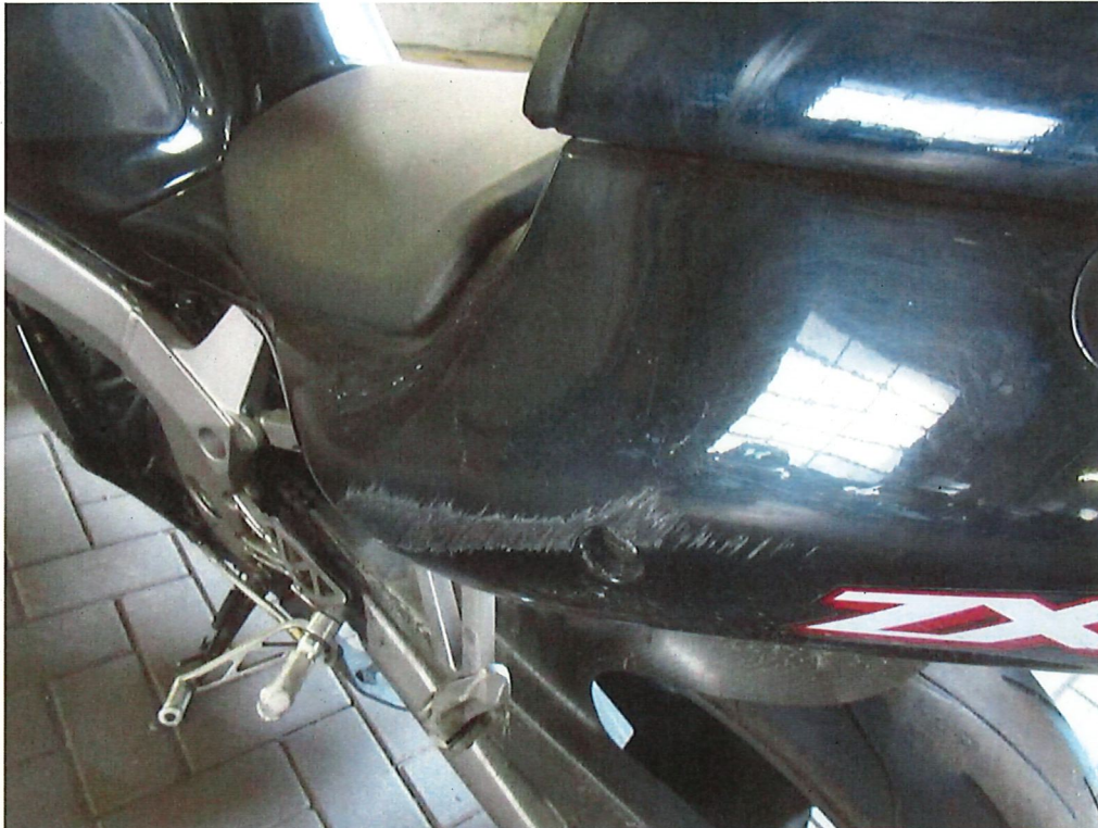
Bild 5: Weitere Schürfspuren an der linken Verkleidung im Bereich des Sitzes
