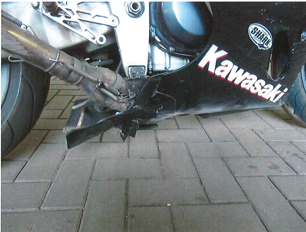
Bild 12: Verkleidung rechts unterhalb gebrochen
