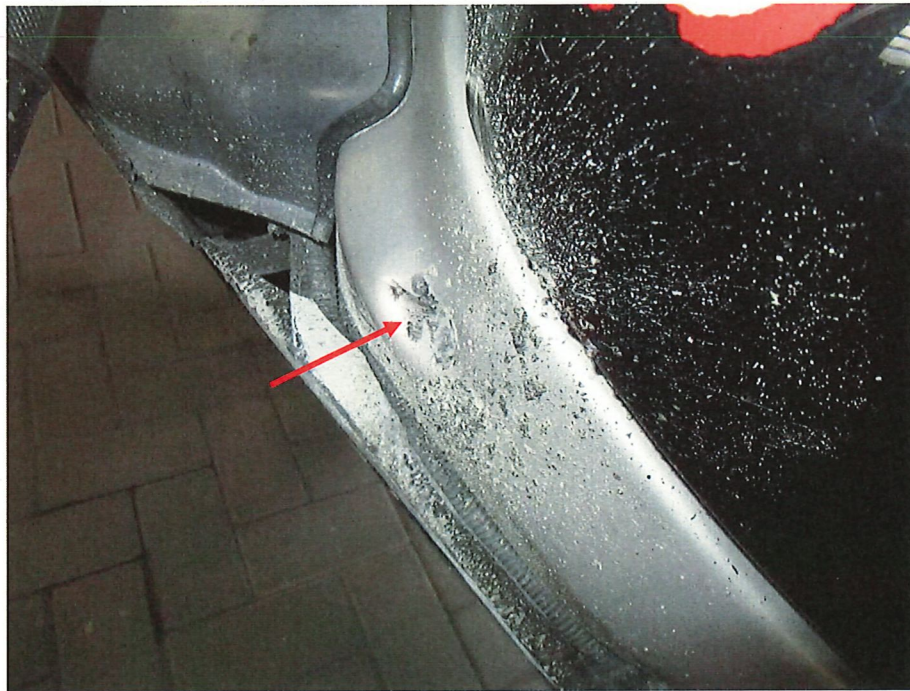
Abbildung 2: Rahmen links eingedrückt
