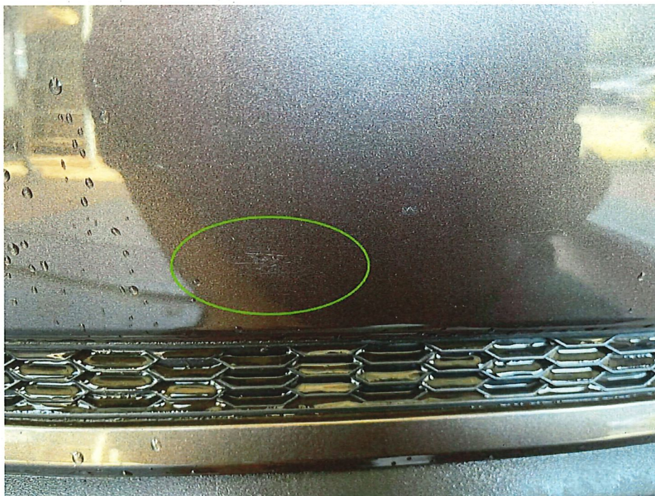
Bild 8 : Stoßfänger hinten Lackierung, verschrammt, lackieren mit Lackaufbau
