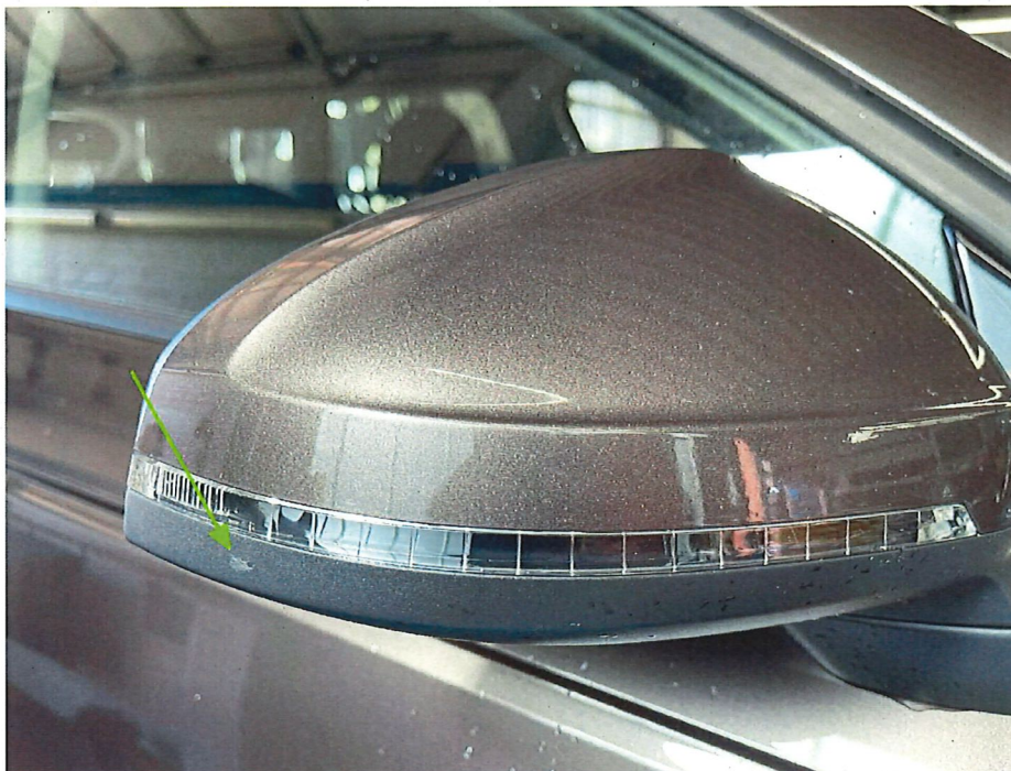
Bild 11 : Außenspiegel rechts Gehäuse, deformiert, erneuern
