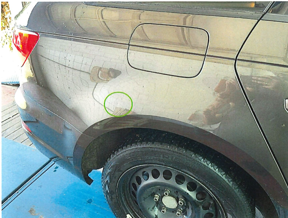
Bild 16 : Seitenteil hinten rechts, eingedellt, drücken
