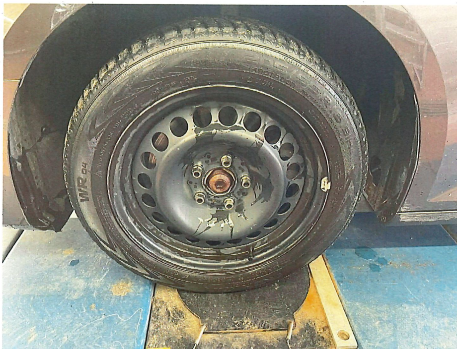
Bild 21 : Winterräder unterhalb der Verschleißgrenze
