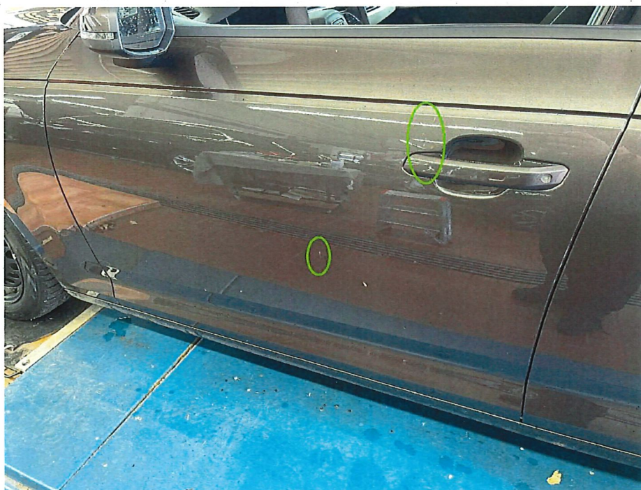
Bild 12 : Tür vorne links Lackierung, zerkratzt, lackieren mit Lackaufbau
