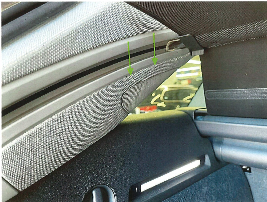
Bild 18 : Verkleidung D-Säule links, zerkratzt, erneuern
