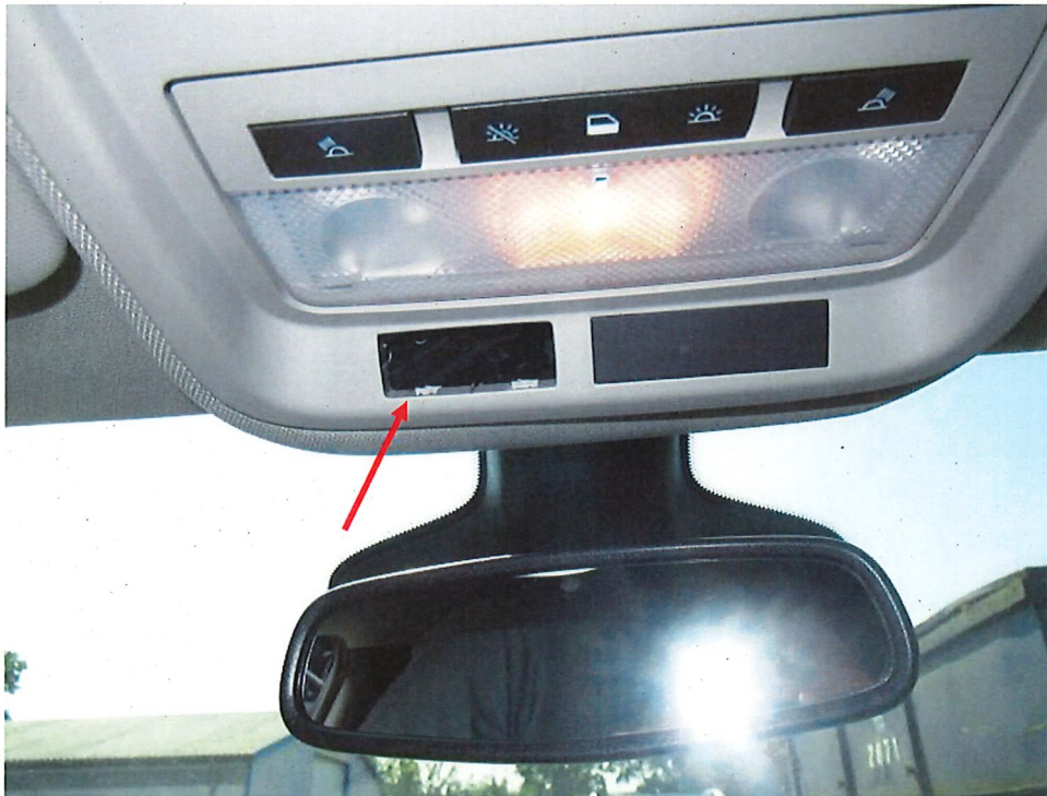
Bild 8: Konsole im Himmel beschädigt
