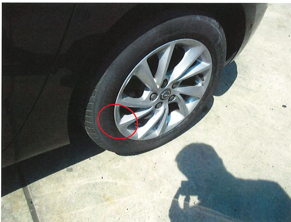
Bild 19: Felge hinten links verschrammt
