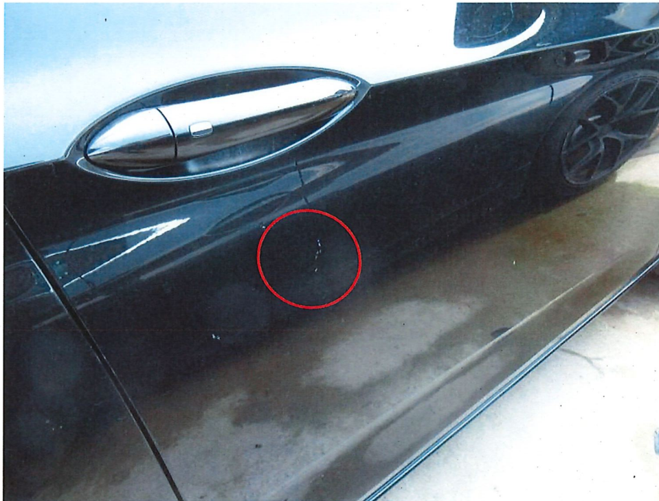
Bild 14: Beschädigung der Lackierung - Tür vorne rechts
