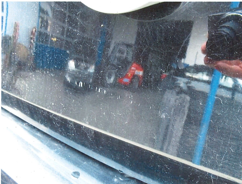
Bild 12: Detailansicht Kratzspuren Heckklappe
