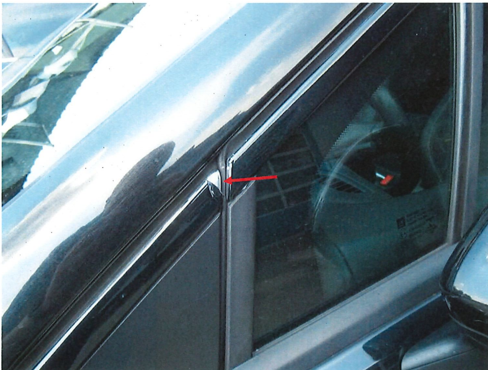
Bild 9: Folierung der Chromleisten
