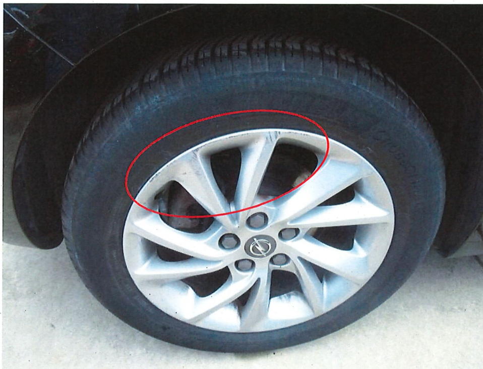
Bild 18: Felge hinten rechts verschrammt
