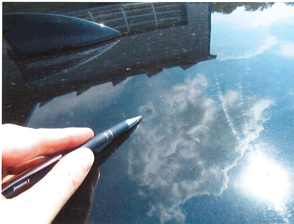
Bild 16: Punktuelle Eindellung des Daches
