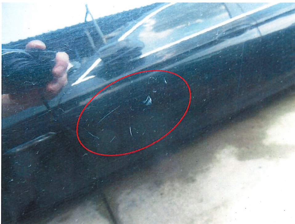
Bild 13: Beschädigung der Lackierung - Tür hinten rechts
