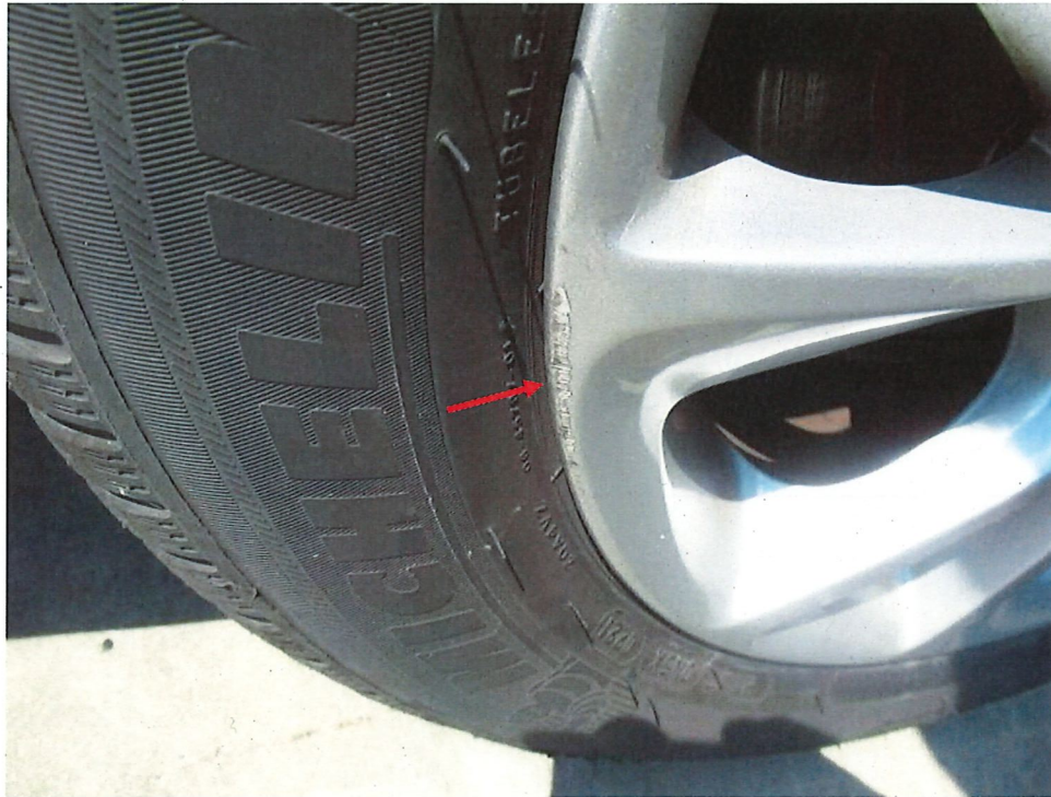
Bild 20: Detailansicht Schäden Felge hinten links
