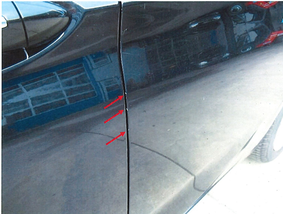
Bild 10: Beschädigung der Lackierung - Tür hinten links
