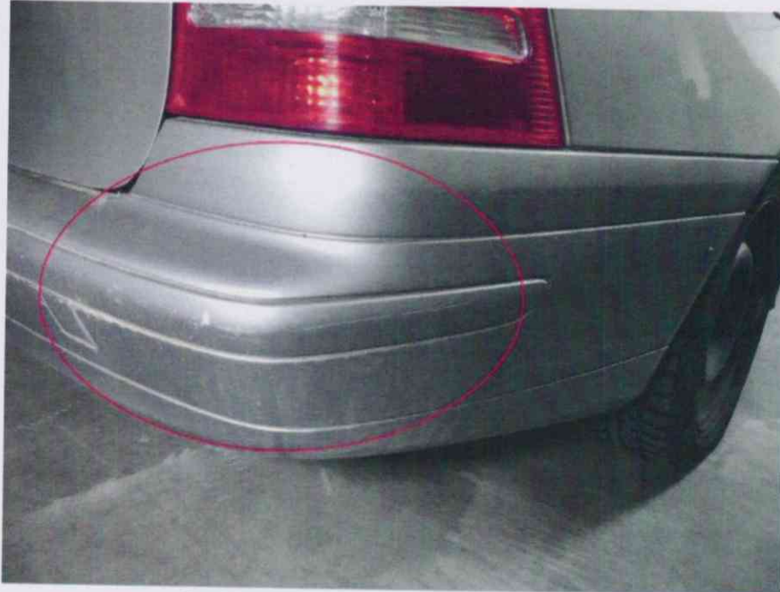
Stoßfänger hinten rechts angeschrammt
