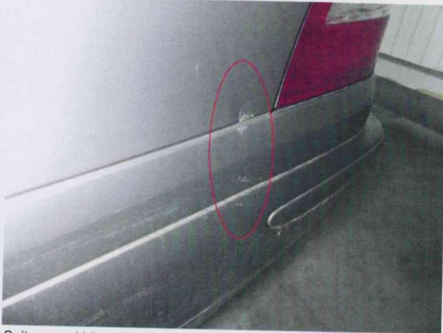
Seitenwand hinten links/ Stoßfängerverkleidung hinten links beschädigt
